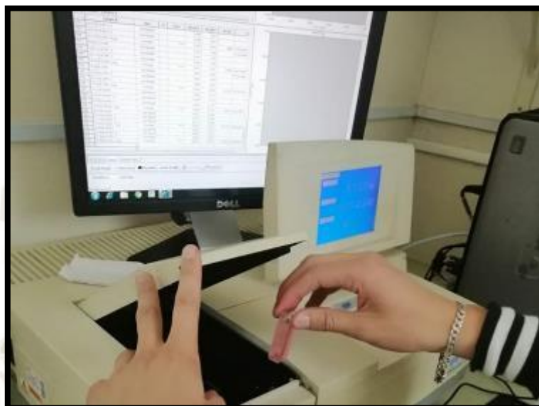
Fotografía 20. Cubetas de cuarzo introducidas en el espectrofotómetro para su lectura
