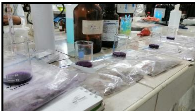
Fotografía 29. Muestras listas para lectura en el espectrofotómetro
