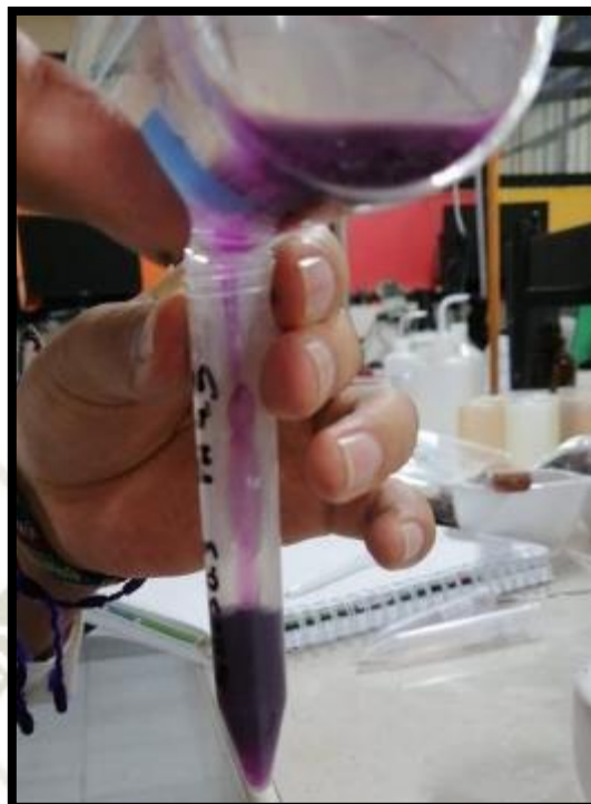
Fotografía 15. Muestra con buffer pH 4.5 puesta en tubo falco rotulado
