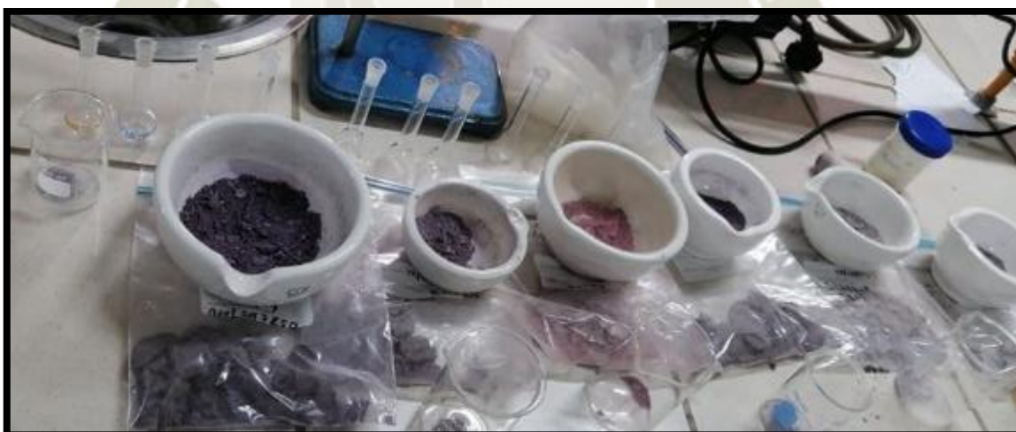
Fotografía 25. Muestras de papas ya liofilizadas y molidas
