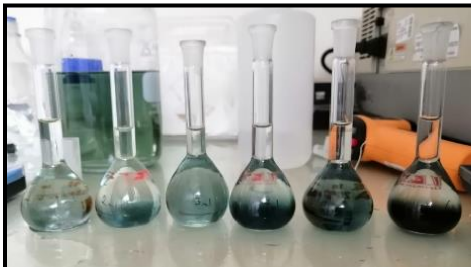
Fotografía 23. Fiolas después de 2 horas con la concentración de 1 a 6 ml para la curva de poli fenoles
