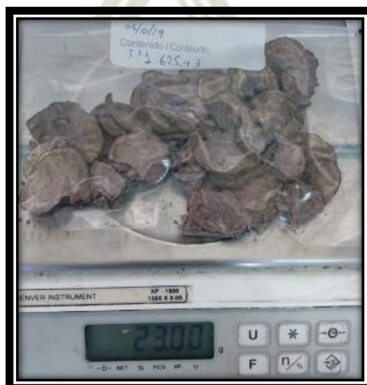
Fotografía 9. Muestras ya secas y embolsadas al vacío, luego pesadas
