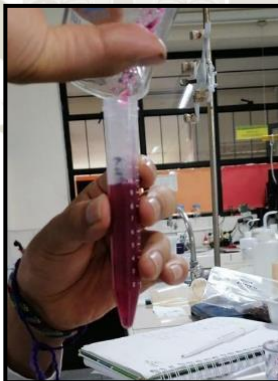
Fotografía 15. Muestra con buffer pH 4.5 puesta en tubo falco rotulado
