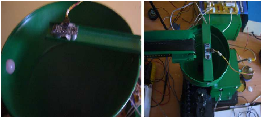
FIGURA 6.40. Sensores ultrasónicos en Tolvas principal y secundaria respectivamente
