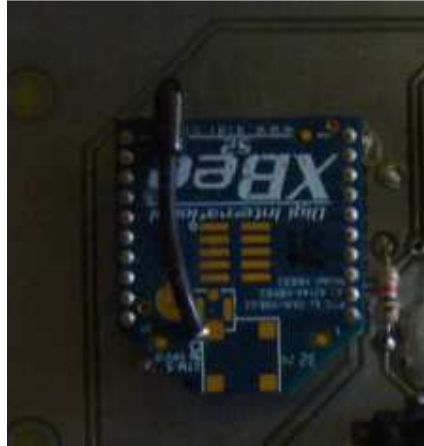
FIGURA 6.22. Módulo XBEE en el receptor
