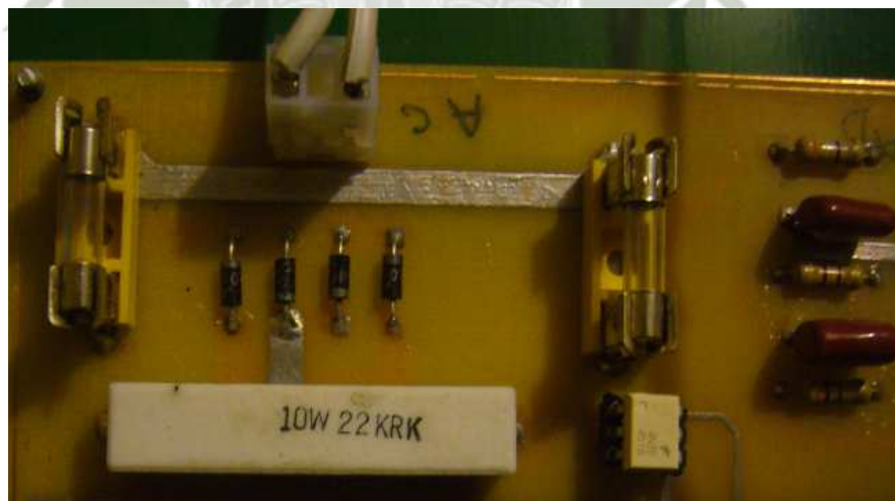
FIGURA 7.11. Circuito en placa del control de cruce por cero
