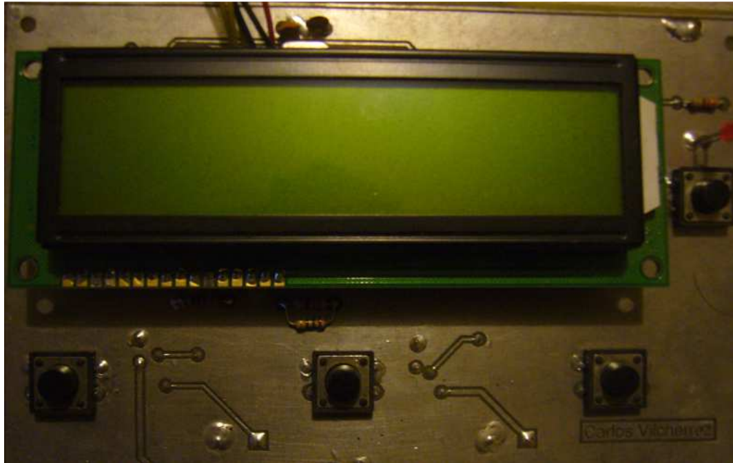
FIGURA 6.31. Pantalla LCD en el control de mando para visualización de parámetros
