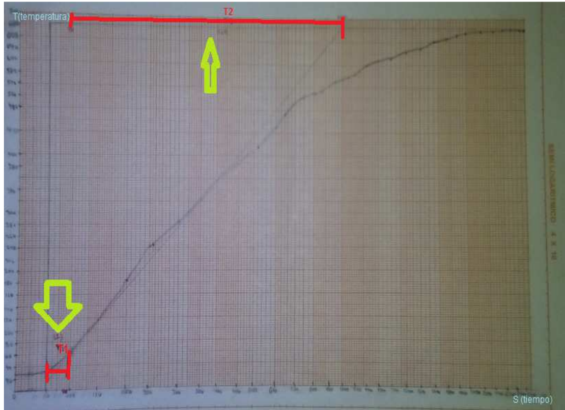
GRÁFICA 6.2. Modelo para hallar las constantes del PID
