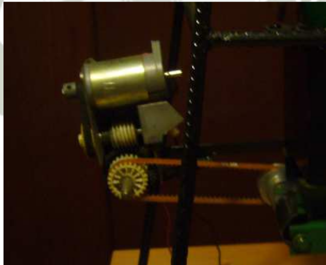
FIGURA 6.17. Motor para el control de faja transportadora
