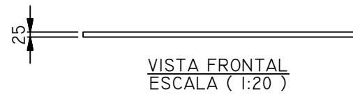
PIEZA 5: AISLAMIENTO TÉRMICO
