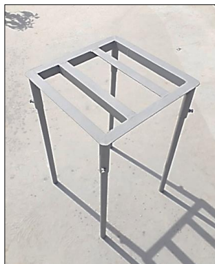
Estructura de Soporte del Tanque de Control de Nivel de Agua
