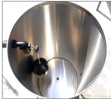
Tanque de Control de Nivel de Agua Contaminada
