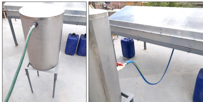
Ingreso del Agua Contaminada al Alambique Solar
