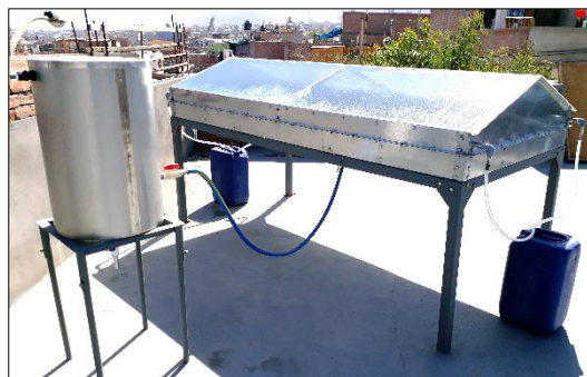
Destilador Solar de Doble Vertiente terminado
