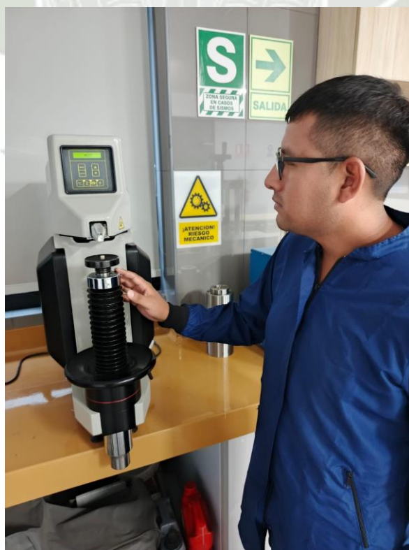
FIGURA 21: Medición de dureza
