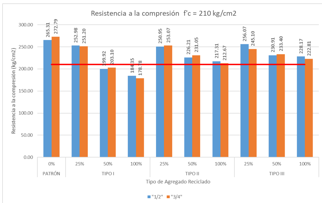
Gráfica 49: Resistencia a la Compresión para diseño de mezclas de f'c=210 \text{ kg/cm}^2 (Fuente propia)
