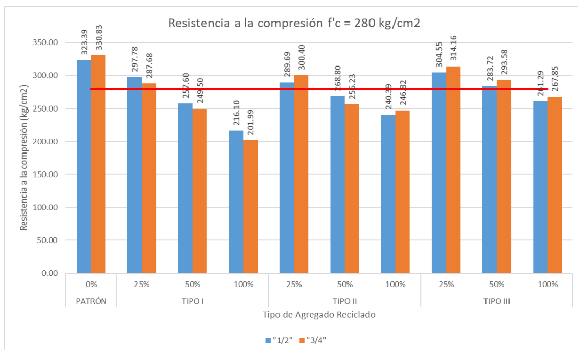
Gráfica 53: Resistencia a la Compresión para diseño de mezclas de f'c=280 \text{ kg/cm}^2 (Fuente propia)
