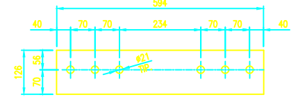
ELEMENTO PL-17 ESC. 1/5 MATERIAL: PL 8mm ASTM A36 CANTIDAD: 09 UNDS.
