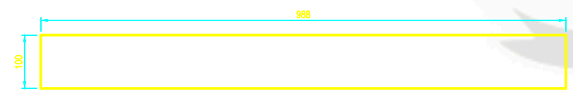
ELEMENTO PL-03 ESC. 1/5 MATERIAL: PL. 9mm ASTM A36 CANTIDAD: 02 UNDS.
