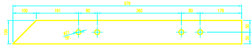
ELEMENTO PL-05 ESC. 1/5 MATERIAL: PL. 9mm ASTM A36 CANTIDAD: 02 UNDS.
