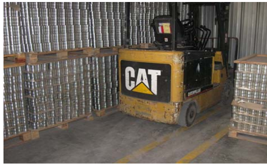
Imagen 5.- Deficiente señalización de pasillos
