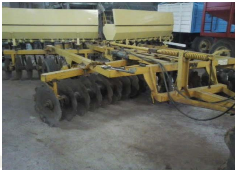
Fotografía N° 7. Arado de polidisco, foto referencial de polidisco pesado
