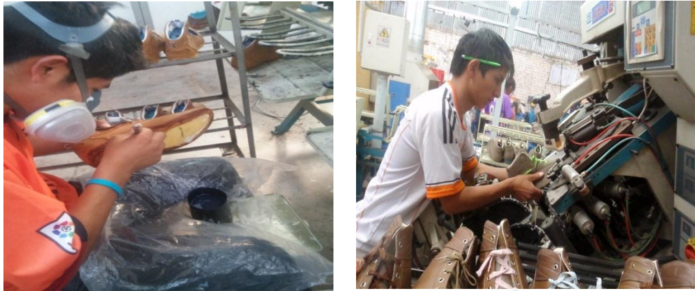
FIGURA 3:10: Proceso de Conformado de Punta
