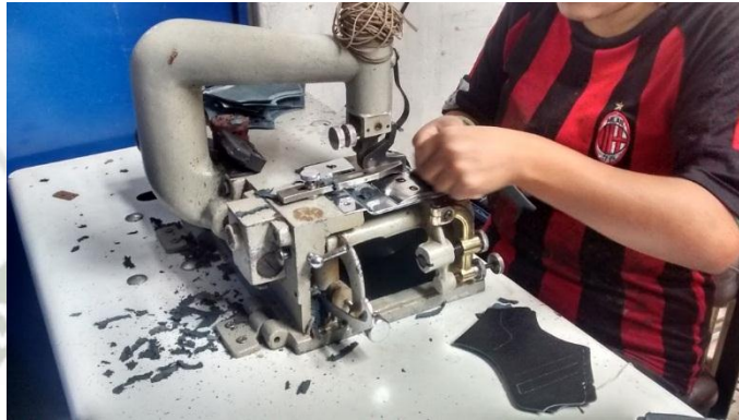
FIGURA 3:7: Proceso de Desbastado
