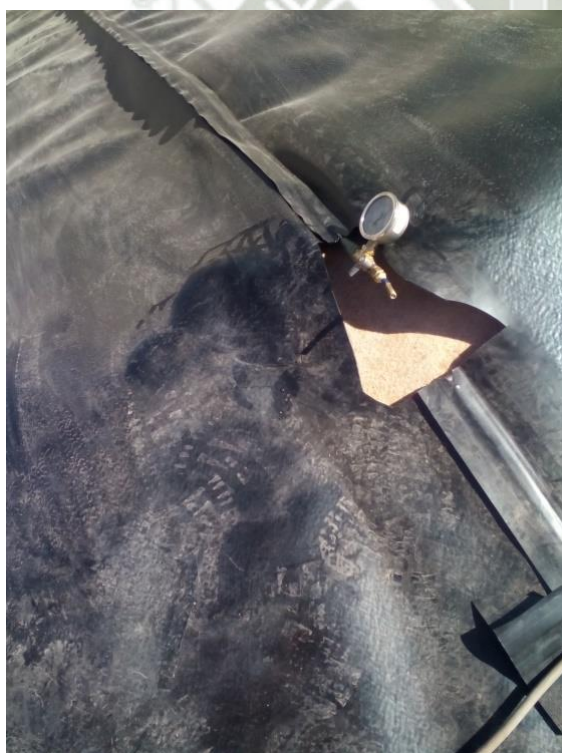
Foto 56: Pruebas de Calidad en Uniones - Cuajone
