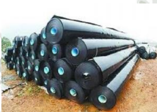
Foto 6: Rollos de Geomembrana
