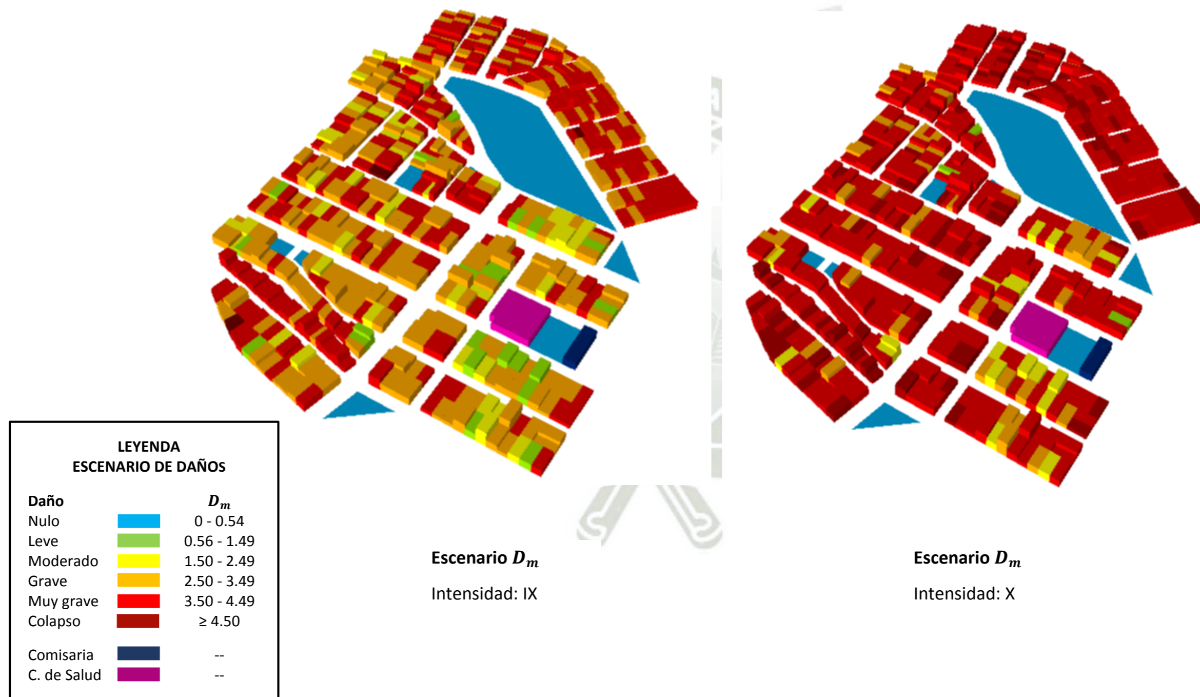
Figura 71: Distribución de daños sísmicos para los escenarios de I=VIII y I=IX, para el PP. JJ Ciudad Blanca.
