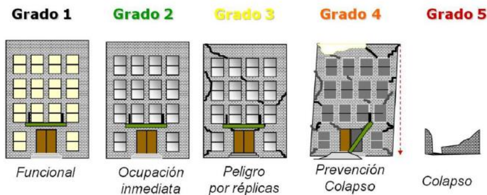
Figura 3: Correlación del grado de daño con la funcionalidad de la edificación después de un terremoto.
