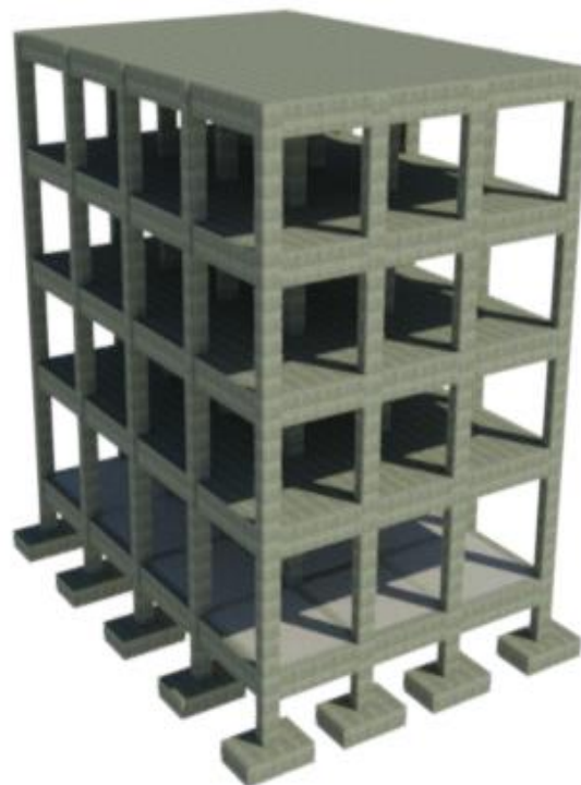
Figura 4: Sistema de un edificio conformado por pórticos.
