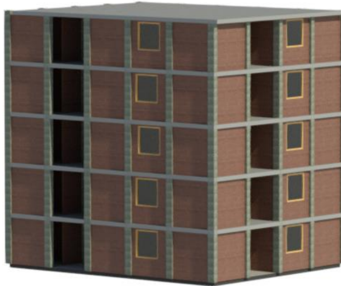
Figura 7: sistema estructural de albañilería.
