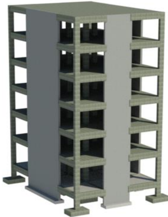
Figura 6: Sistema dual de un edificio.
