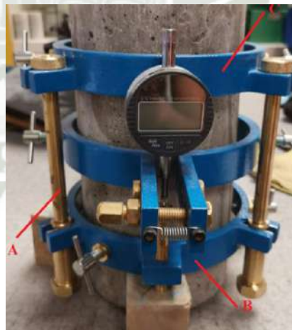
Ilustración 118: Compresometro – Expansometro Digital.
