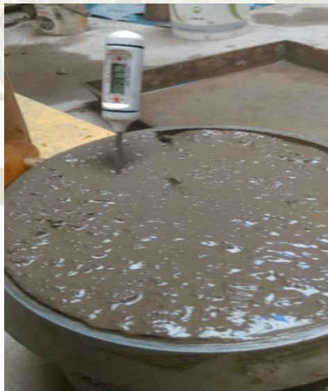
Figura 22 Medición de la temperatura del concreto fresco
