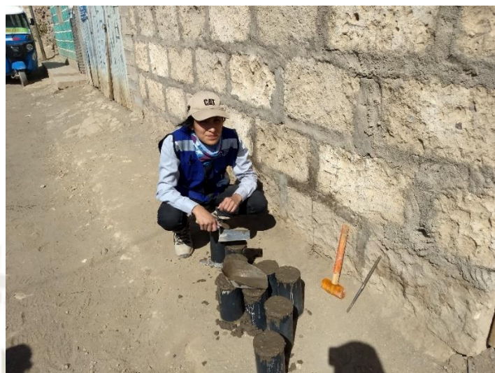
Figura 30 Elaboración de los especímenes de concreto de la zona de aplicación
