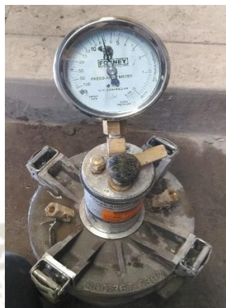
Figura 21 Medición del contenido de aire por olla Washington
