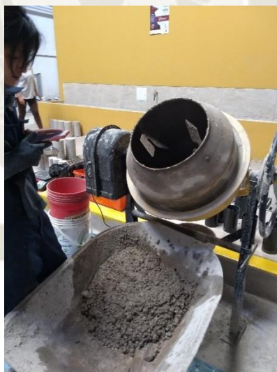
Figura 19 Mezcla homogénea con una consistencia plástica
