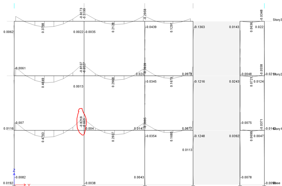
Figura 51 Momentos en el Eje más Cargada (Eje 3). Mom Max=0.83 Ton-m
