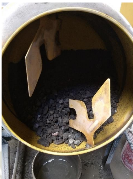
Figura 16 Combinación de agregado fino y grueso en la mezcladora
