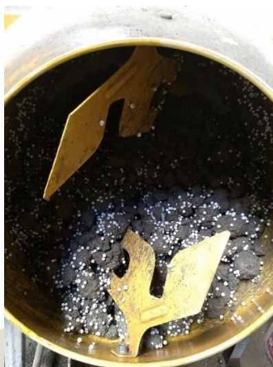
Figura 18 Combinación de los agregados, cemento y las perlitas de perlitas de poliestireno
