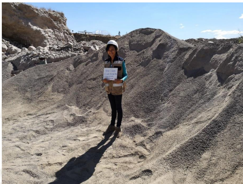
Figura 13. Arena gruesa de la cantera de Machahuaya
