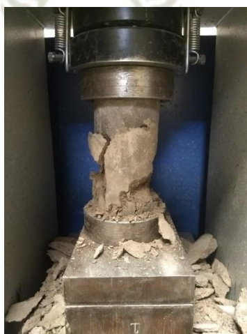
Figura 31 Rotura de la probeta extraída de la zona de aplicación PROFAM
