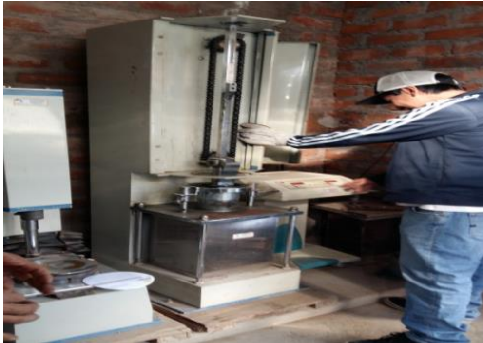
Figura 24: Chancado de probeta Asfalto en caliente, obtenido en laboratorio FUENTE: Elaboración propia, laboratorio RCF
