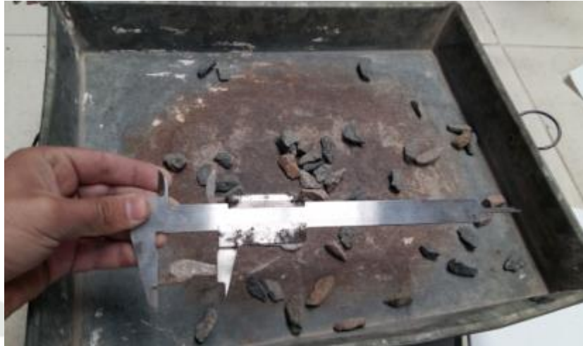
Figura 12: partícula alargada, ensayo de partículas chatas y alargadas FUENTE: Elaboración propia, laboratorio de suelos y concreto UCSM
