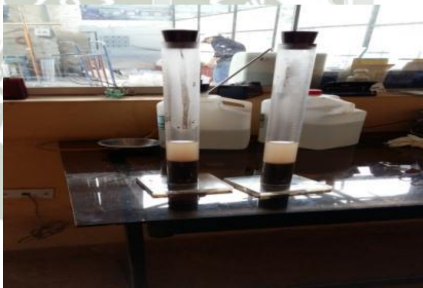
Figura 17: muestra en reposo, ensayo índice de durabilidad.
