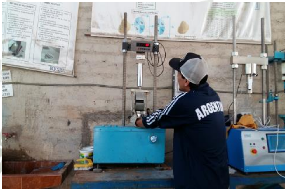
Figura 41: Toma de datos de estabilidad y flujo FUENTE: Elaboración propia, laboratorio RCF
