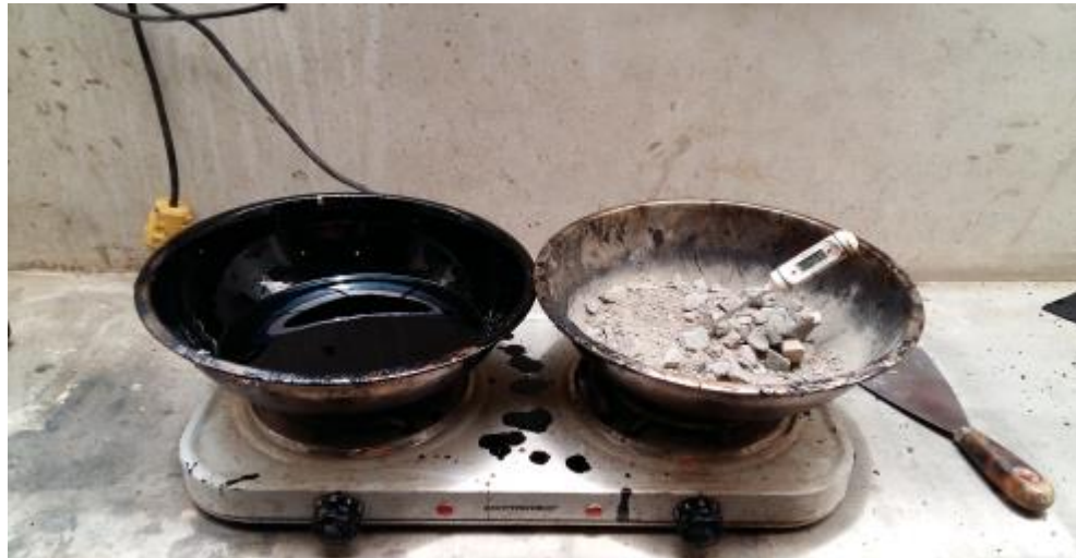
Figura 22: Calentando Pen y los agregados FUENTE: Elaboración propia, laboratorio RCF
