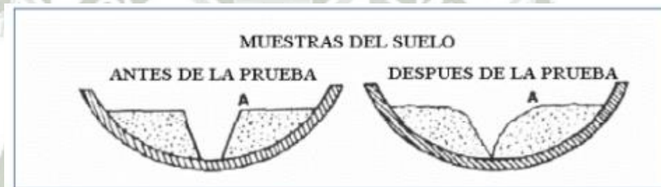
Figura 20: Representación del cierre de la ranura que forma la muestra. FUENTE: EG – 2013
