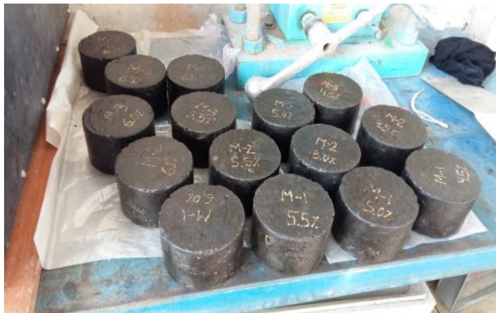
Figura 26: Probetas Asfalto en caliente parafinadas FUENTE: Elaboración propia, laboratorio RCF
