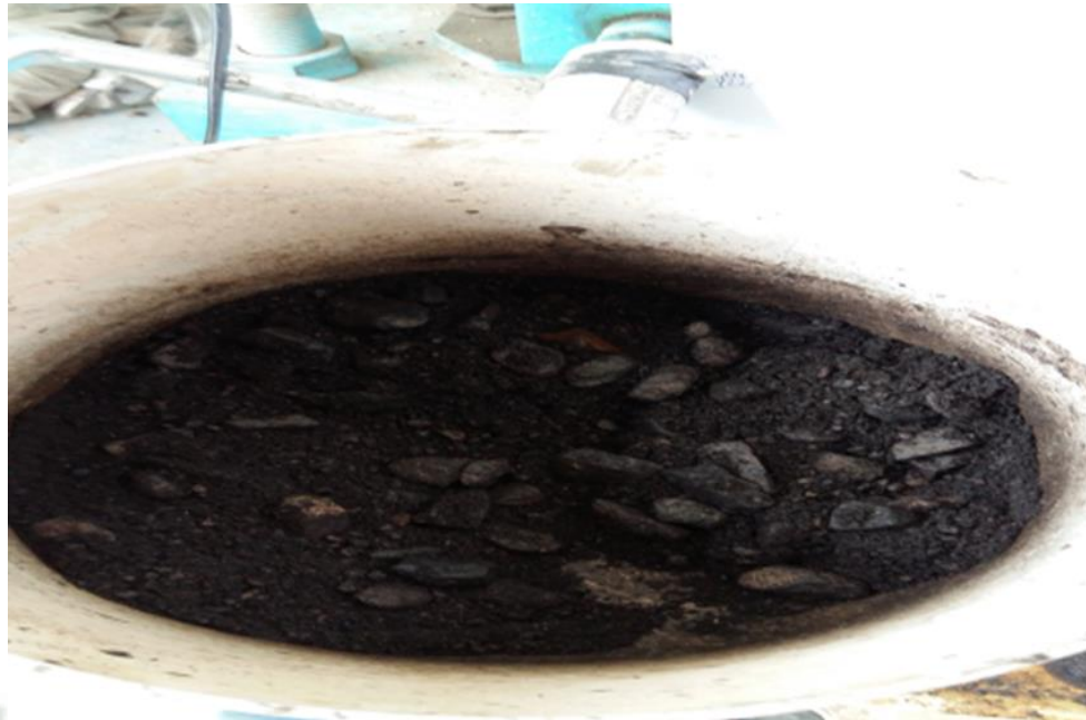
Figura 52: Mezcla de asfalto espumado FUENTE: Elaboración propia, laboratorio RCF
