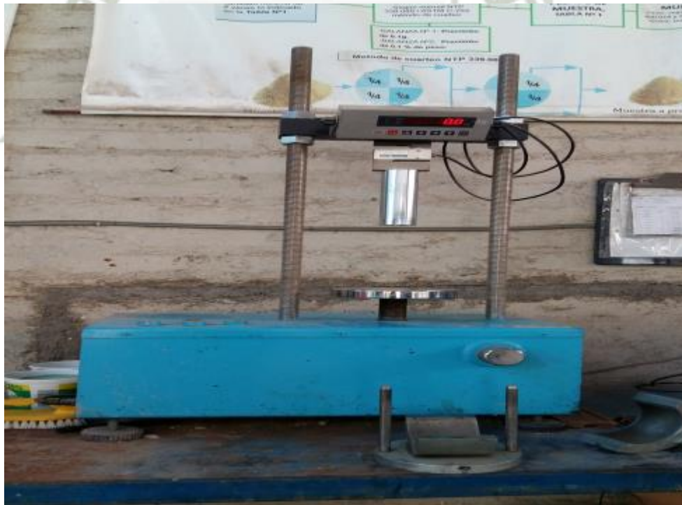
Figura 21: Máquina para ensayo Marshall y molde para probetas FUENTE: Elaboración propia, laboratorio RCF
