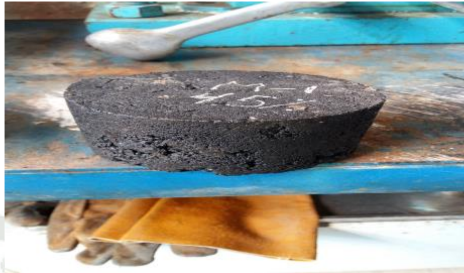
Figura 25: Probeta Asfalto en caliente, obtenido en laboratorio FUENTE: Elaboración propia, laboratorio RCF
