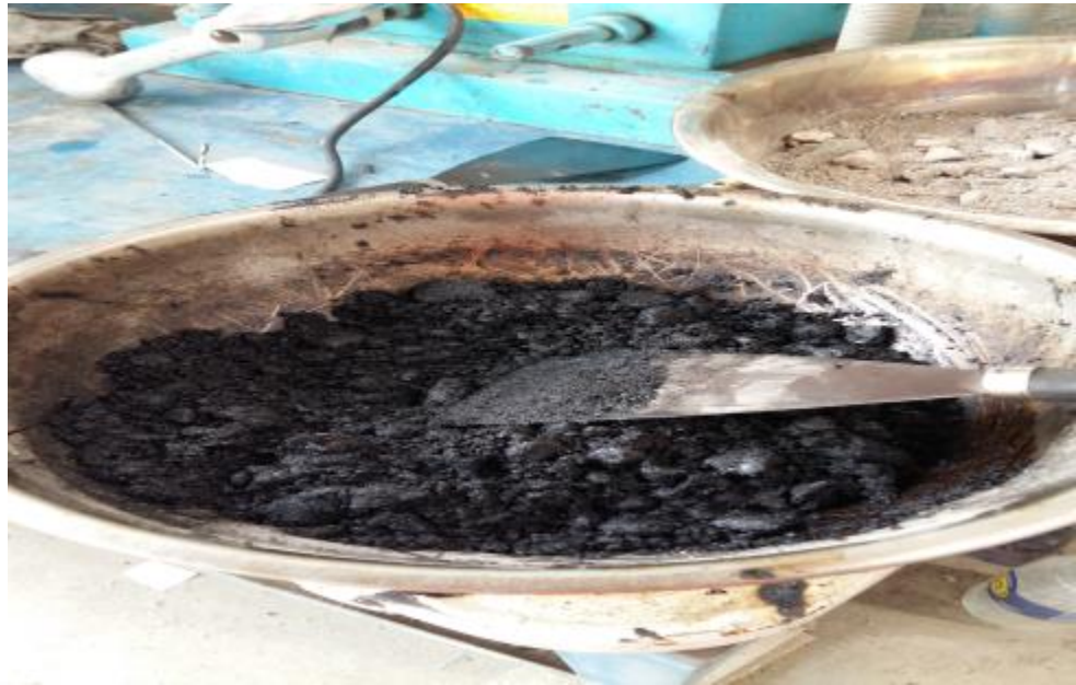
Figura 23: Asfalto en caliente convencional, obtenido en laboratorio FUENTE: Elaboración propia, laboratorio RCF
