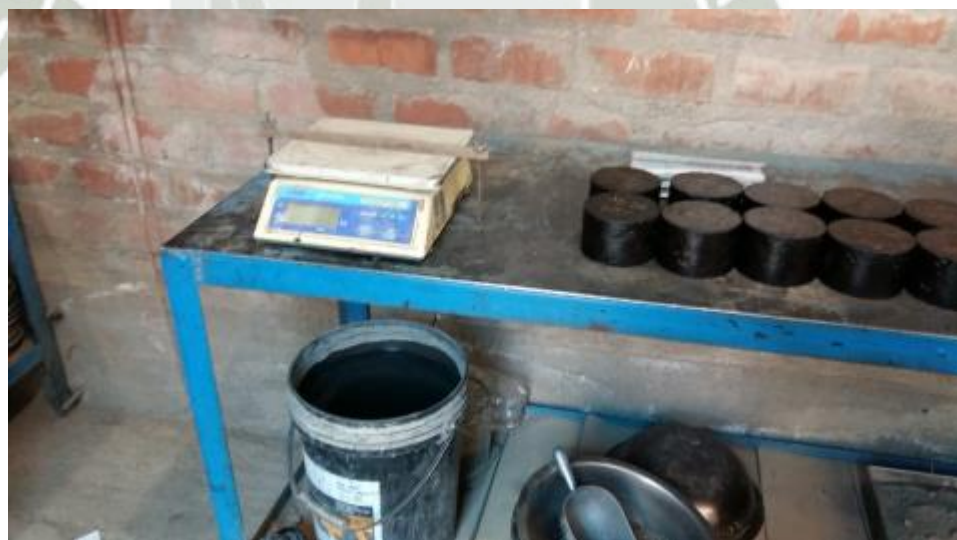
Figura 27: Probetas listas para obtener el peso sumergido FUENTE: Elaboración propia, laboratorio RCF
