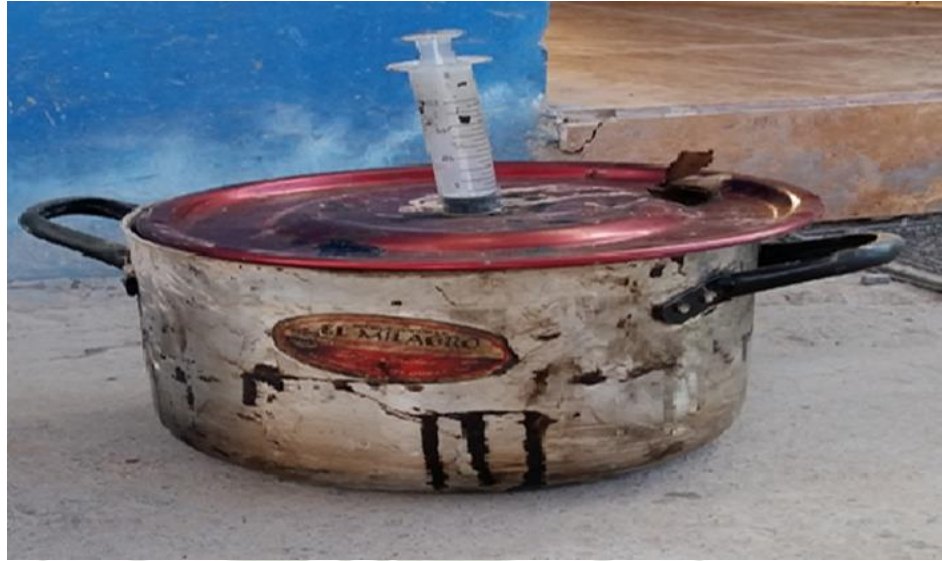
Figura 34: Proceso de inyección de agua en el recipiente
