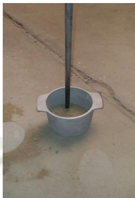
Figura 8. Ensayo para la obtención del peso unitario suelto. Material relave y volado socavón mina
