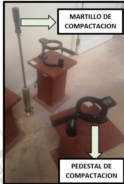
Figura 13: Equipos empleados para la compactación de muestras Fuente: Elaboración propia
