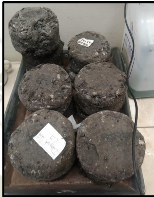
Figura 51: Desgaste en especímenes de mezcla modificada Fuente: Elaboración propia
