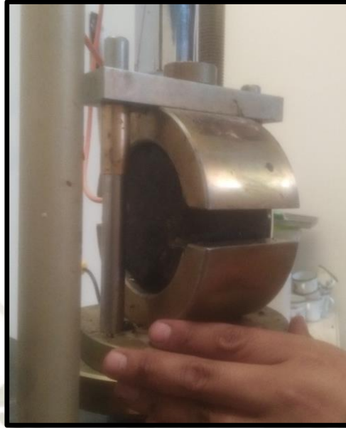
Figura 17: Colocación de espécimen en el molde Marshall Fuente: Elaboración propia
