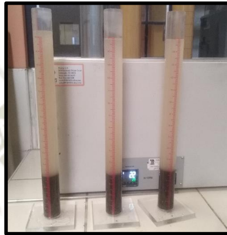
Figura 37: Equivalente de arena del agregado fino Fuente: Elaboración propia
