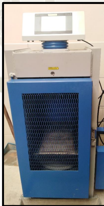
Figura 21: Máquina de compresión empleada para ensayo de I - C Fuente: Elaboración propia
