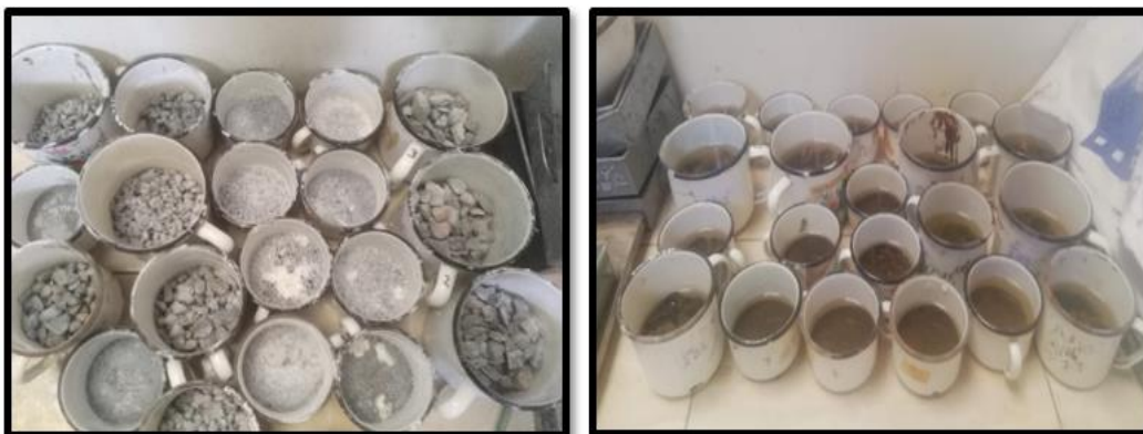
Figura 27: Ensayo de durabilidad - Inmersión de muestra en la solución Fuente: Elaboración propia
