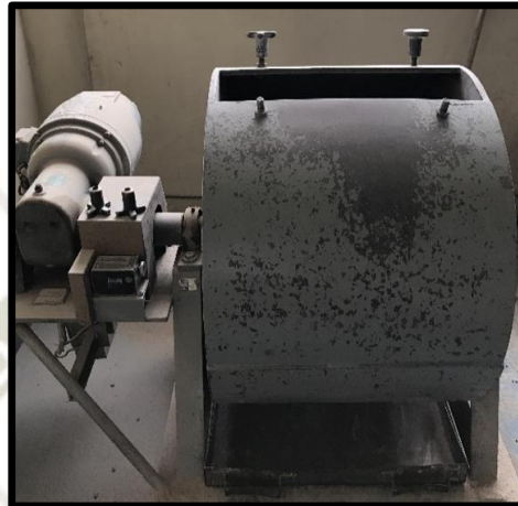
Figura 28: Ensayo de abrasión - Máquina de los Ángeles Fuente: Elaboración propia
