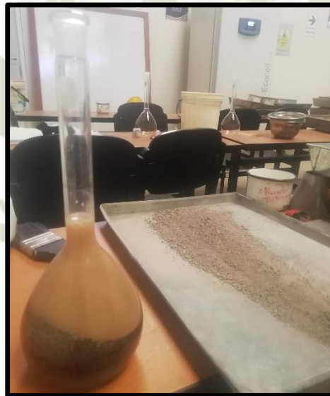
Figura 44: Peso específico del agregado fino Fuente: Elaboración propia
