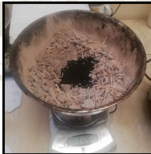
Figura 12: Preparación de Mezcla asfáltica adicionada con fibras de polipropileno Fuente: Elaboración propia
