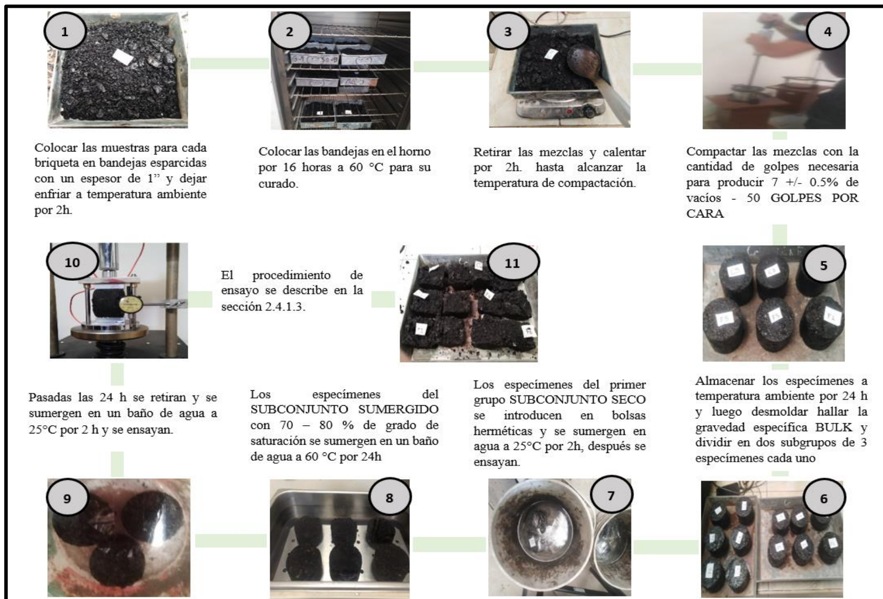
Figura 20: Esquema de elaboración de especímenes para ensayo de TSR Fuente: Elaboración propia
