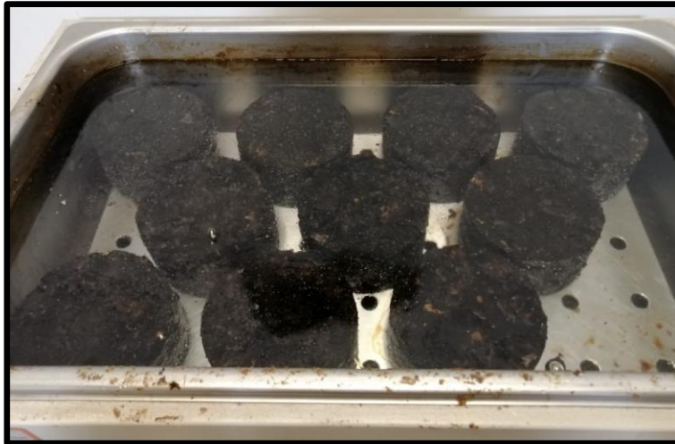
Figura 16: Inmersión de especímenes en baño de agua a 60°C Fuente: Elaboración propia
