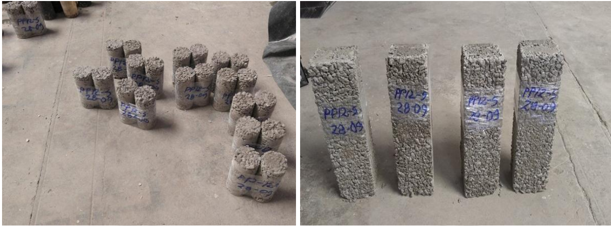
Fig. 4.22: Después de ser desmoldadas, se procederá a identificarlas y marcarlas. Fuente: Propia.
