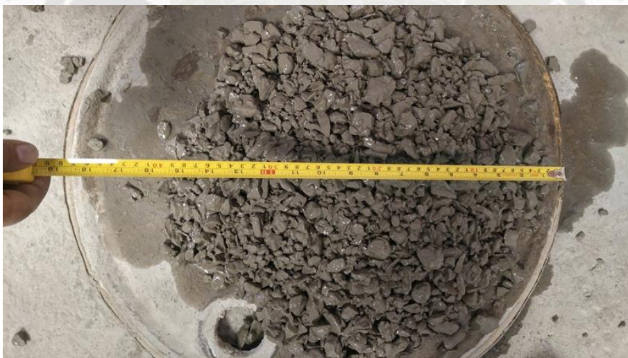
Fig. 4.8: El asentamiento se mide en forma horizontal. Fuente: Propia.
