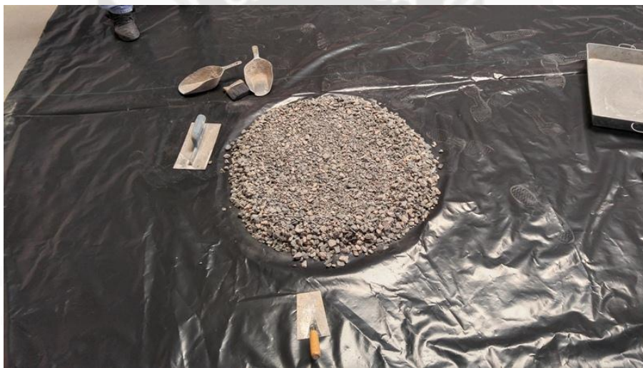
Fig. 2.5: Muestra de agregado grueso de cantera Poderosa. Fuente: Propia.
