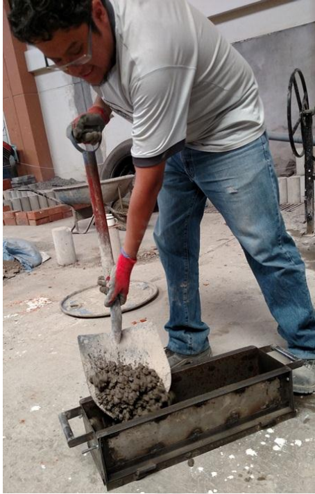
Fig. 4.19: En Vigas se colocara el concreto en 2 capas de 7.5 cm de espesor. Fuente: Propia.
