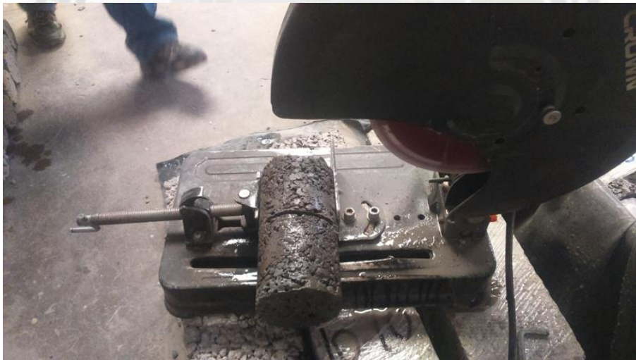
Fig. 4.35: Cortar las probetas de 10 x20 cm. En partes iguales (10 x 10 cm.). Fuente: Propia.
