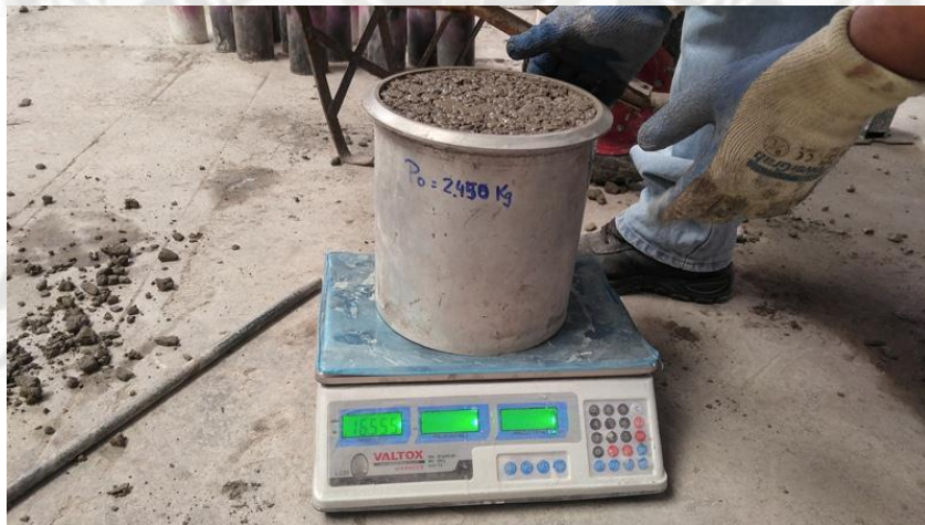
Fig. 4.10: Limpiar completamente y proceder a determinar el peso. Fuente: Propia.
