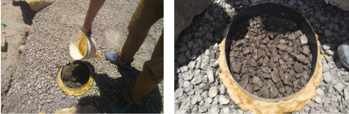
Fig. 6.16: Pre - humectación. Fuente: Propia.
