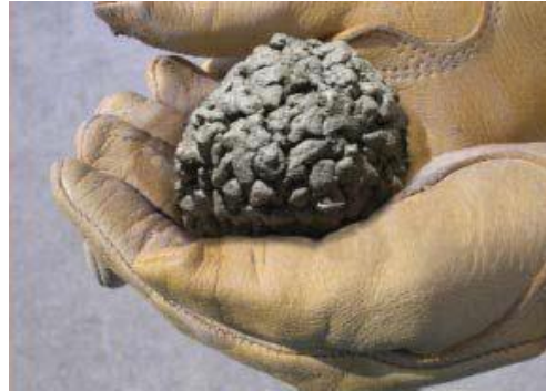
Fig. 3.2: Adecuada cantidad de agua
