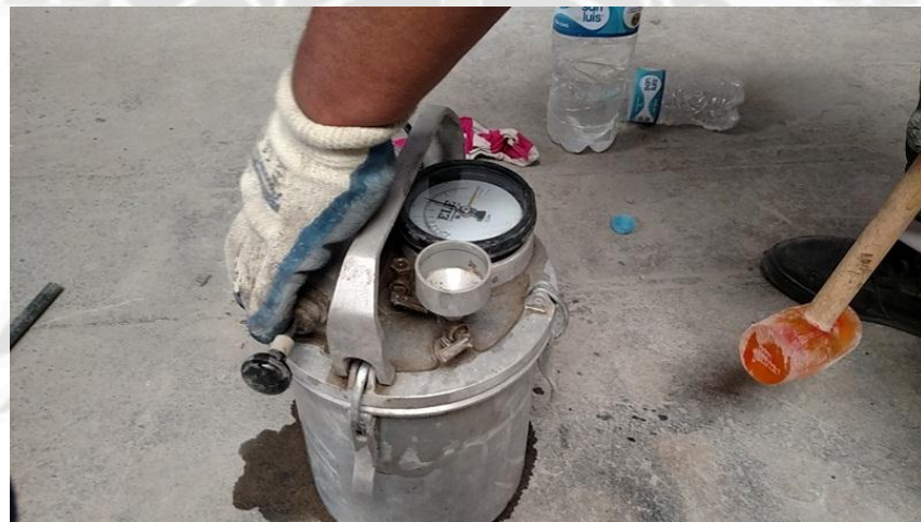
Fig. 4.13: Presionar el percutor de aire y dar golpes con el martillo de goma. Fuente: Propia.
