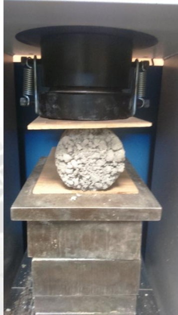
Fig. 4.28: Colocar una tablilla centrada, apoyada en el eje de la placa inferior y otra en la parte superior. Fuente: Propia.
