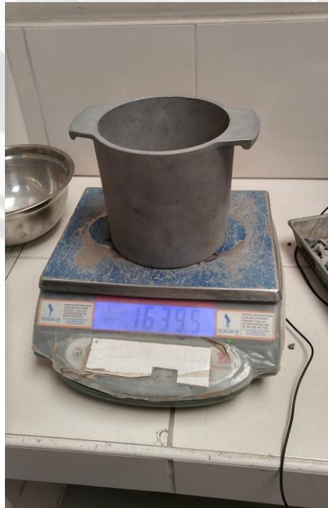
Fig. 2.41: Se determina el peso del recipiente de medida más su contenido. Fuente: Propia.
