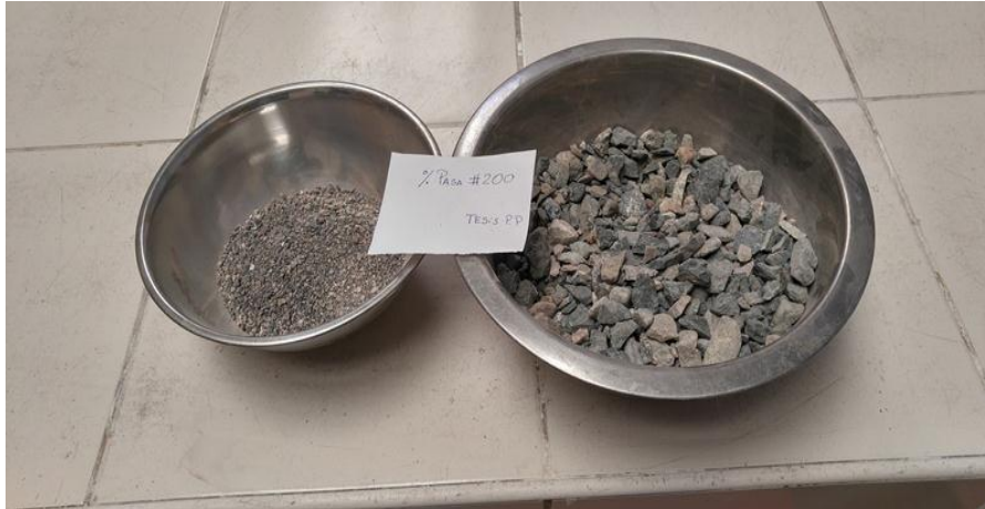
Fig. 2.18: Material representativo seleccionado para el ensayo de la malla # 200. Fuente: Propia.
