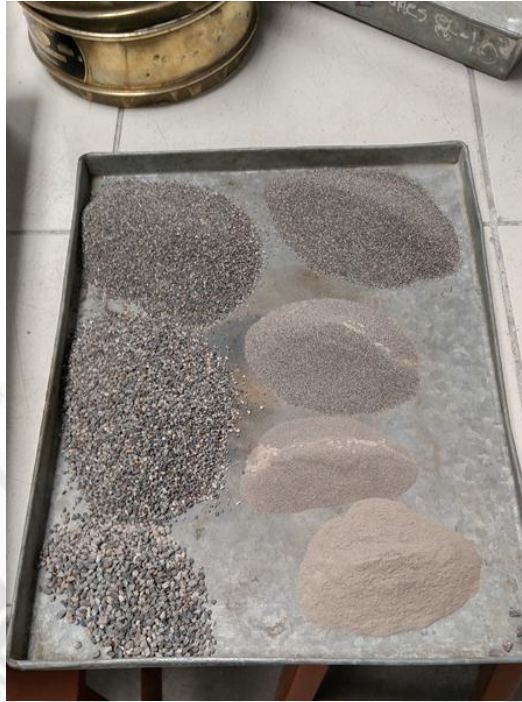
Fig. 2.17: Pesos retenidos del ensayo de granulometría Fuente: Propia.
