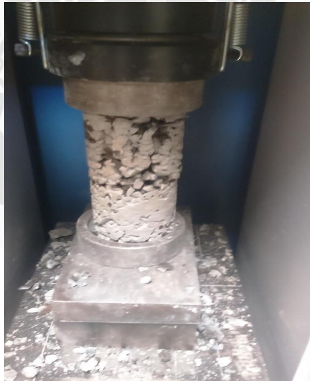
Fig. 1.28: Probeta sometida a compresión. Fuente: Propia.
