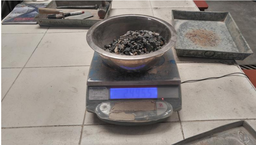
Fig. 2.22: Se pesa la muestra saturado con superficie seca (S.S.S). Fuente: Propia.
