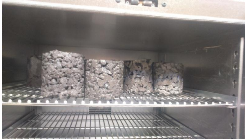
Fig. 4.36: Lavar bien las muestras y dejarlas secar en el horno por 24 horas. Fuente: Propia.
