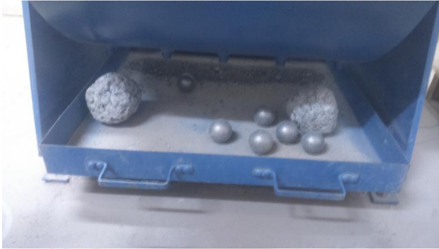
Fig. 4.39: Se descarga el material del cilindro. Fuente: Propia.
