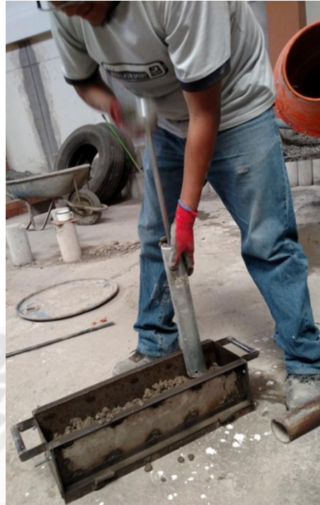
Fig. 4.20: Se compacta con el martillo proctor, Se da 30 golpes cubriendo toda el área. Fuente: Propia.
