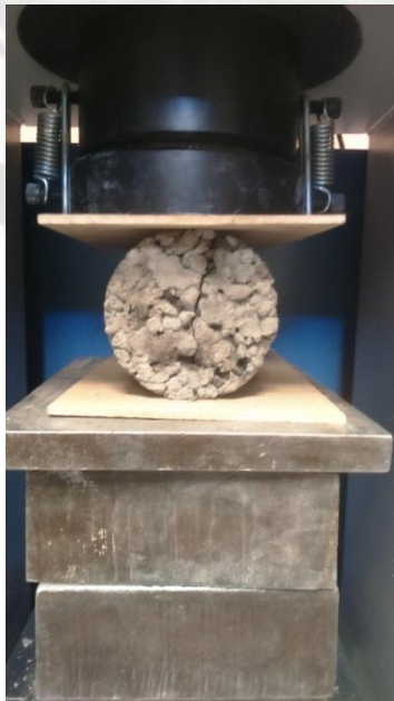
Fig. 4.29: Aplicar aproximadamente un 5% de la carga de rotura prevista, verificando que la probeta se mantiene centrada y alineada. Fuente: Propia.
