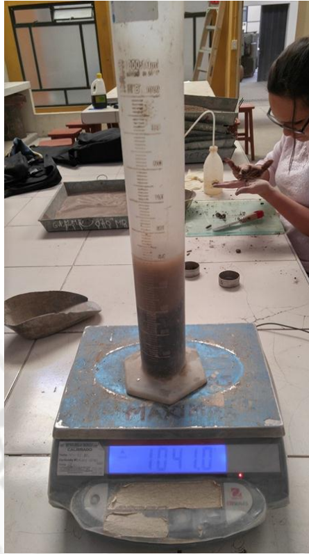
Fig. 2.32: Adicionarle un poco de agua hasta saturar la muestra por completo. Fuente: Propia.
