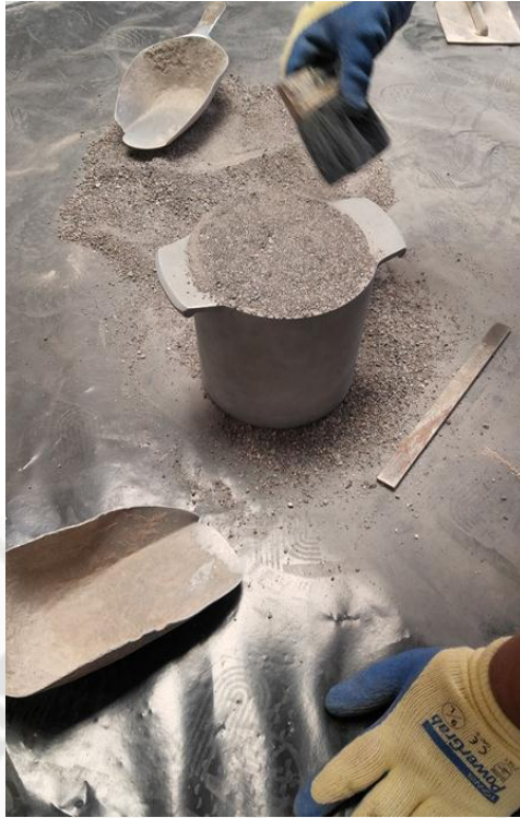
Fig. 2.40: Enrasar y limpiar los bordes del recipiente. Fuente: Propia
