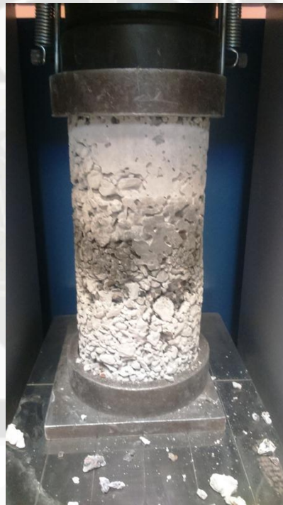
Fig. 4.26: Colocar la probeta en los platos de retención y accionar la palanca de la prensa. Fuente: Propia.
