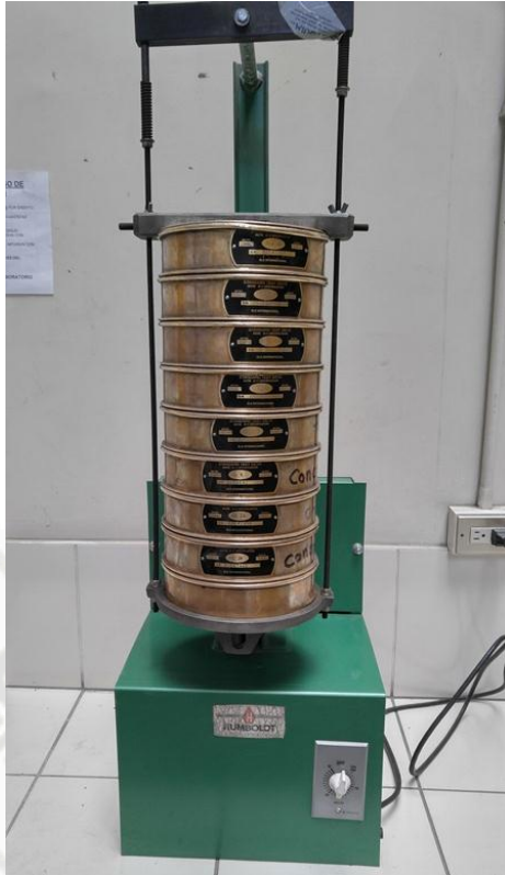
Fig. 2.12: Equipo (tamizadora). Fuente: Propia.
