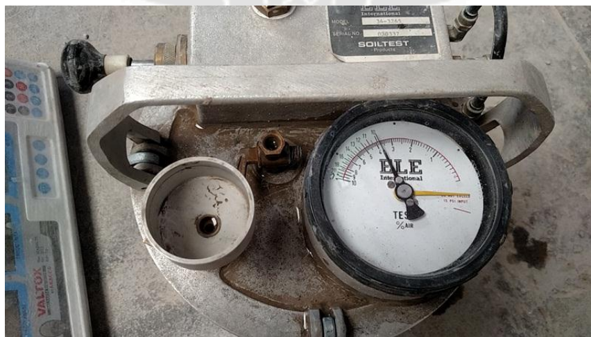
Fig. 4.14: Leer el porcentaje de aire atrapado en la olla Washington. Fuente: Propia.
