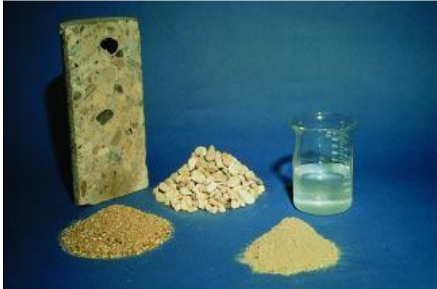
Fig. 1.2: Componentes del concreto, cemento, agua, agregado grueso, agregado fino, son combinados para formar el concreto. Fuente: PORTLAND CEMENT ASSOCIATION (PCA) – 2004.
