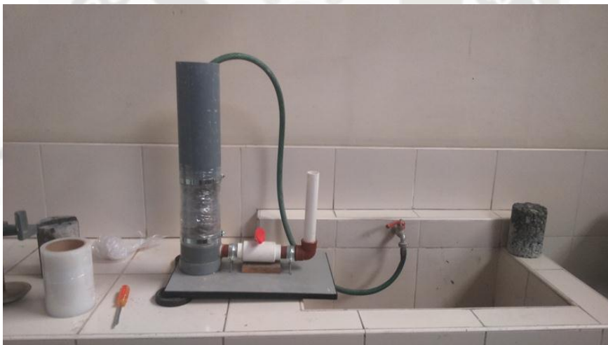
Fig. 4.45: Saturar la muestra y establecer el flujo establecido a los 30 cm de columna de agua. Fuente: Propia.
