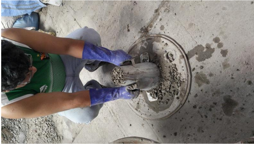
Fig. 4.4: Levantar el cono verticalmente de 5 a 7 segundos. Fuente: Propia.
