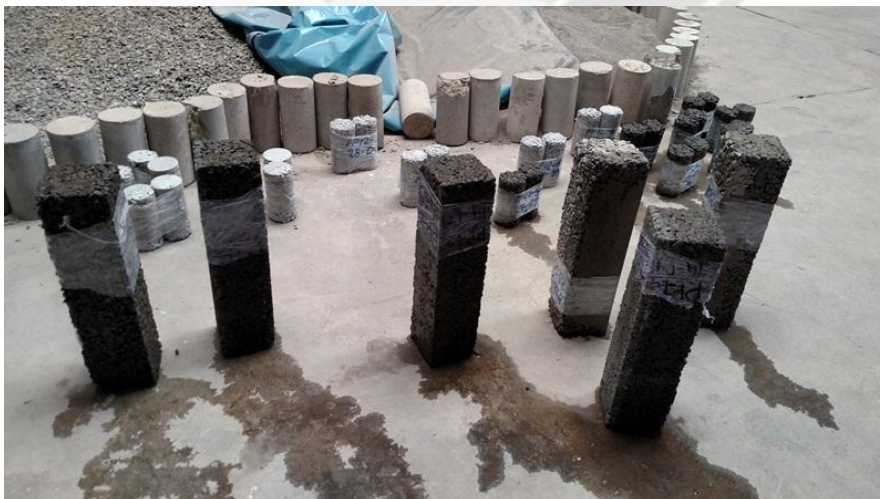
Fig. 4.31: Las Vigas serán retiradas de la poza de curado. Fuente: Propia.
