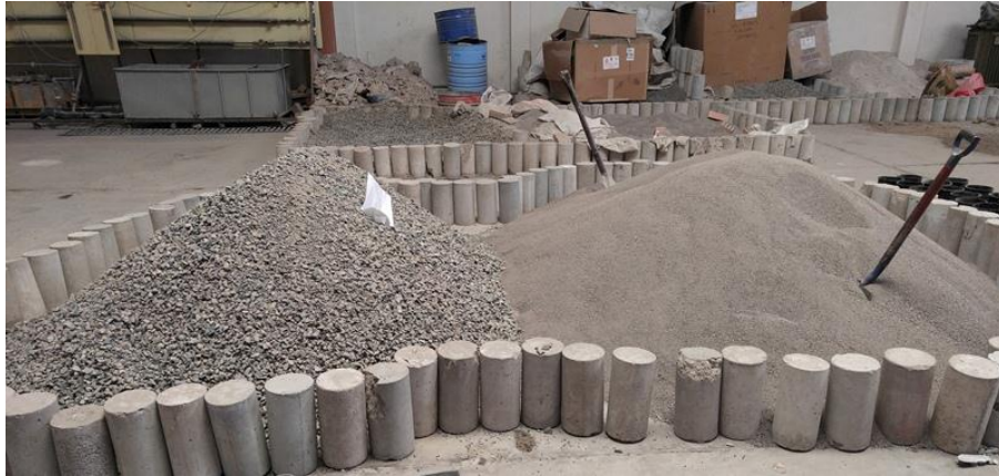
Fig. 2.4: Muestra de agregado grueso y fino de la cantera Poderosa. Fuente: Propia.
