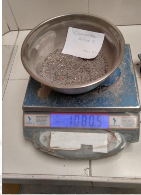
Fig. 2.14: Material representativas seleccionado para la granulometría. Fuente: Propia.
