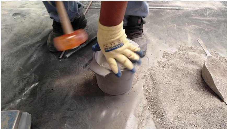
Fig. 2.38: Con el martillo de goma dar 12 golpes al recipiente metálico, para el PUC. Fuente: Propia.
