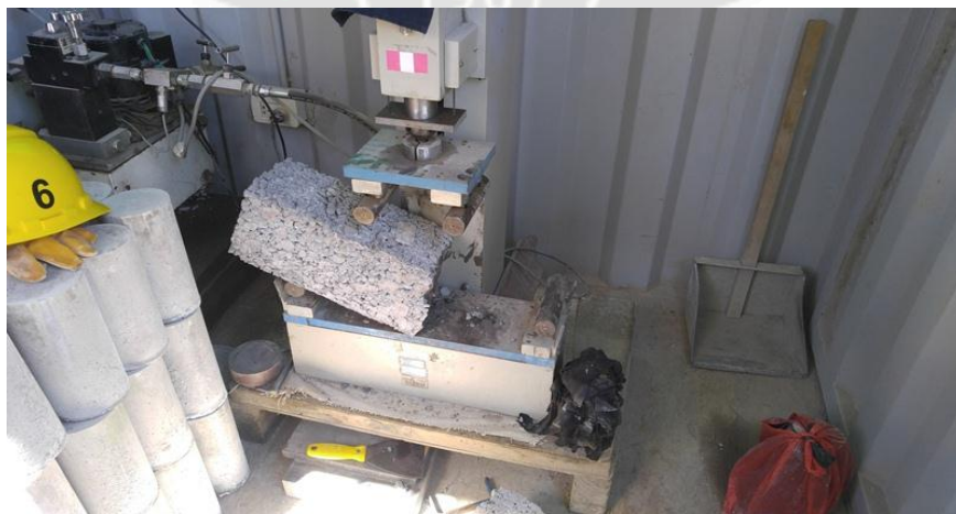
Fig. 4.34: Alcanzar la rotura en un tiempo igual o superior a 300 seg. Fuente: Propia.
