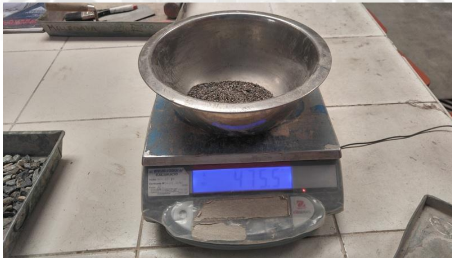
Fig. 2.33: Se coloca en un recipiente y se pone al horno por 24 horas y se toma el peso seco. Fuente: Propia.
