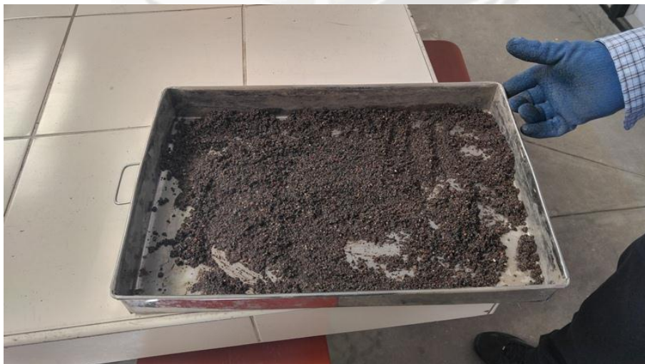
Fig. 2.26: Colocar el agregado en bandeja para hacer secar al aire. Fuente: Propia.
