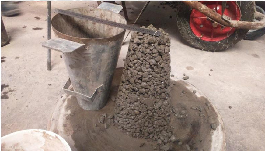
Fig. 4.5: Medir la distancia entre la altura del molde. Fuente: Propia.
