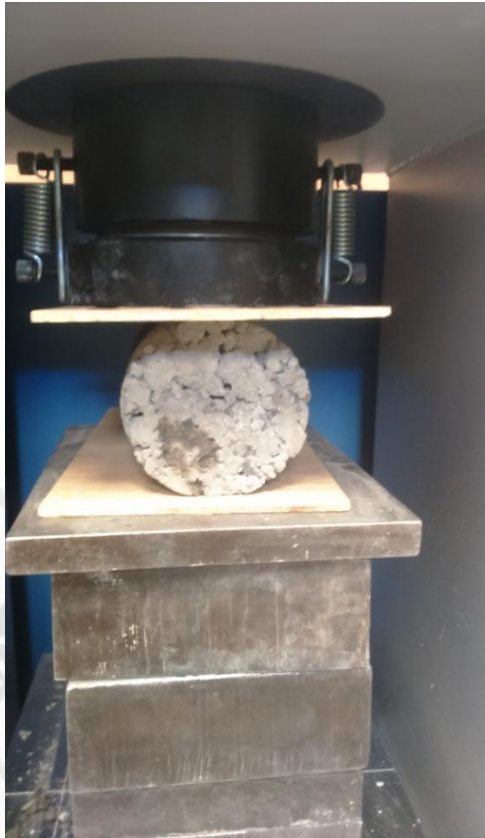
Fig. 1.27: Probeta sometida a tensión indirecta. Fuente: Propia.
