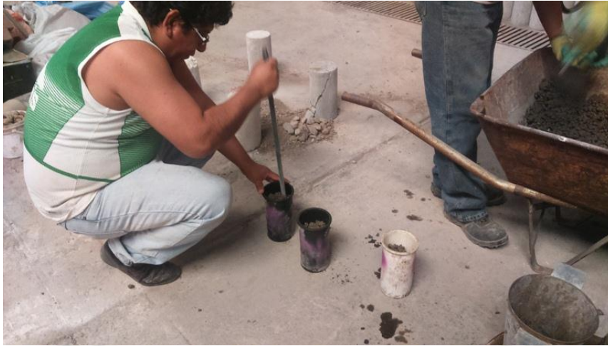
Fig. 4.17: Colocar el concreto en 2 capas, cada capa se chucea 25 veces en forma de espiral. Fuente: Propia.
