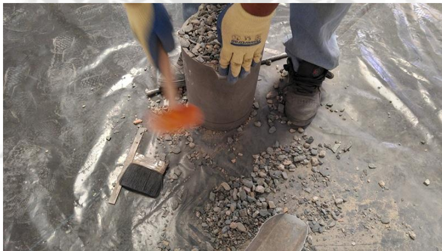
Fig. 2.43: Con el martillo de goma dar 12 golpes al recipiente metálico, para el PUC. Fuente: Propia.
