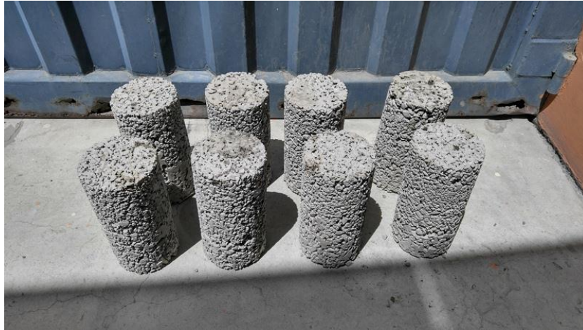
Fig. 4.25: Se colocara en la poza de curado con una temperatura de 23\text{ }^{\circ}\text{C} \pm 2\text{ }^{\circ}\text{C} . Fuente: Propia.
