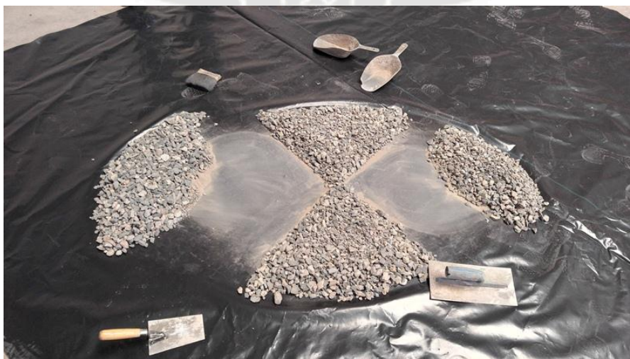
Fig. 2.9: Selección de muestras representativas. Fuente: Propia.
