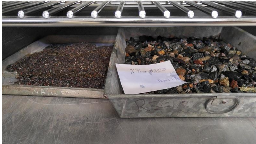
Fig. 2.19: Se coloca las muestras al horno para realizar el ensayo de la malla # 200. Fuente: Propia.
