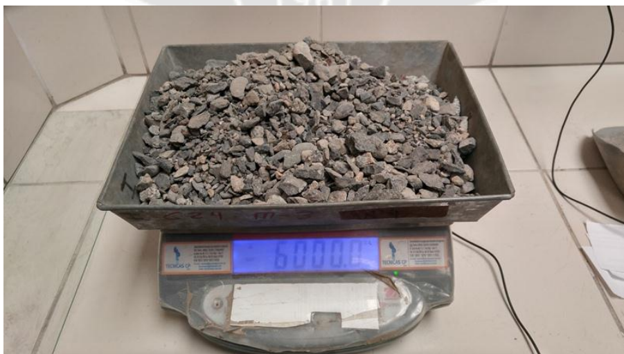
Fig. 2.11: Material para realizar el ensayo de la granulometría. Fuente: Propia.
