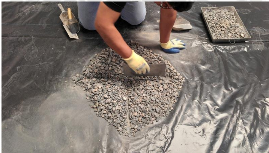
Fig. 2.8: Separación de agregados en cuatro partes. Fuente: Propia.
