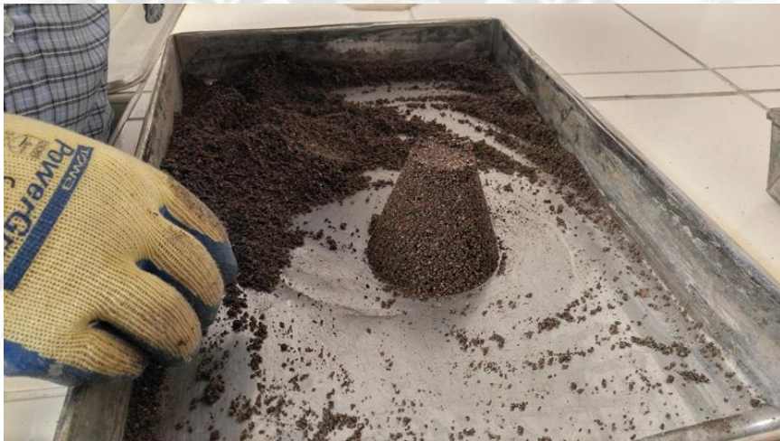
Fig. 2.28: Cuando existe humedad libre, el cono conserva su forma. Fuente: Propia.
