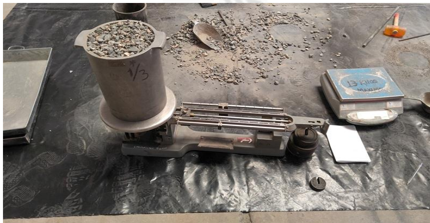
Fig. 2.44: Se enraza y se pesa en la balanza. Fuente: Propia.
