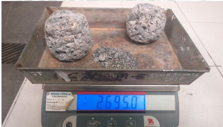
Fig. 4.40: Se procederá a pesar el material retino por el tamiz # 12. Fuente: Propia.
