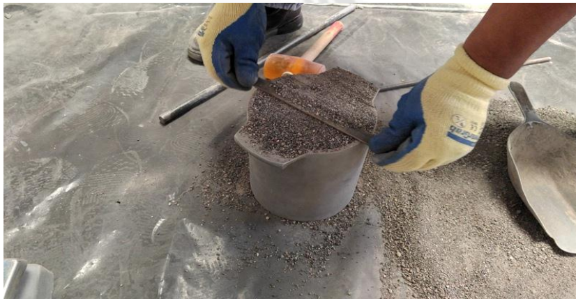
Fig. 2.39: Enrasar con regla metálica hasta el nivel del borde superior. Fuente: Propia.
