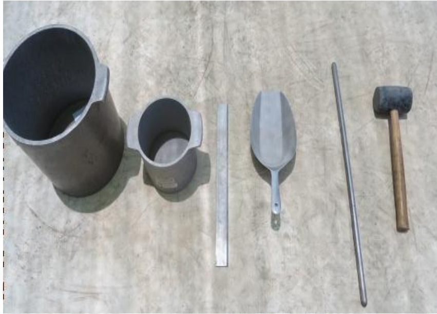
Fig. 2.35: Recipiente metálico para agregado grueso y fino. Fuente: Propia.
