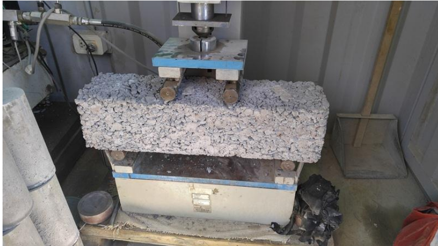
Fig. 4.32: La distancia entre las líneas de apoyo y los extremos de la viga debe ser igual o mayor a 2,5 cm. Fuente: Propia.
