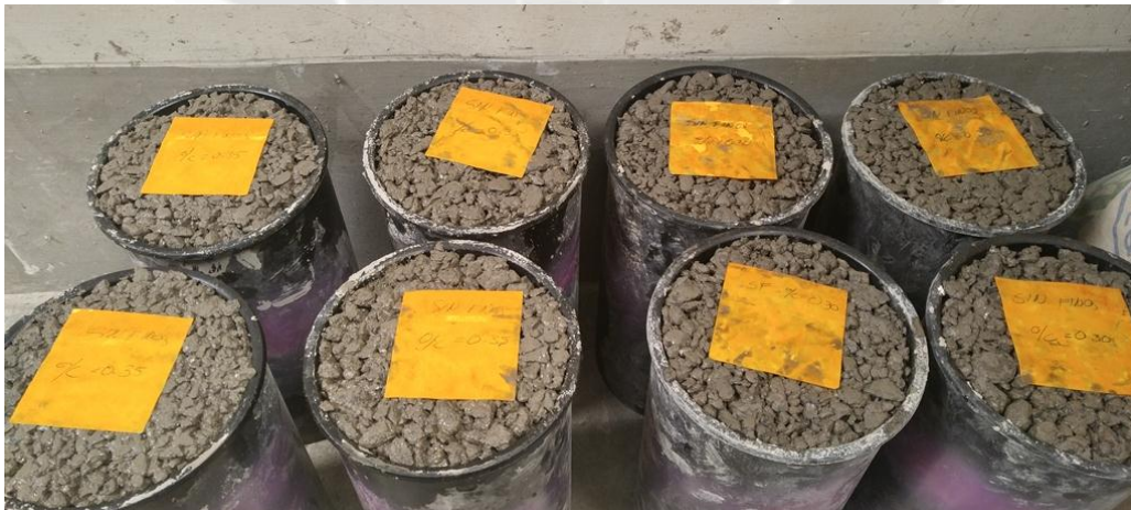
Fig. 1.14: Concreto puesto en moldes para su secado. Fuente: Propia.
