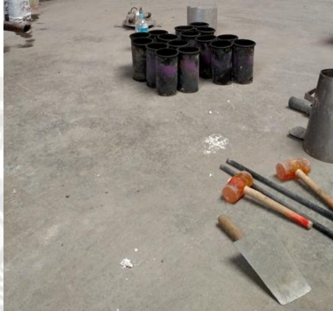
Fig. 4.15: Moldes cilíndricos de 10 x 20 cm. Fuente: Propia.
