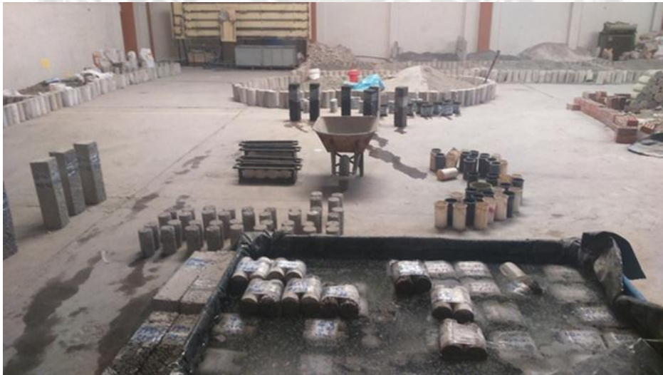
Fig. 4.23: Se colocara en la poza de curado con una temperatura de 23\text{ }^{\circ}\text{C} \pm 2\text{ }^{\circ}\text{C} . Fuente: Propia.
