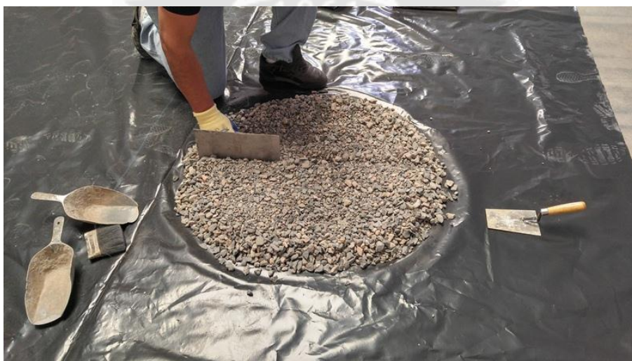
Fig. 2.6: Delimitación y trazo de diámetro perpendicular. Fuente: Propia.
