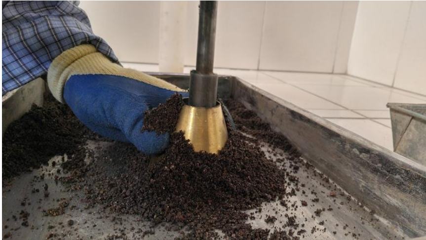
Fig. 2.27: Compactar el material en molde con 25 golpes/capa. Fuente: Propia.
