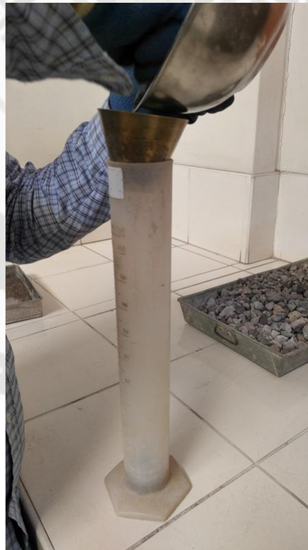
Fig. 2.31: Colocar los 500gr. en una probeta graduada de peso conocido. Fuente: Propia.
