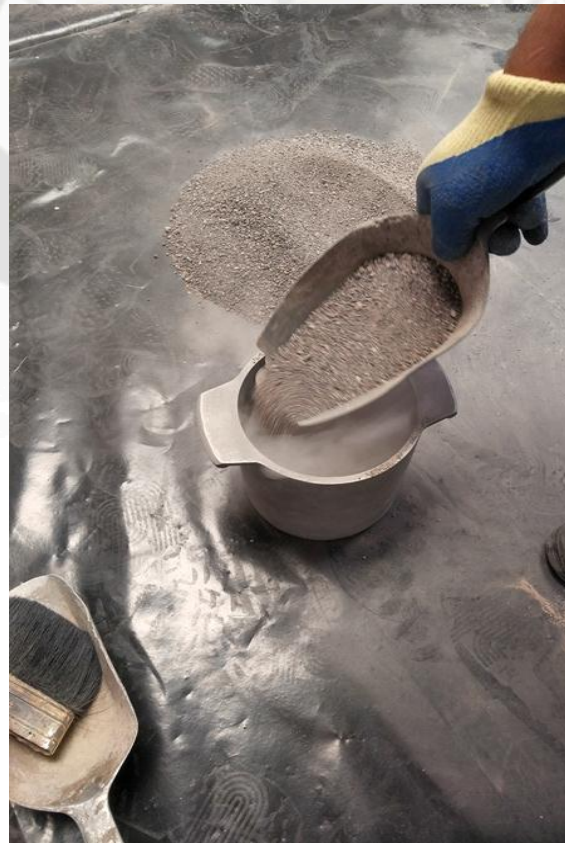
Fig. 2.36: Se llena la tercera parte del recipiente de medida. Fuente: Propia.
