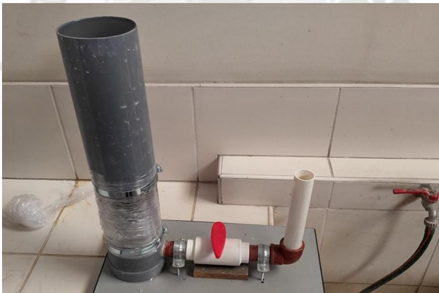
Fig. 1.26: Ensayo de permeabilidad del concreto. Fuente: Propia.
