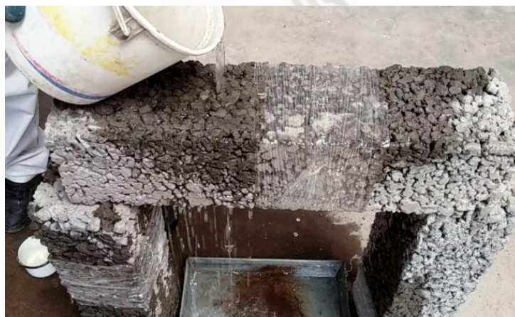
Fig. 1.21 Vigas de concreto permeable. Fuente: Propia.
