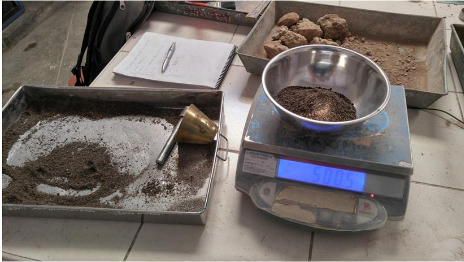
Fig. 2.30: Se pesa 500gr. De agregado (S.S.S.). Fuente: Propia.
