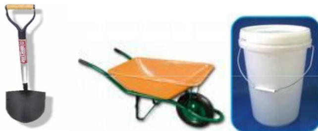
Fig. 2.2: Equipo a utilizar en el muestreo de los agregados.
