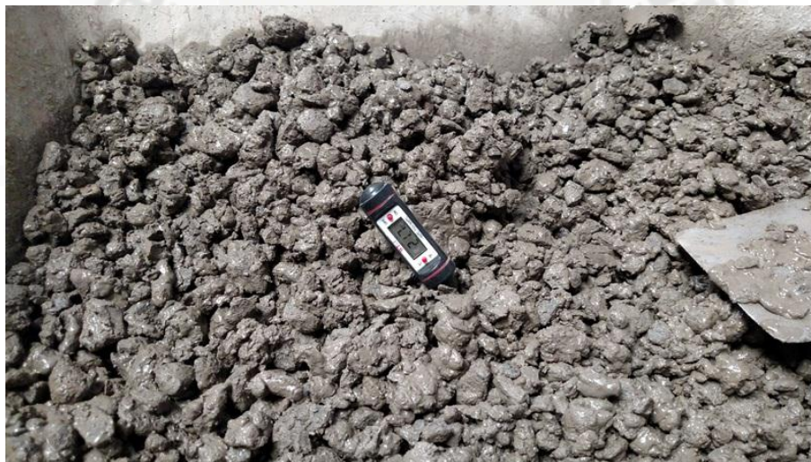
Fig. 4.1: Introducir el termómetro y esperar por lo menos 2 minutos. Fuente: Propia.
