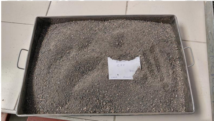
Fig. 2.10: Material seleccionado para la granulometría. Fuente: Propia.
