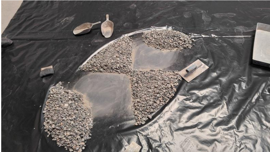
Fig. 2.7: Reducción del agregado mediante el cuarteo. Fuente: Propia.
