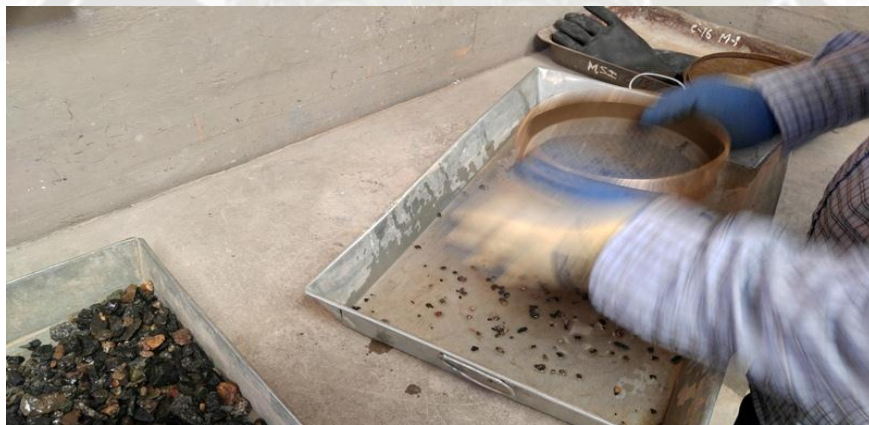
Fig. 2.21: Tamizar el material por la malla N° 4. Fuente: Propia.
