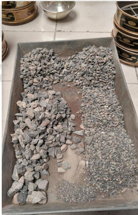
Fig. 2.13: Pesos retenidos del ensayo de granulometría. Fuente: Propia.
