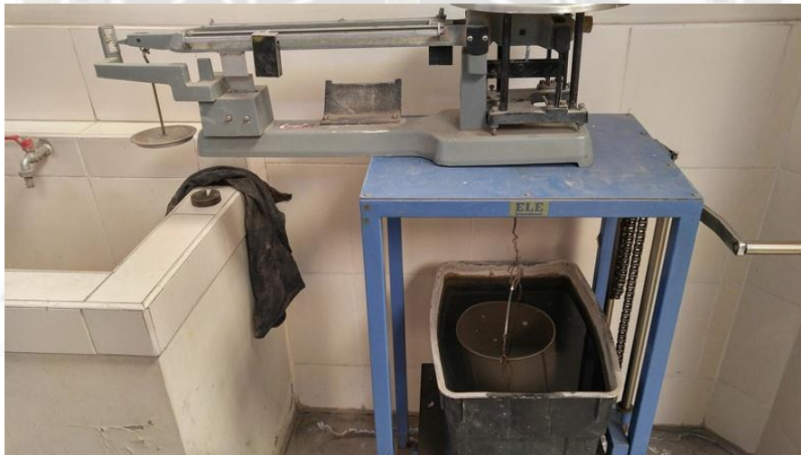
Fig. 2.23: Se pesa la canastilla completamente sumergida en el depósito de agua. Fuente: Propia.
