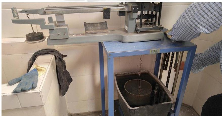
Fig. 2.24: Se la muestra saturada en la canastilla y se sumerge. Fuente: Propia.
