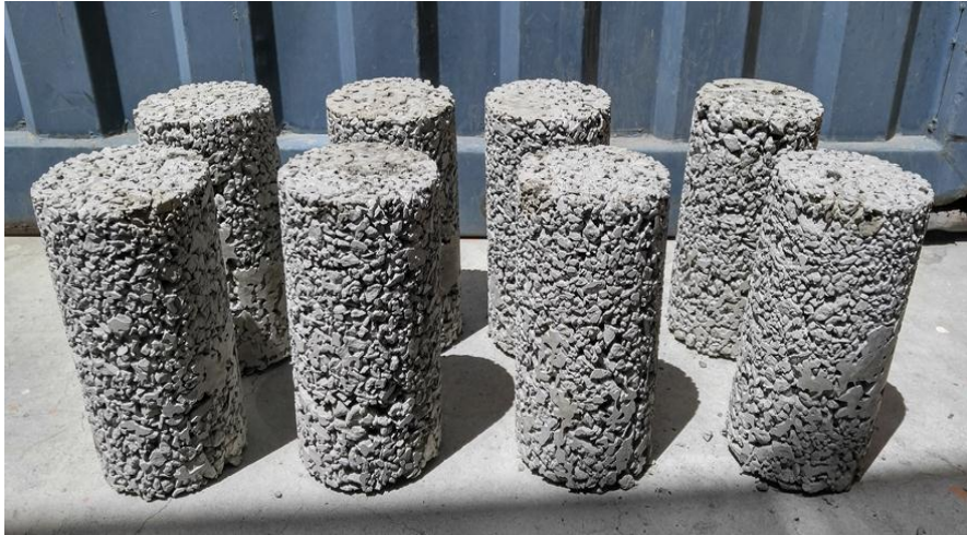
Fig. 1.25: Porosidad del concreto. Fuente: Propia.
