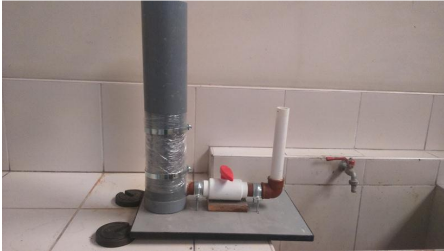
Fig. 4.44: Se procede a colocar la muestra en el permeámetro de carga variable. Fuente: Propia.
