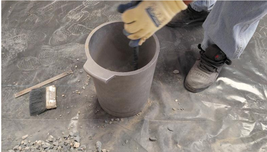
Fig. 2.42: Se apisona la capa de agregado con la varilla 5/8", compactando. Fuente: Propia.
