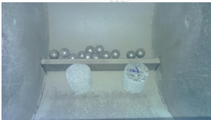
Fig. 4.38: Se coloca la muestra y la carga abrasiva, en la máquina de Los Ángeles. Fuente: Propia.
