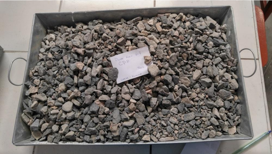
Fig. 1.20: Agregado grueso. Fuente: Propia.
