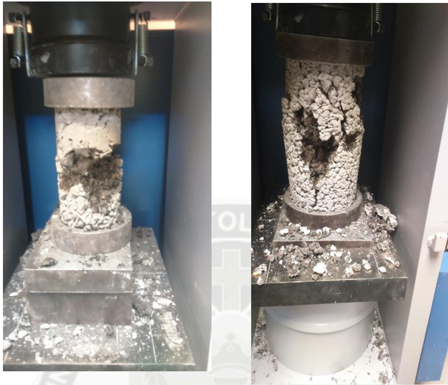
Fig. 4.27: Aplicar carga en forma continua y uniforme. Fuente: Propia.
