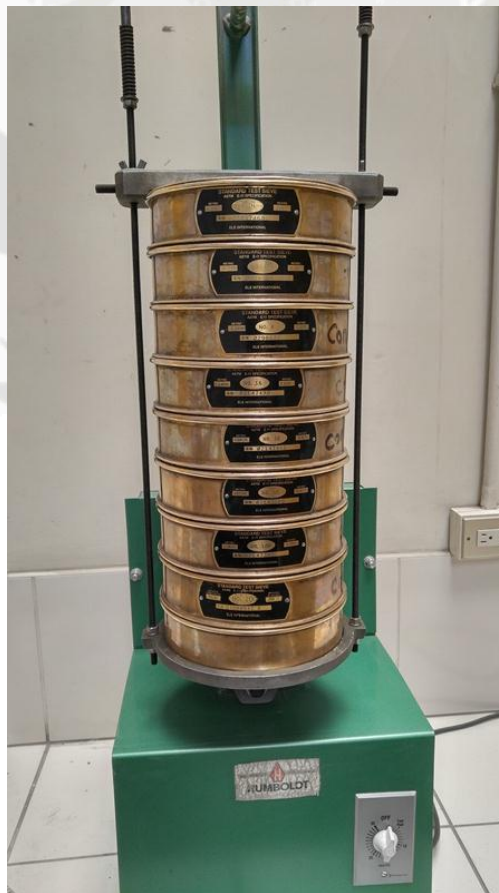
Fig. 2.15: Equipo (tamizadora) Fuente: Propia.
