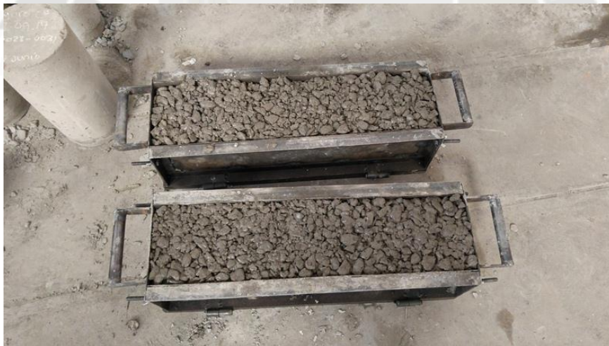
Fig. 4.21: Después de haber compactado, se procederá a enrasar al tope del molde usando la barra compactadora o una plancha de albañilería. Fuente: Propia.
