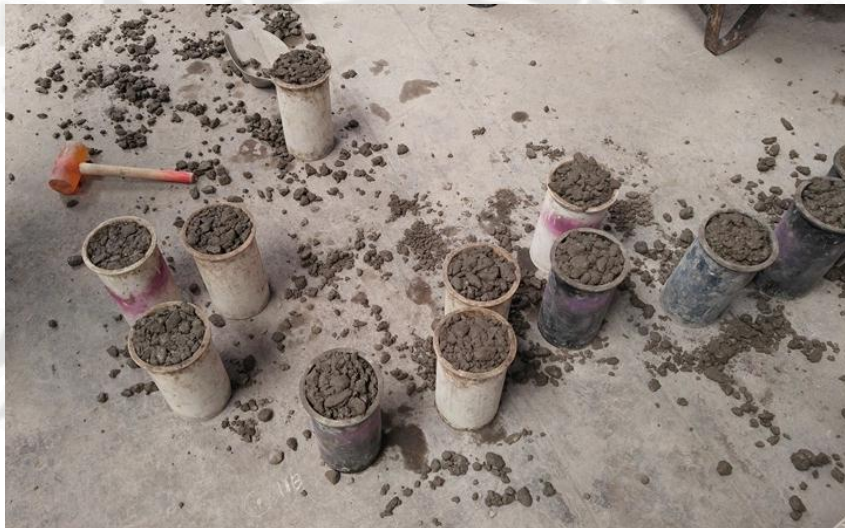
Fig. 4.18: Se golpea ligeramente las paredes del molde de 10 a 15 veces con el martillo de goma y en la última capa se procede a enrasar. Fuente: Propia.
