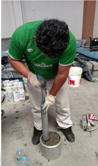
Fig.4.9: Compactar con el martillo Proctor. Cada capa será compactada con 20 golpes. Fuente: Propia.
