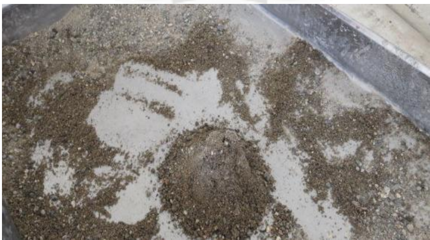
Fig. 2.29: El material alcanzó la condición (SSS). Fuente: Propia.
