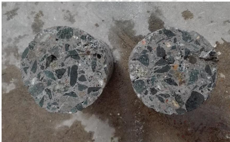
Fig. 1.4 Sección transversal del concreto endurecido. Fuente: Propia.
