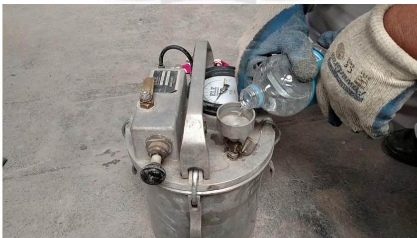
Fig. 4.11. Echar agua en la llave de purga. Fuente: Propia.
