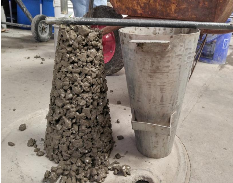
Fig. 1.23: Concreto con bajo revenimiento. Fuente: Propia.
