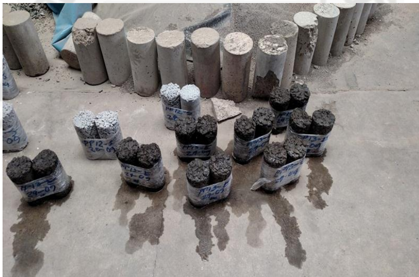
Fig. 4.24: Las probetas serán retiradas de la poza de curado, según el día de ensayo. Fuente: Propia.
