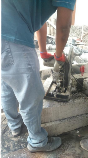
Fig. 4.42: Cortar las probetas de 10 cm de diámetro x 15 cm de alto. Fuente: Propia.
