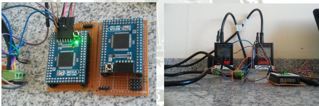
Ilustración 33: Construcción física de una red ALICAT. Fuente: Elaboración Propia
