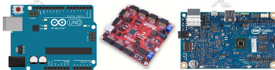
Ilustración 14. Microcontroladores: Arduino, CereBot y Galileo [72], [91] y [92]
