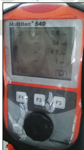
Figura N° 20: Analizador de gases Sewerin Multitec 540 usado para la determinación porcentual de biometano en el biogás generado.
