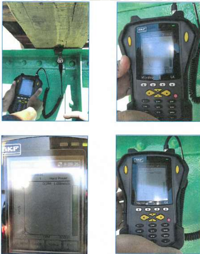
Figura 70: Toma de lecturas de vibraciones en puente Sumbay
