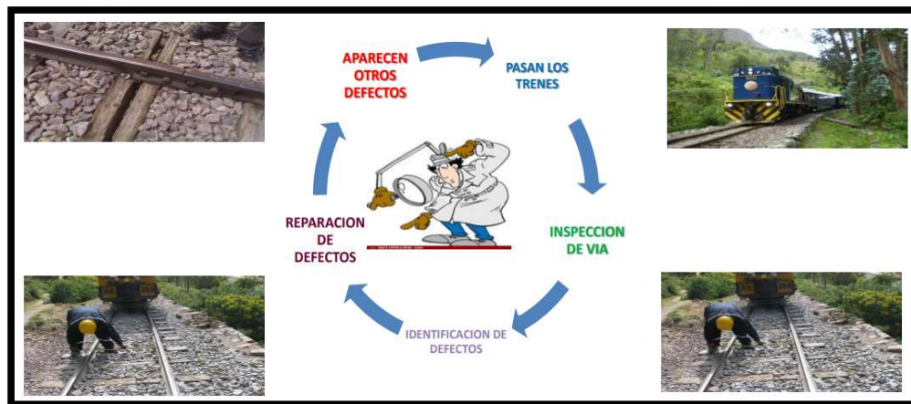
Figura 16: Ciclo de mantenimiento de la vía férrea
