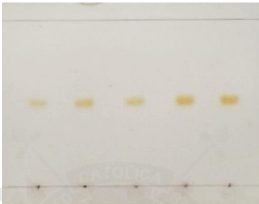
Anexo 5. Derivatización en TLC curva de calibración de clorpirifos, inmersión en reactivo AgNO_3 0.12 M (140°C).
