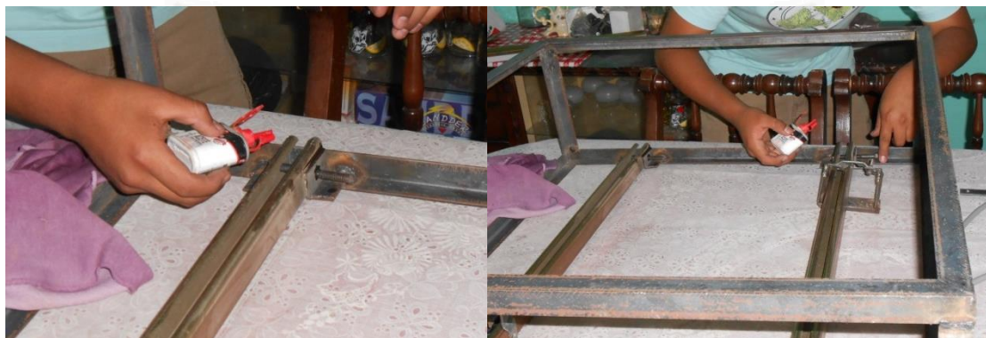
Fig. 3.18 Engrase de los rodamientos y de la estructura
