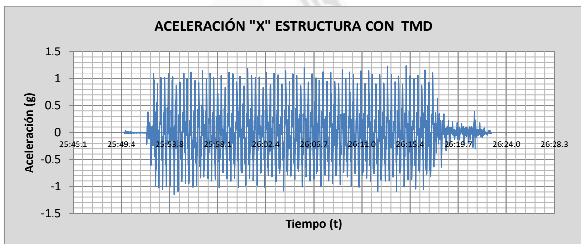
Fig. 5.50 Acelerograma de la estructura F=3.0 Hertz A=1.5cm con TMD
