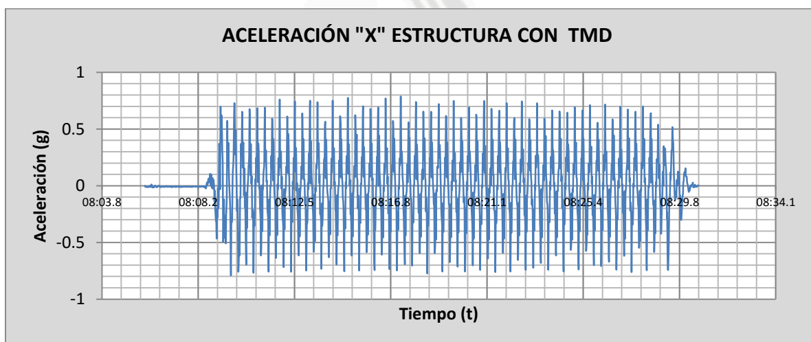
Fig. 5.66 Acelerograma de la estructura F=3.0 Hertz A=1.1 cm con TMD
