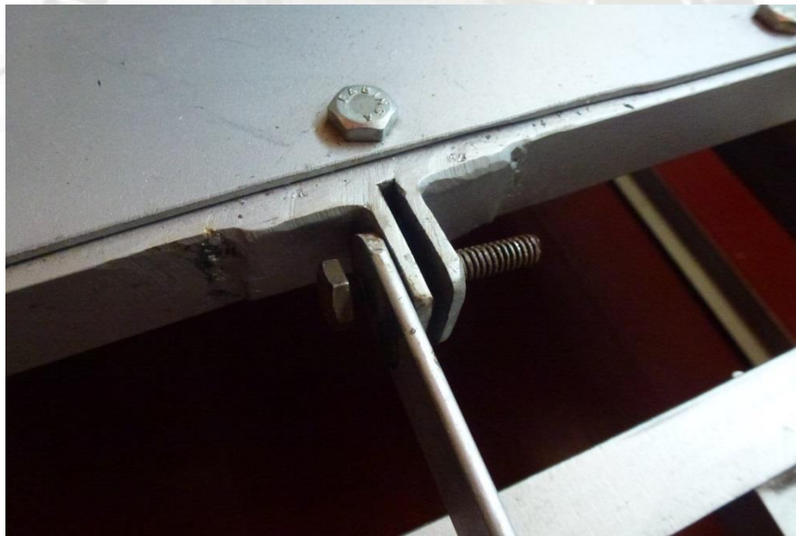
Fig. 3.24 Unión de la biela con la mesa vibratoria
