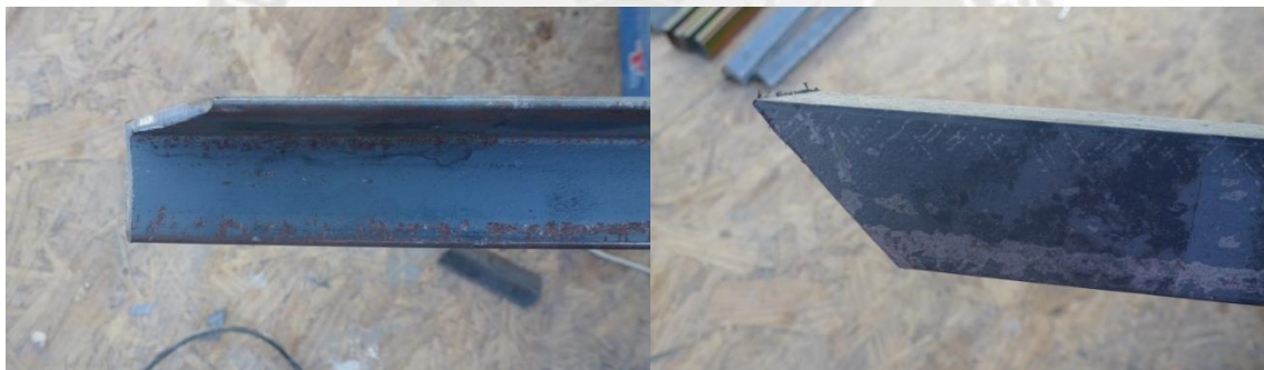
Fig. 3.16 Cortes a 45° de los perfiles
