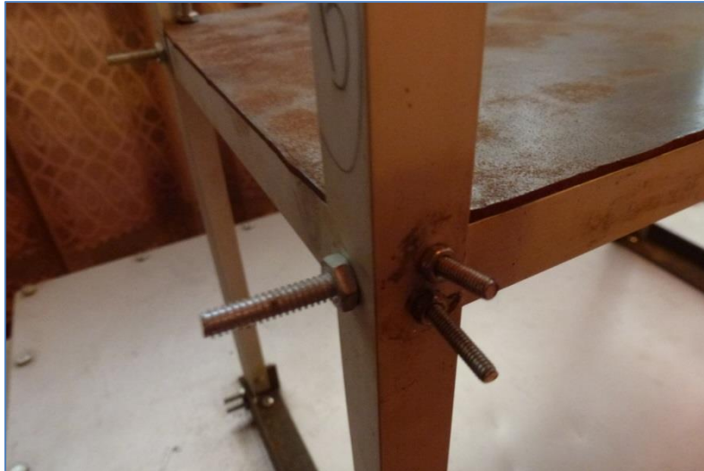
Fig. 4.4 Doble empernado para simular empotramiento
