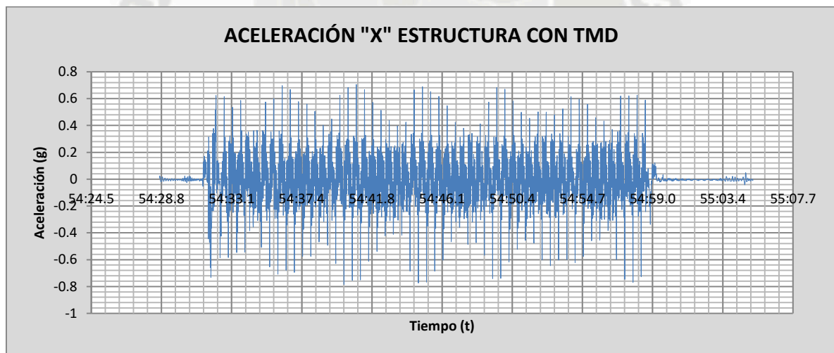
Fig. 5.32 Acelerograma de la estructura F=2.0 Hertz A=1.7 cm con TMD
