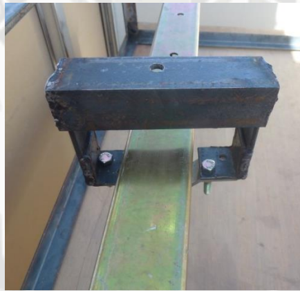
Fig. 3.21 Estructura armada sobre el riel
