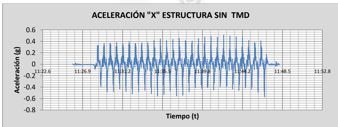
Fig. 5.60 Acelerograma de la estructura F=1.5 Hertz A=1.1 cm sin TMD
