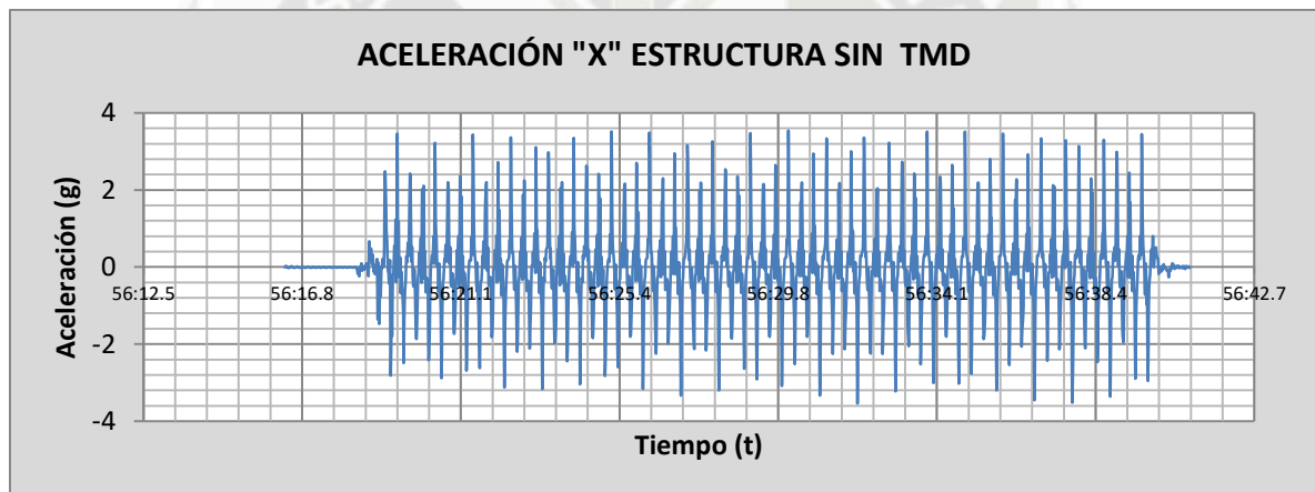
Fig. 5.49 Acelerograma de la estructura F=3.0 Hertz A=1.5cm sin TMD
