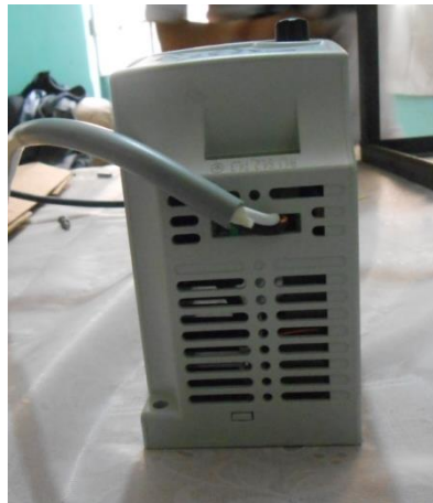
Fig. 3.27 Salida monofásica del variador de frecuencias
