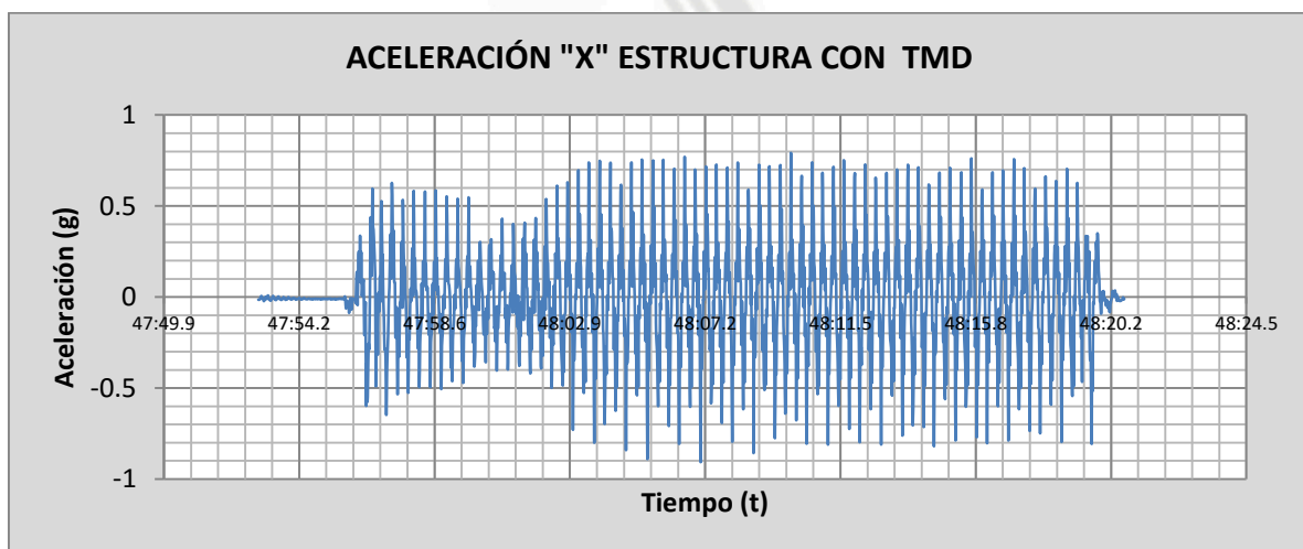
Fig. 5.58 Acelerograma de la estructura F=3.0 Hertz A=0.9 cm con TMD
