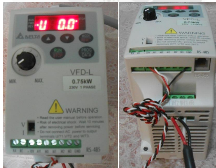
Fig. 3.4 Variador de Frecuencias
