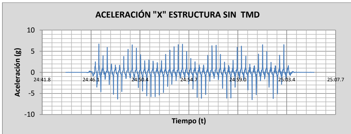
Fig. 5.72 Acelerograma de la estructura F=3.0 Hertz A=1.5 cm sin TMD
