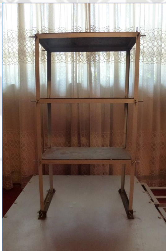
Fig. 4.9 Modelo armado sobre mesa vibratoria final
