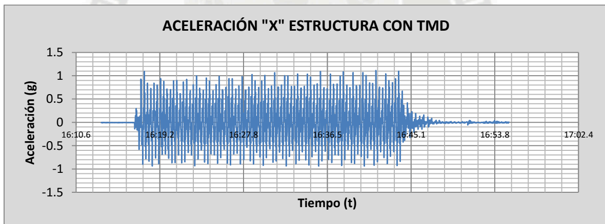
Fig. 5.44 Acelerograma de la estructura F=3.0 Hertz A=1.1\text{cm} con TMD
