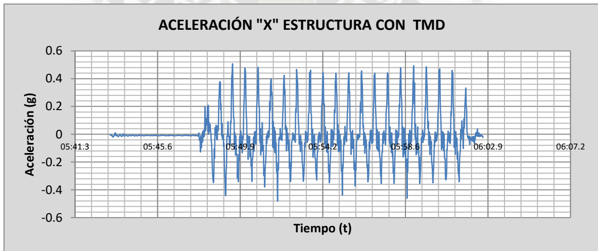
Fig. 5.62 Acelerograma de la estructura F=1.5 Hertz A=1.1 cm con TMD
