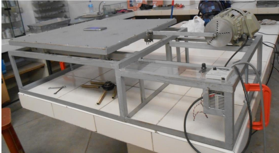
Fig. 3.33 Arriostamiento con Prensas en "C" de 15"
