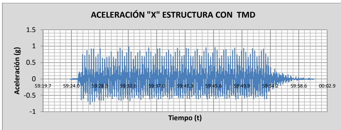
Fig. 5.38 Acelerograma de la estructura F=3.0 Hertz A=0.9 cm con TMD
