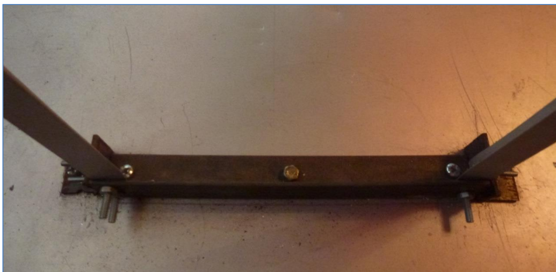
Fig. 4.8 Empotramiento del modelo con pernos y perfiles de acero
