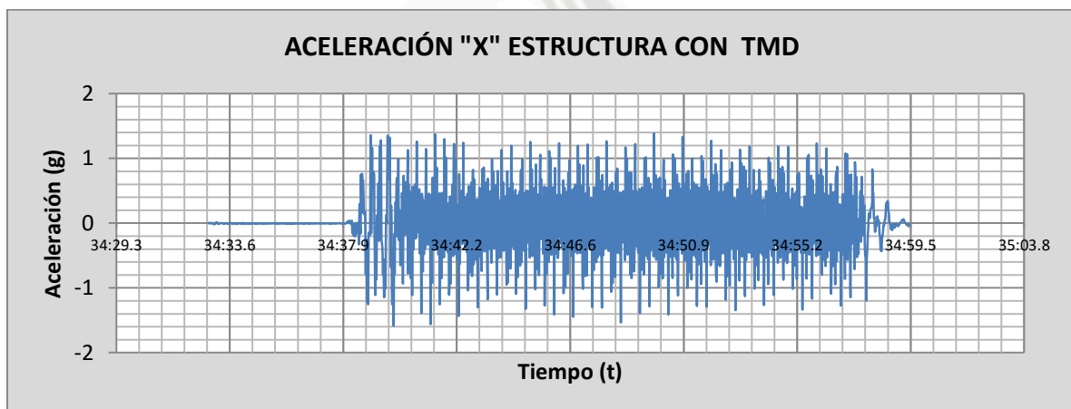
Fig. 5.74 Acelerograma de la estructura F=3.0 Hertz A=1.5 cm con TMD
