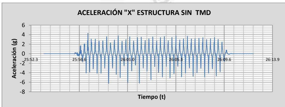
Fig. 5.37 Acelerograma de la estructura F=3.0 Hertz A=0.9 cm sin TMD
