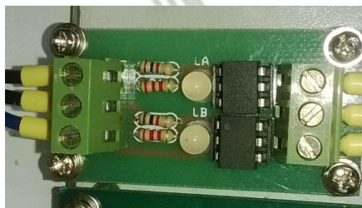
Figura 137: Circuito de encoder ensamblado.
