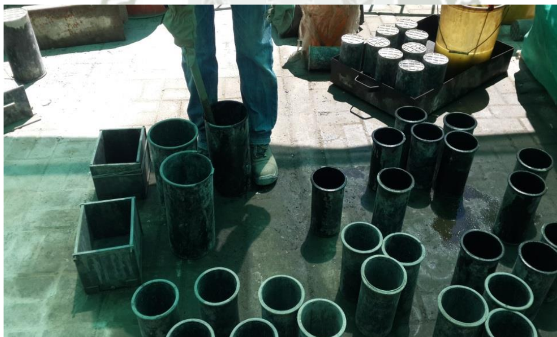
Encofrados plásticos y metálicos
