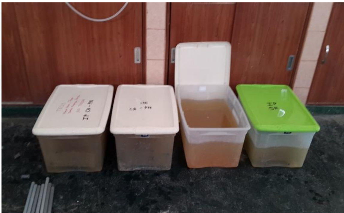
Recipientes donde se sumergieron las vigas para ensayo de sulfatos
