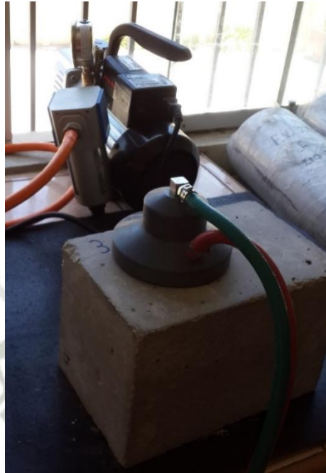
Ilustración 18 Ensayo de permeabilidad al aire de Torrent
