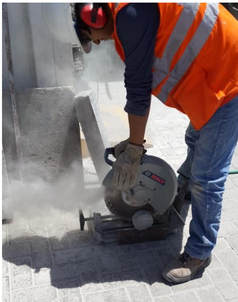
Cortado de concreto para ensayos de capilaridad y porosidad
