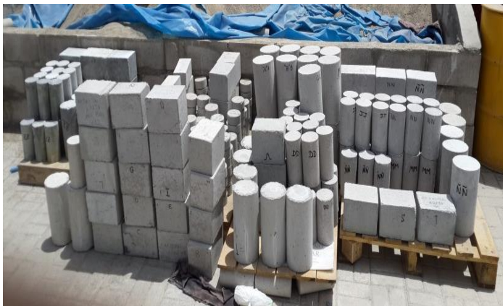
Almacenaje de especímenes de concreto en Laboratorio de Calidad de Supermix S.A.
