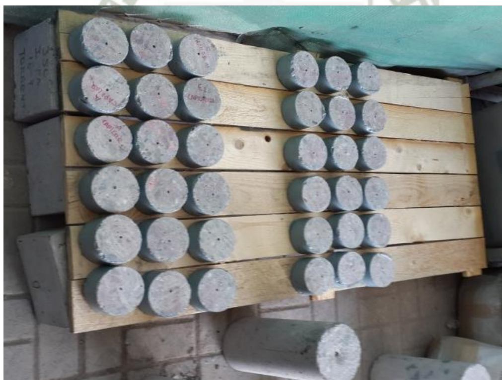
Secado de especímenes pintados para ensayo de capilaridad
