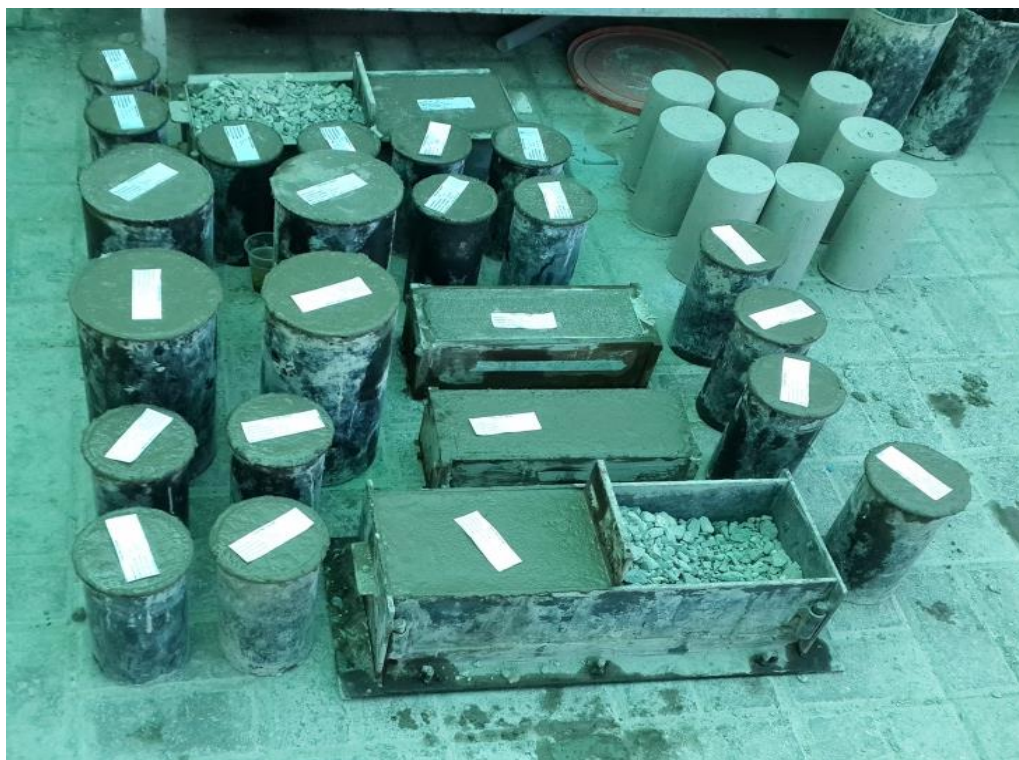
Encofrado del concreto
