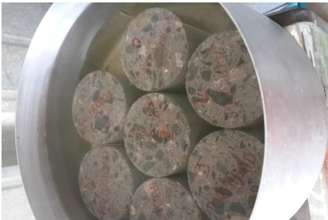
Especímenes de concreto hirviendo para ensayo de porosidad
