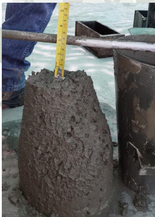
Ilustración 12 Medición de Slump con cono de Abraham
