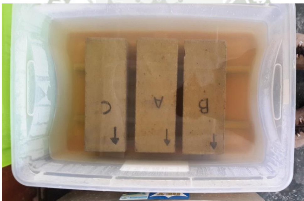
Vigas sumergidas en la solución de sulfato
