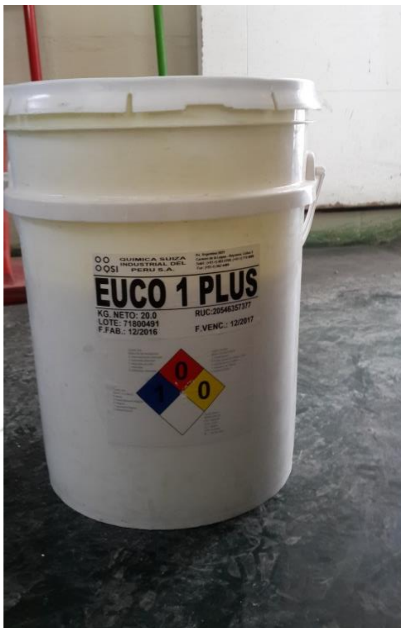
Aditivo impermeabilizante para ensayo de Profundidad de Penetración
