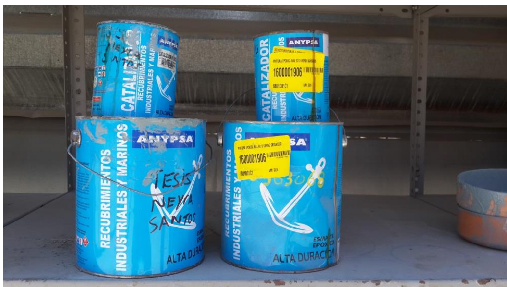
Pintura epoxica para recubrimiento de especímenes del ensayo de capilaridad
