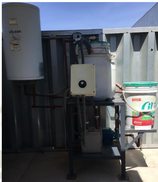
Figura 28. Reactor usado para el tratamiento biológico de residuos sólidos textiles y producción de gas
