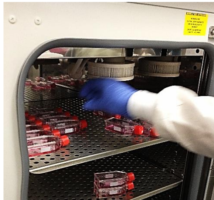
Fig. 9 Incubación con una atmósfera de 5% CO 2 , 95% aire a 37 °C. Fuente: Elaboración propia
