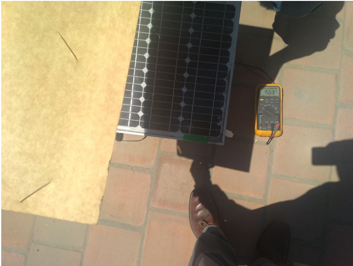
Ilustración 57 Mitad de panel ensombrecido. Lectura de voltaje 15.53
