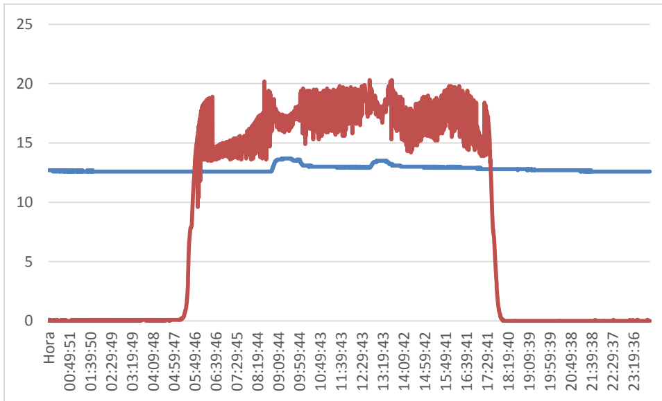
Ilustración 47 Datos del día 14 de setiembre en rojo el voltaje del panel fotovoltaico. En Azul el voltaje de las baterías.
