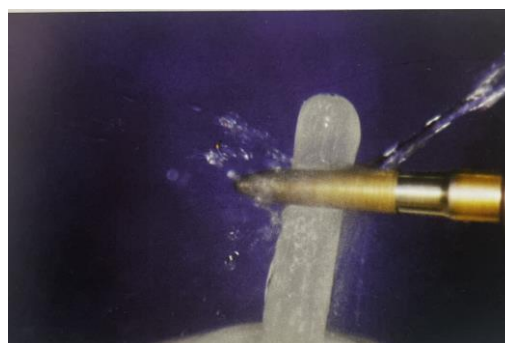
Figura 25: Imagen del poste siendo seccionado con punta diamantada bajo refrigeración, lo más perpendicular posible a las fibras (Muñiz, 2011).
