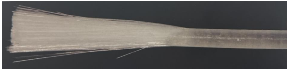
Figura 2: Imagen ilustrativa del proceso de fabricación de un poste de fibra de vidrio translúcido a partir de un asta de fibras de vidrio y resina epoxi (White Post DC, FGM). A la derecha se tiene el asta lista, con las fibras ya inmersas en resina epoxi y a la izquierda, las fibras de vidrio alineadas longitudinalmente, antes de la combinación con la resina. La comparación de las extremidades muestra la translucidez obtenida con la combinación de las propiedades ópticas de las fibras y de la resina y da una idea de translucidez que el poste posee internamente en su estructura (Muñiz, 2011).
