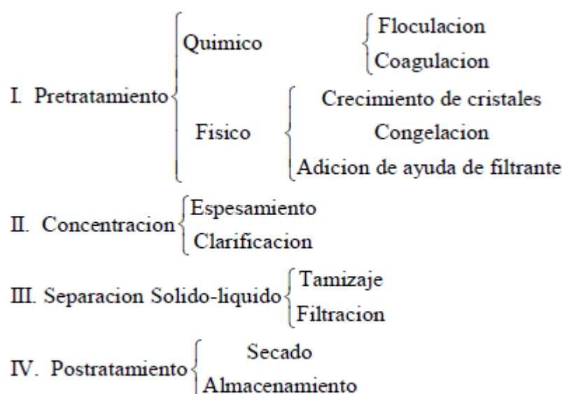
Fig. 2.2 Esquema de los procesos de separación sólido-líquido
