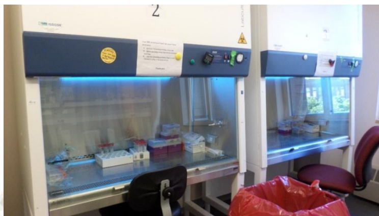
Figura II.3. Cámara de flujo laminar (Esco®, Class II Type A2)
