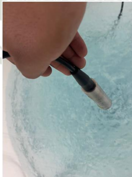
Figura 36. Transmisor de nivel antes de ser colocado dentro del tanque de agua osmonizada.
