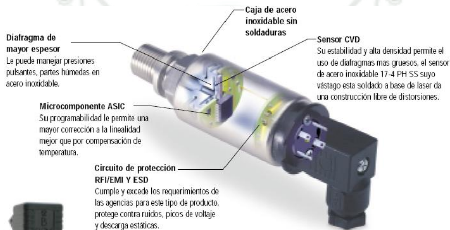
Figura 26. Detalle constructivo del sensor de presión.
