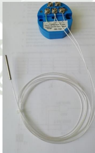
Figura 32. Sensor pt100 de 2 hilos con protección metálica.
