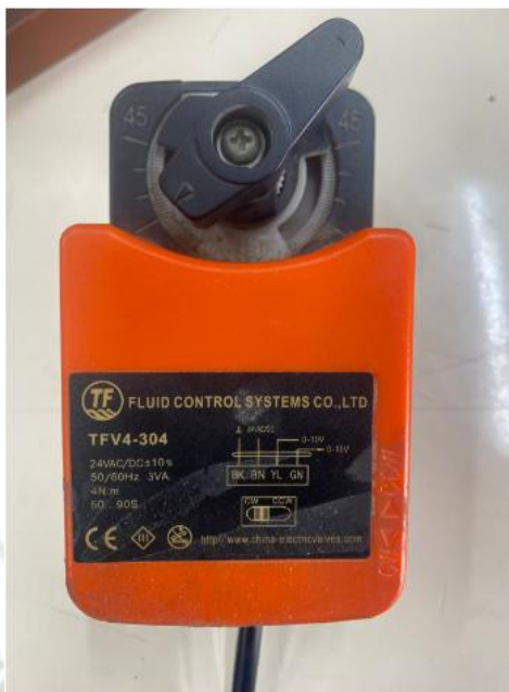
Figura 30. Vista frontal de válvula motorizada.
