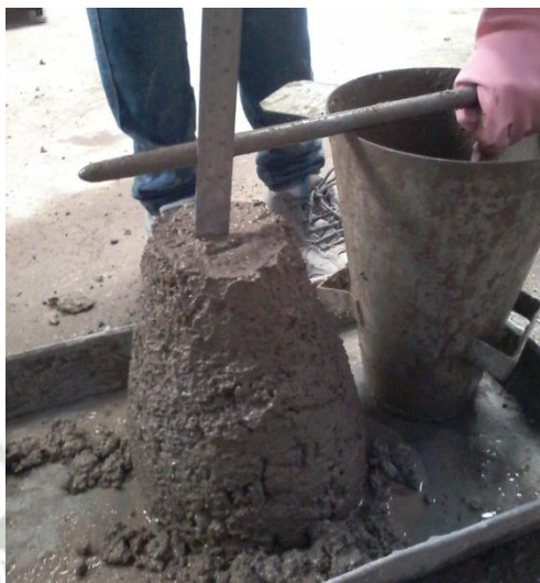
Ilustración 7 - Medición de revenimiento
