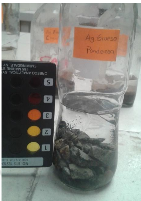
Ilustración 2 - Impurezas orgánicas de agregado grueso - Cantera La Poderosa
