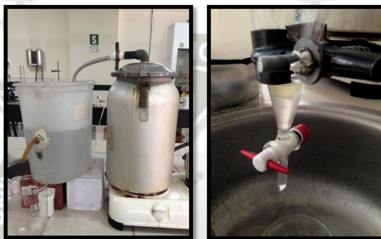
Figura N° 10. Equipo artesanal de destilación por arrastre de vapor
