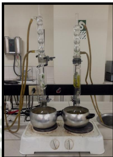
Figura N° 8. Destilación por método de Soxhlet.
