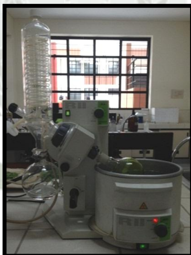
Figura N° 9. Concentración del extracto etéreo en equipo rotavapor.
