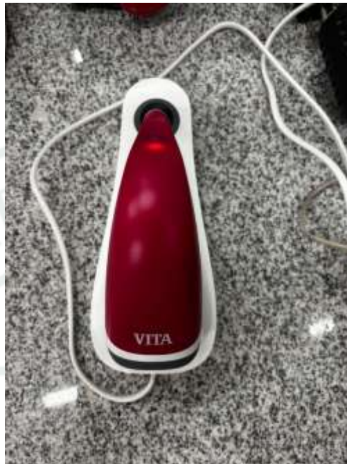
Figura 20 Espectrofotómetro utilizado para la medición del color
