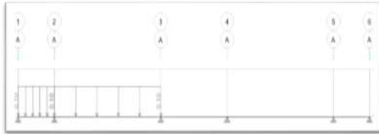
IMAGEN 5. 8.- Carga viva para una vigueta. (CV=100kgf/m)
