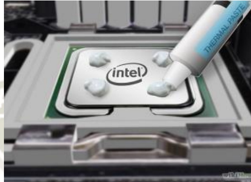
Figura 36. Pasta de Refrigeración Microprocesador Halnziye
