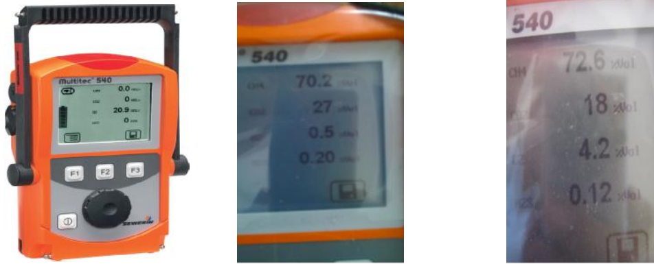
FIGURA N° 08. EQUIPO MULTITEC® 545/540, MARCA SEWERIN, MODELO 20.02.2015 A - 105834 - DE FABRICACIÓN ALEMANA; PARA OBTENER LOS PORCENTAJES DE CH 4 , CO 2 , O 2 Y H 2 S (METANO, BIÓXIDO DE CARBONO, OXIGENO Y SULFURO DE HIDROGENO), NÓTESE MEDIDAS EFECTUADAS DURANTE LA INVESTIGACIÓN EN DIGESTOR HPTC. Fuente: Fotografías Marco Ponce M.
