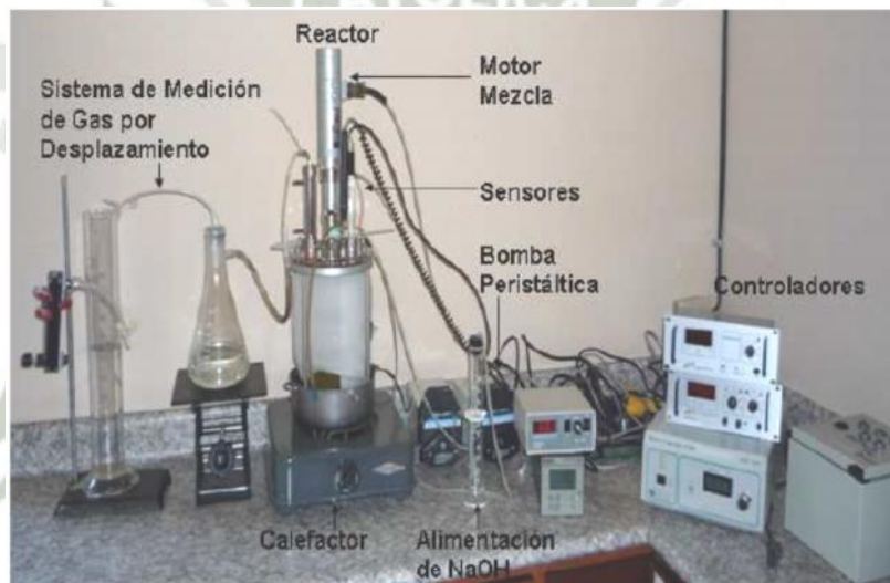
Figura12. Reactor Automático de 3.0 l (Cole-Parmer) Fuente: (Jiménez, D.2012)
