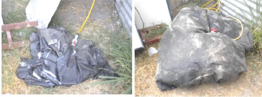
Figura 15. Bolsa de captación de biogás
