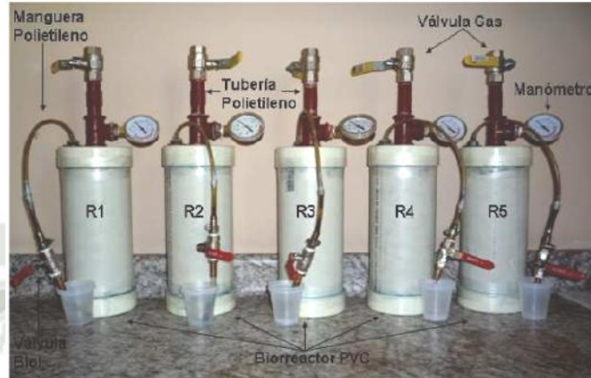
Figura13. Reactores de botellón de 2.6 litros en funcionamiento Fuente: (Jiménez, D.2012)
