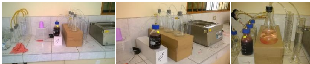
FIGURA N° 04. REACTORES UNA VEZ CONCLUIDAS LAS PRUEBAS TRASLADAN EL BIOGÁS PRODUCIDO POR EL MÉTODO VOLUMÉTRICO A MATRACES KITASATO GRADUADOS CONTENIENDO UNA CANTIDAD DEFINIDA DE AGUA, LA MISMA QUE ES TRASLADADA A SU VEZ A PROBETAS GRADUADAS PARA SU LECTURA. Fuente: Fotografías Marco Ponce M.
