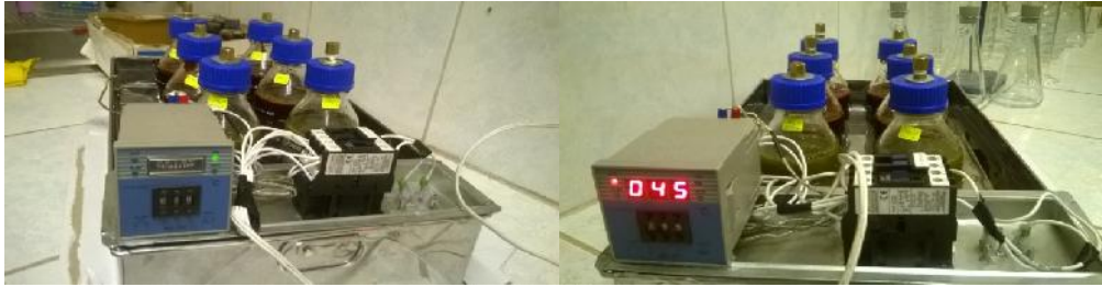
FIGURA N° 03. IMAGENES SUPERIOR IZQUIERDA COSUSTRATOS DILUIDOS Y HOMOGENIZADOS, CON SU REPLICA, ENVASADOS EN REACTORES DE 500 ML. SUPERIOR DERECHA EN TERMOSTATO O BAÑO MARÍA A 50°C. ABAJO IZQUIERDA EN TERMOSTATO A 39°C Y DEBAJO DERECHA EN TERMOSTATO A 45°C.
