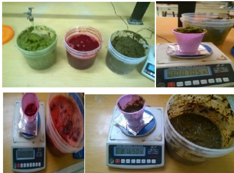
FIGURA N° 02. IMAGENES SUPERIOR IZQUIERDA LOS SUSTRATOS INGESTA O CONTENIDO RUMINAL, SANGRE Y ESTIÉRCOL DE VACUNO. EN SUPERIOR DERECHA PESANDO INGESTA EN BALANZA DE PRECISIÓN. DEBAJO IZQUIERDA PESADO DE LA SANGRE Y A LA DERECHA PESADO DEL ESTIÉRCOL, PARA LAS PRUEBAS EN BACHT. Fuente: Fotografías Marco Ponce M.
