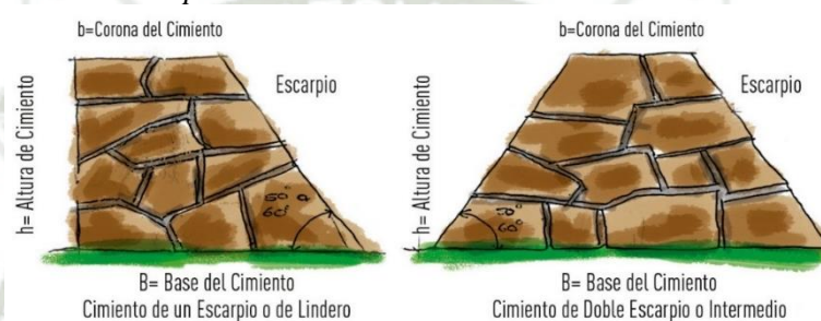
Figura 99 Cimientos de piedra
