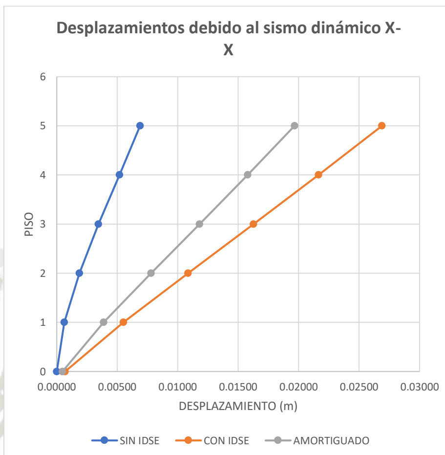
Figura 66. Desplazamientos debido al SD-X Suelo S3-2
