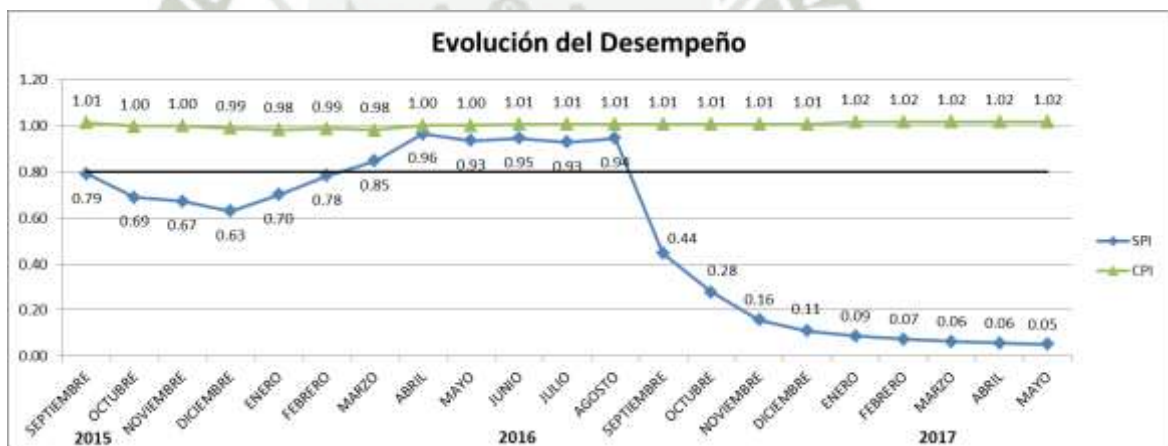
Figura 24. Evolución de los indicadores de la Gestión del Valor Ganado al mes de mayo 2017 Elaboración propia
