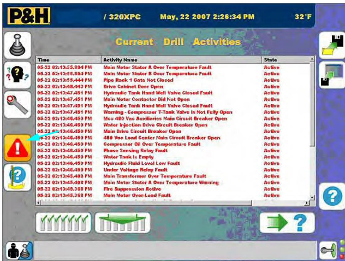
Figura 3-43: Pantalla de Actividades Actuales de la Perforadora
