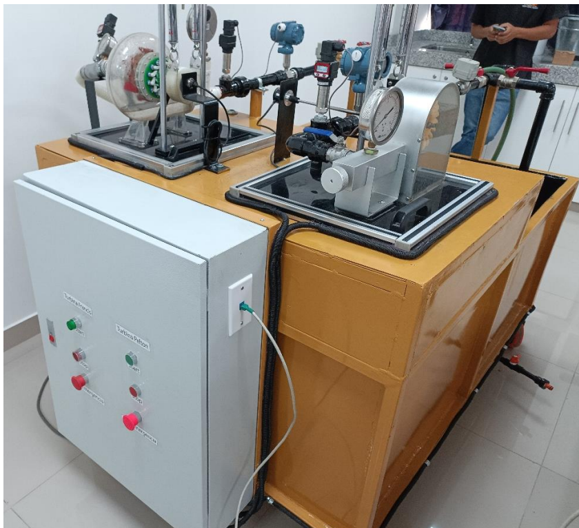
Figura 3.84 Transmisor de presión instalado en el módulo
