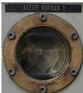
Fig.6 Visor de flujo de aceite rodillo Máster N°1.
