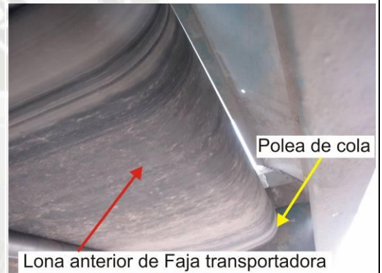
Fig. 4 Revisión lona de faja lado posterior en polea de cola
