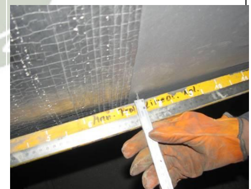
Alineación de la plantilla al rodillo 10mm en la zona de no contacto del rodillo.
