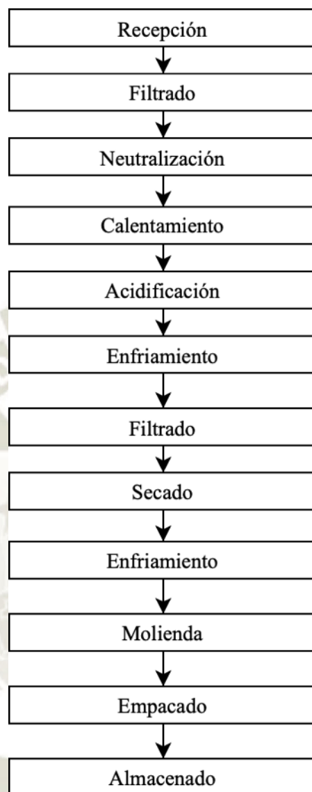
Figura 1. Diagrama de bloques: obtención del concentrado de proteína de suero lácteo
