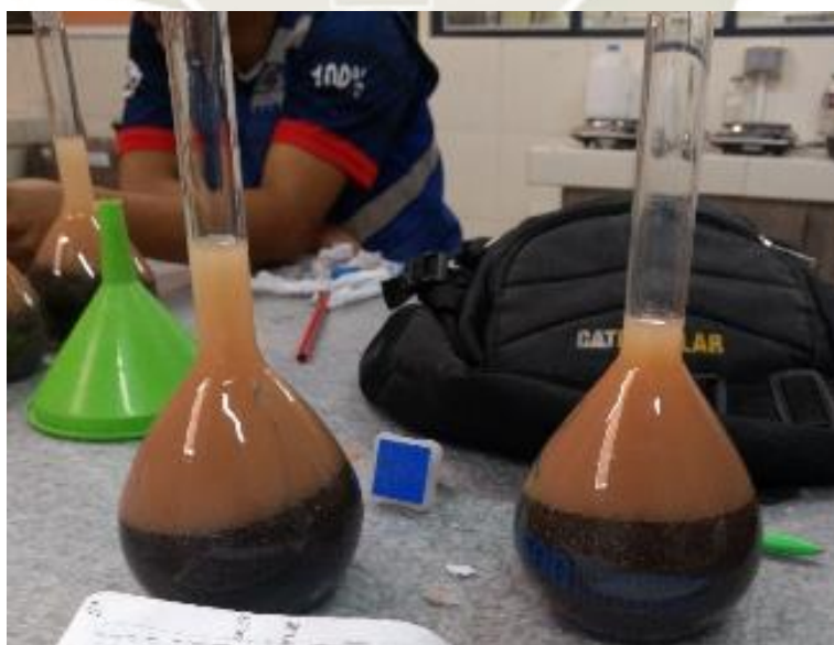
Figura 83: Gravedad específica y absorción de agregados finos Socabaya Fuente: Elaboración propia
