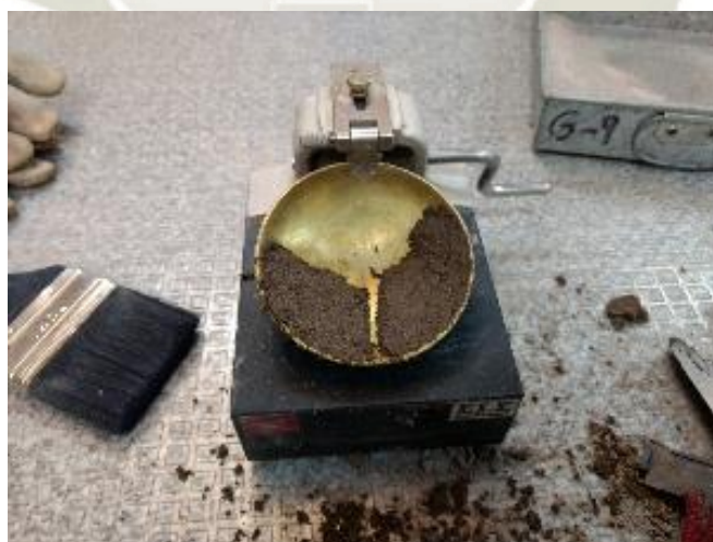
Figura 36: Limite liquido material sub base Fuente: Elaboración propia
