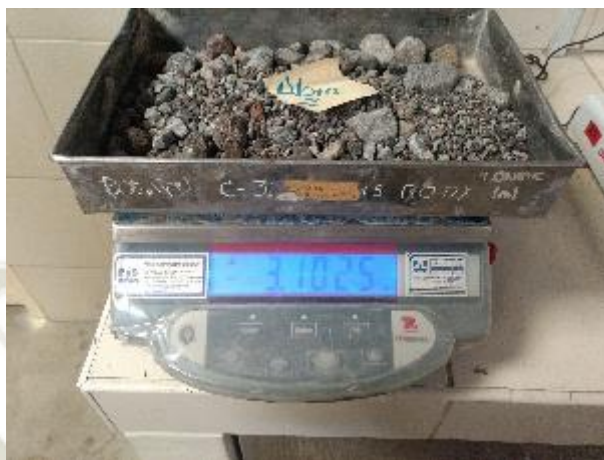
Figura 35: Material Sub base después de retirado de Maquina Los Ángeles Fuente: Elaboración propia
