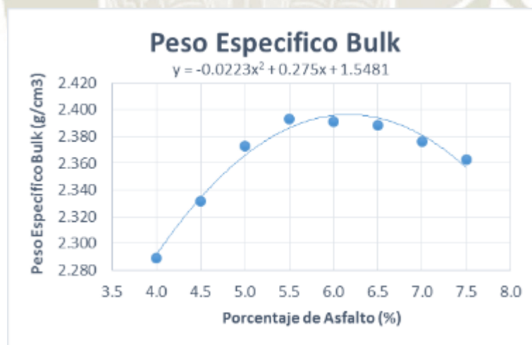
Gráfica 33: Peso específico bulk vs % asfalto para MAC normal absorción y asfalto con polímero
