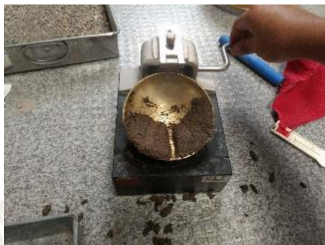
Figura 75: Limite liquido Agregado fino La Poderosa Fuente: Elaboración propia
