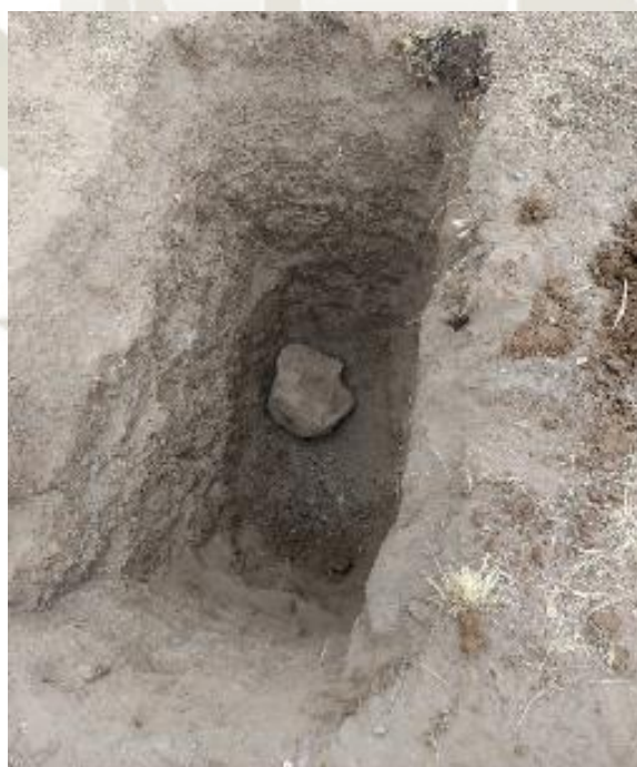
Figura 24: Bolonería en la profundidad de calicata 2 Fuente: Elaboración propia
