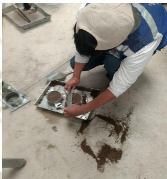
Figura 33: Ensayo de Proctor modificado en laboratorio UCSM
