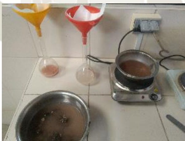
Figura 43: Duración al sulfato de magnesio material Base Fuente: Elaboración propia
