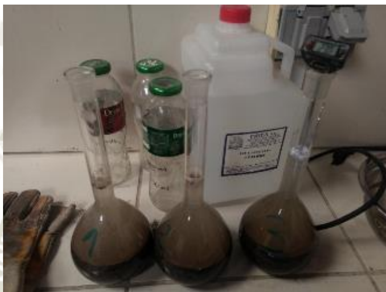
Figura 82: Gravedad específica y absorción de agregados finos La Poderosa Fuente: Elaboración propia
