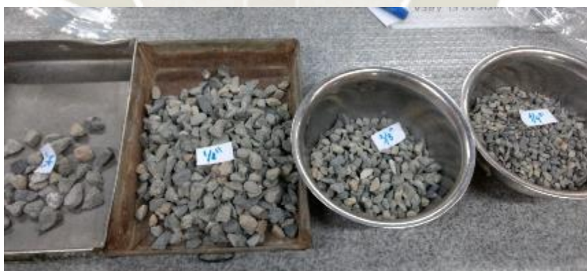
Figura 52: Análisis granulométrico de agregado grueso Socabaya Fuente: Elaboración propia
