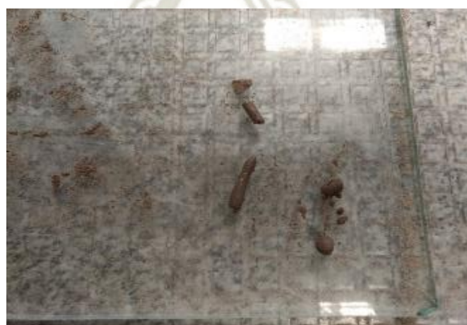
Figura 77: Limite plástico de agregados Fuente: Elaboración propia
