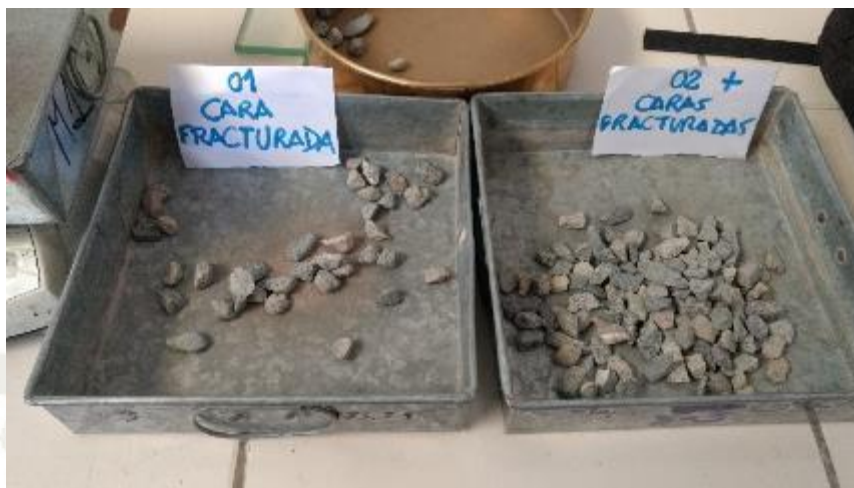
Figura 61: Caras fracturadas de agregados La Poderosa Fuente: Elaboración propia
