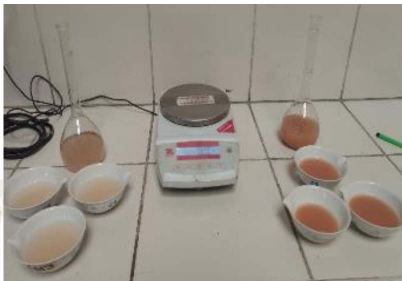
Figura 80: Alícuotas de agregado fino Socabaya Fuente: Elaboración propia
