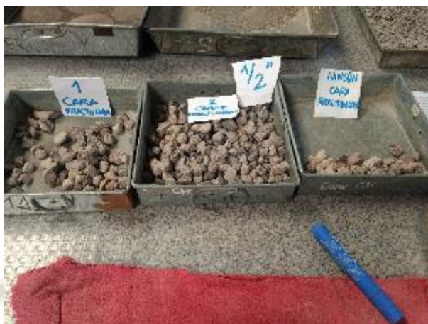
Figura 41: Caras fracturadas Agregado Grueso material Base Fuente: Elaboración propia
