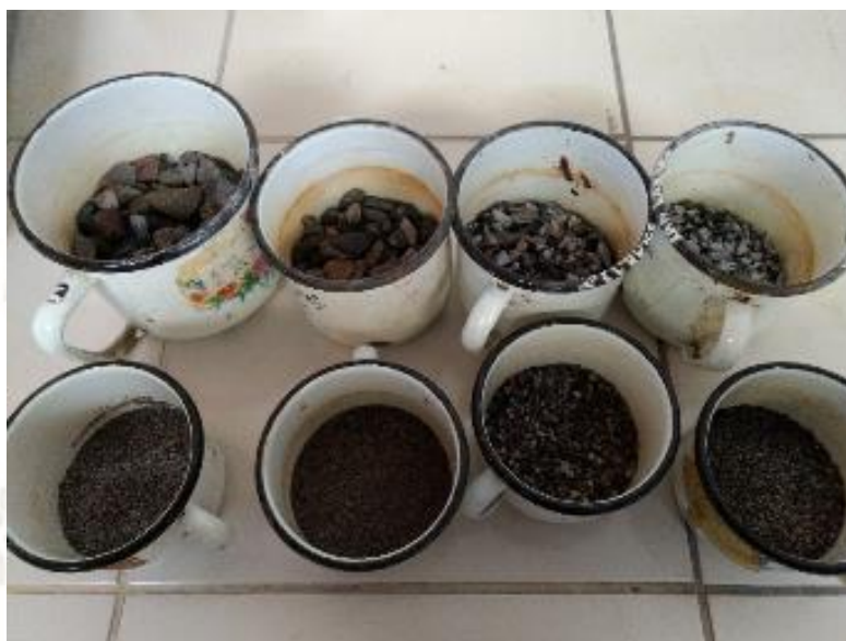
Figura 78: Durabilidad al Sulfato de magnesio de agregados pétreos Fuente: Elaboración propia
