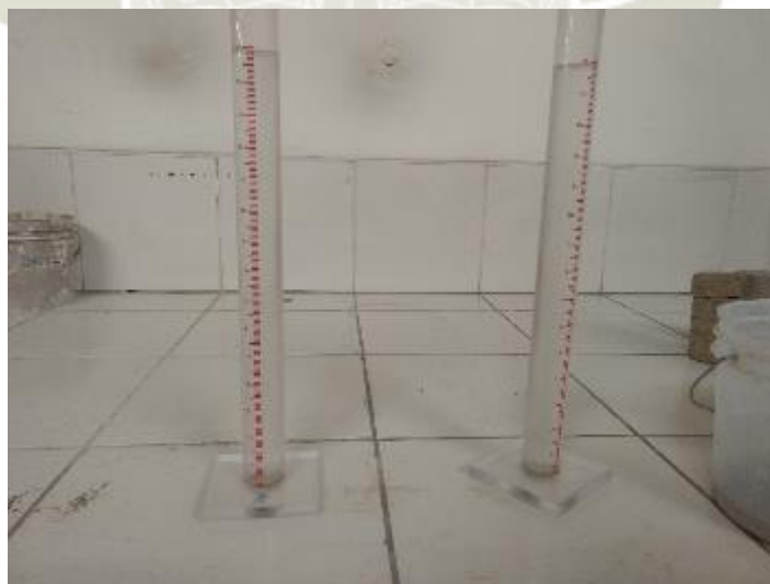
Figura 58: Ensayo de Índice de Durabilidad en laboratorio UCSM Fuente: Elaboración propia
