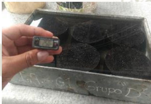
Figura 14: Especímenes sumergidos a 25^{\circ}\text{C} Fuente: Elaboración propia
