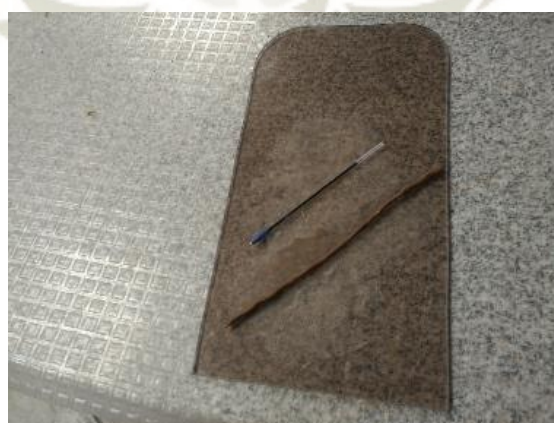
Figura 29: Limite plástico de material extraído.
