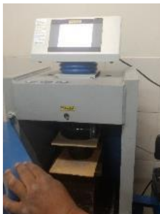
Figura 15: Compresión de briqueta en maquina Fuente: Elaboración propia
