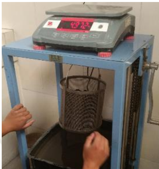
Figura 65: Material sumergido para cálculo de peso específico Fuente: Elaboración propia
