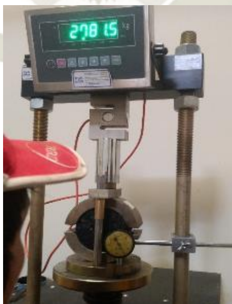
Figura 10: Toma de datos en la maquina Marshall Fuente: Elaboración propia
