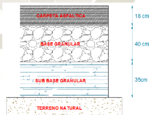
Figura 45: Espesores de pavimento flexible calculado
