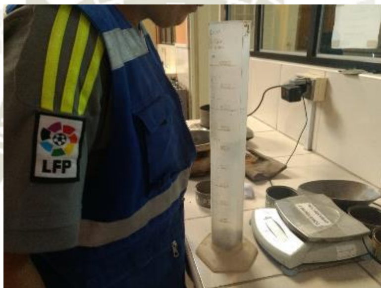
Figura 32: Peso unitario en laboratorio UCSM
