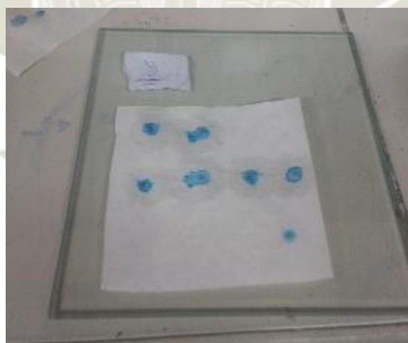
Figura 74: Azul de metileno agregado fino Socabaya Fuente: Elaboración propia
