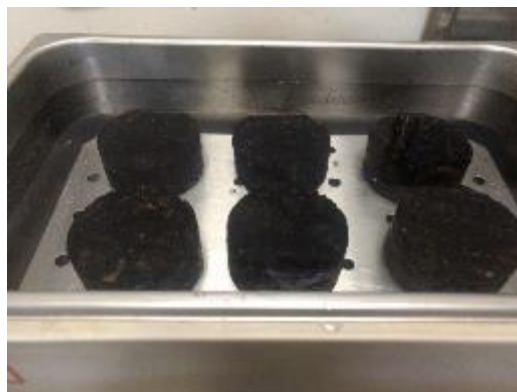
Figura 9: Briquetas sumergidas en baño María a 60°C Fuente: Elaboración propia
