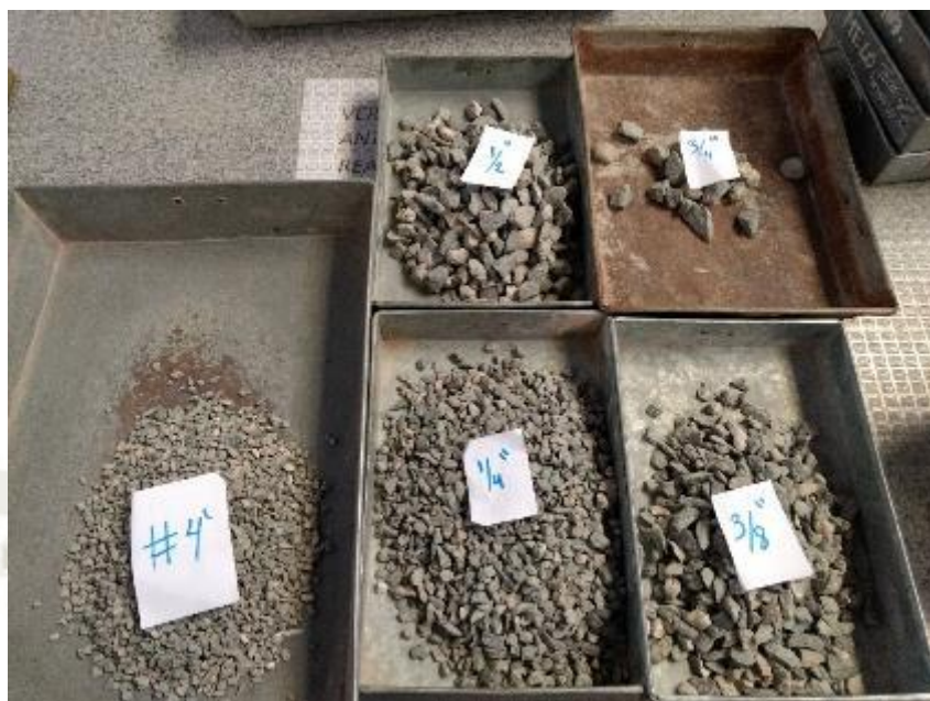
Figura 51: Análisis granulométrico de material grueso La Poderosa Fuente: Elaboración propia
