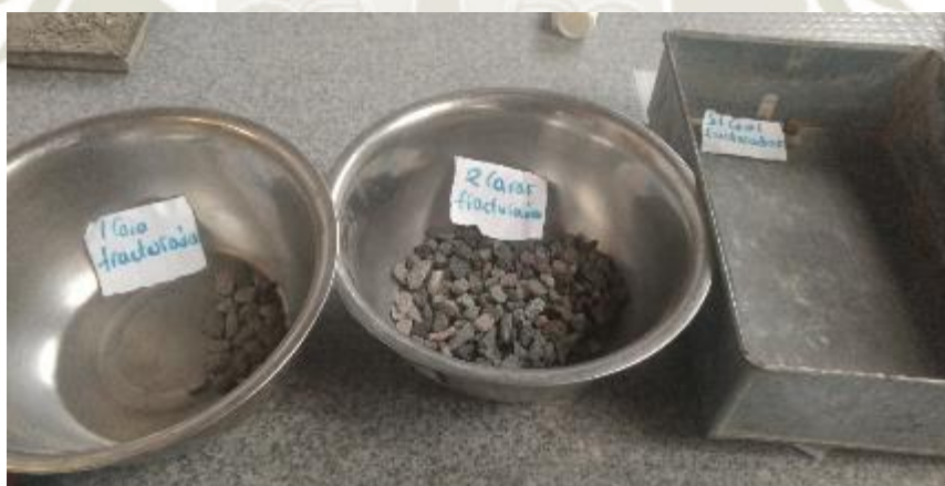
Figura 62: Caras fracturadas agregados Socabaya Fuente: Elaboración propia
