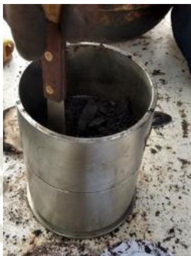
Figura 5: Chuseado de material asfáltico en molde Fuente: Elaboración propia
