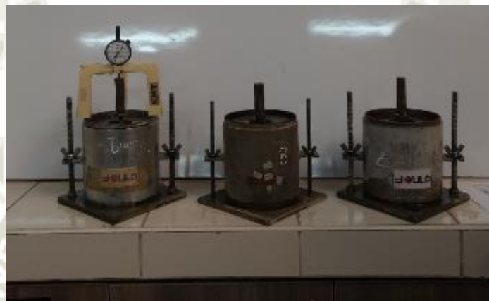
Figura 34: Ensayo de CBR en laboratorio de UCSM
