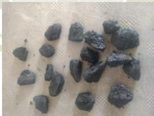
Figura 56: Adherencia de agregado pétreo Fuente: Elaboración propia
