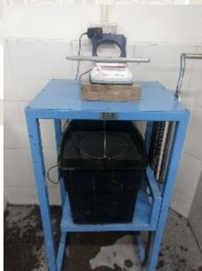
Figura 8: Especímenes saturados para el cálculo de peso específico bulk Fuente: Elaboración propia
