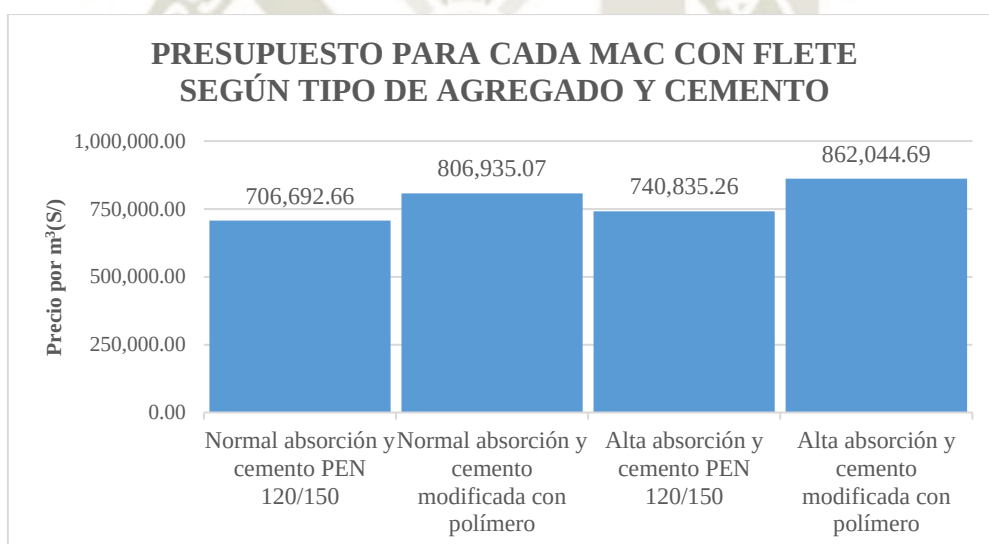
Gráfica 63: Presupuesto total vs MAC según tipo de agregado y cemento asfáltico Fuente: Elaboración propia
