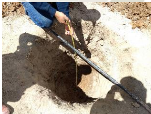
Figura 22: Medición de estratos y profundidad de calicata 1 Fuente: Elaboración propia
