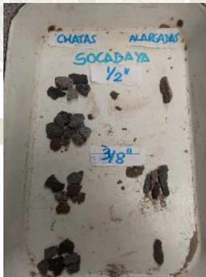
Figura 60: Partículas chatas y alargadas de agregados Socabaya Fuente: Elaboración propia
