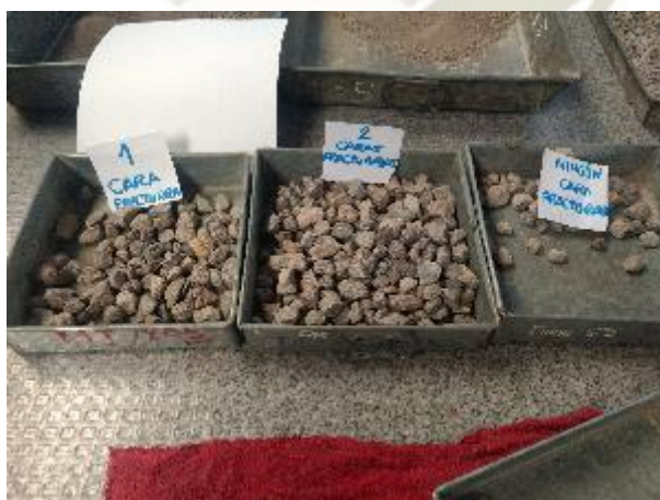
Figura 42: Dos caras fracturadas para material Base Fuente: Elaboración propia
