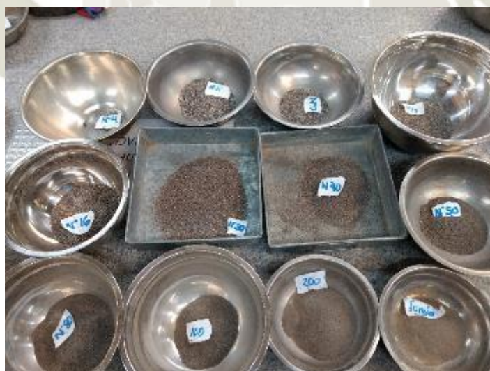
Figura 68: Granulometría agregado fino La socabaya Fuente: Elaboración propia
