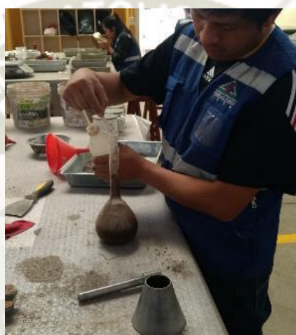
Figura 30: Gravedad específica de los suelos en picnómetro Fuente: Elaboración propia
