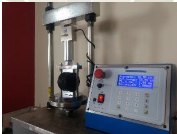
Figura 12: Compresión en maquina Marshall con cabezal Lottman Fuente: Elaboración propia
