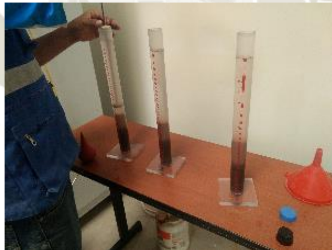
Figura 37: Equivalente de Arena material Sub base Fuente: Elaboración propia
