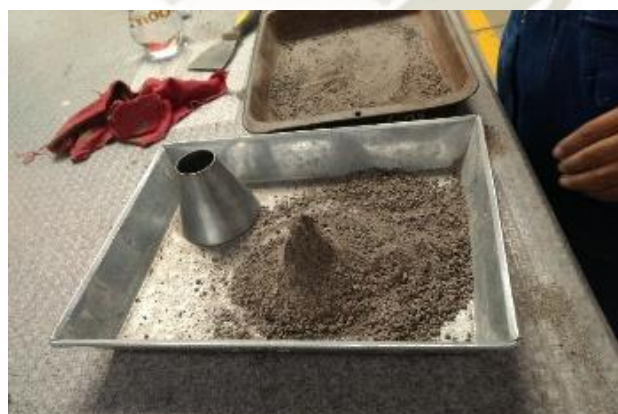
Figura 31: Estado de muestra para ensayar Gravedad específica Fuente: Elaboración propia
