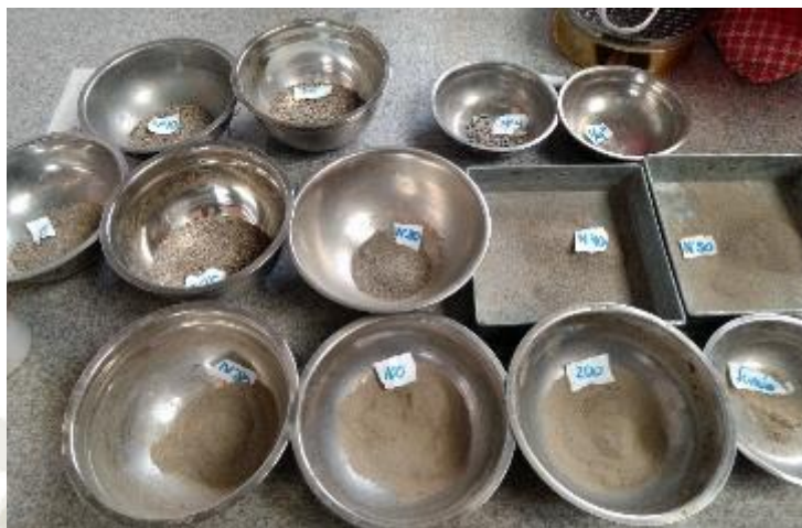
Figura 69: Granulometría agregado fino Socabaya Fuente: Elaboración propia
