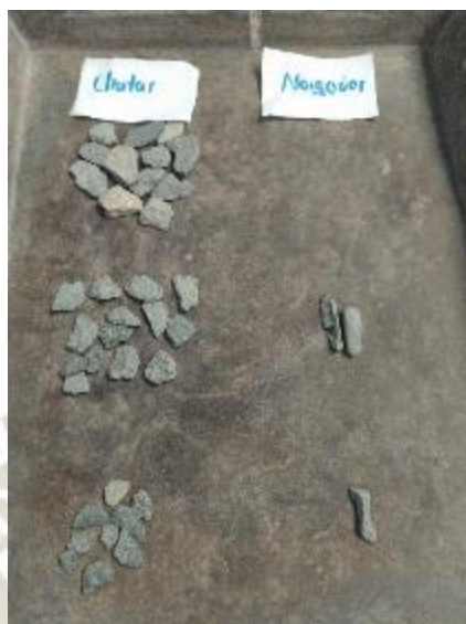
Figura 59: Partículas chatas y alargadas de agregados La Poderosa Fuente: Elaboración propia
