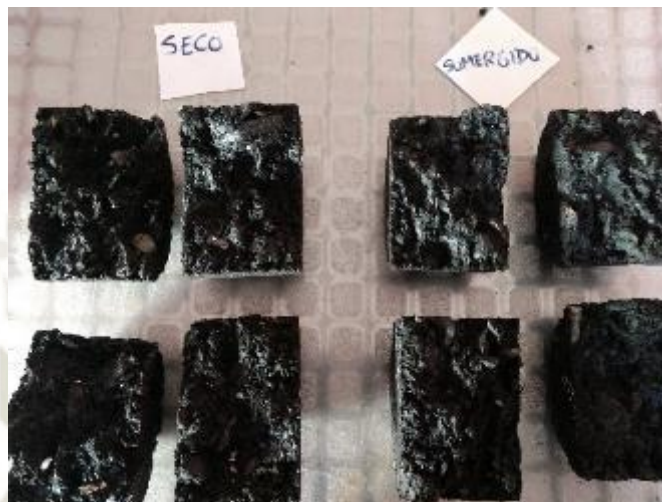
Figura 13: Daño 5 de briquetas después de ser sometidas a esfuerzo
