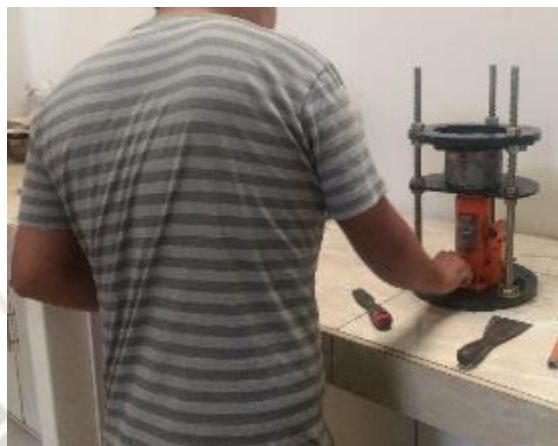
Figura 7: Retiro de molde cilíndrico del espécimen Fuente: Elaboración propia
