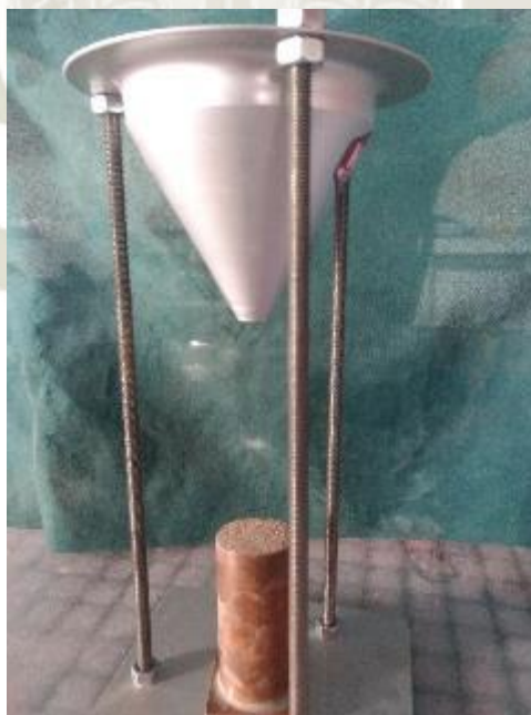
Figura 72: Angularidad de agregado fino Fuente: Elaboración propia
