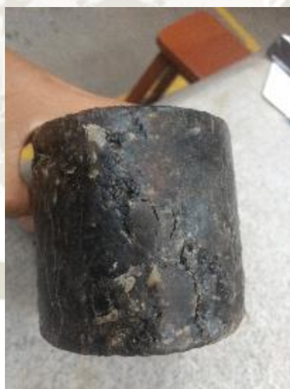
Figura 16: Espécimen después de Comprimido Fuente: Elaboración propia
