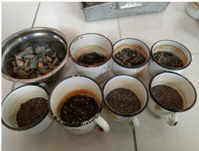
Figura 53: Durabilidad al sulfato de magnesio pétreo normal absorción Fuente: Elaboración propia
