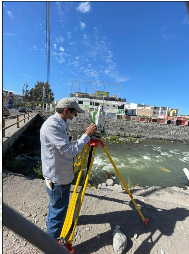
Figura 3.2 Levantamiento topográfico del puente San Martín
