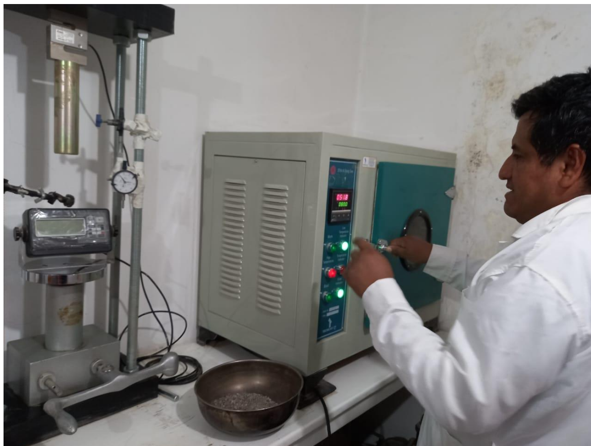
Figura 7.9 Secado de muestras para los ensayos de granulometría, peso específico y contenido de humedad
