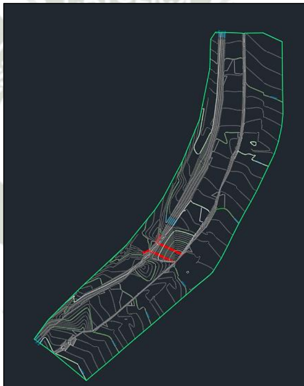
Figura 5.5 Superficie obtenida a partir de las curvas de nivel
