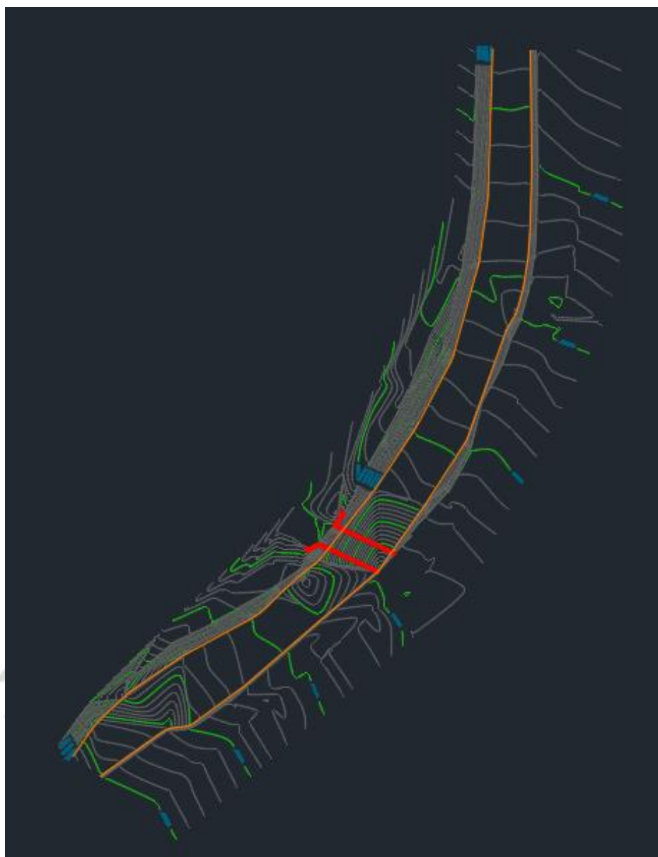
Figura 5.4 Topografía del cauce del río Chili y el puente San Martín
