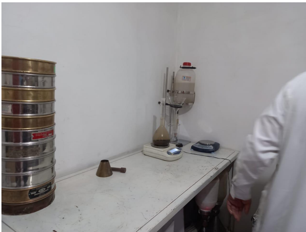
Figura 7.8 Ensayo de peso específico – Peso de probeta con agua más suelo
