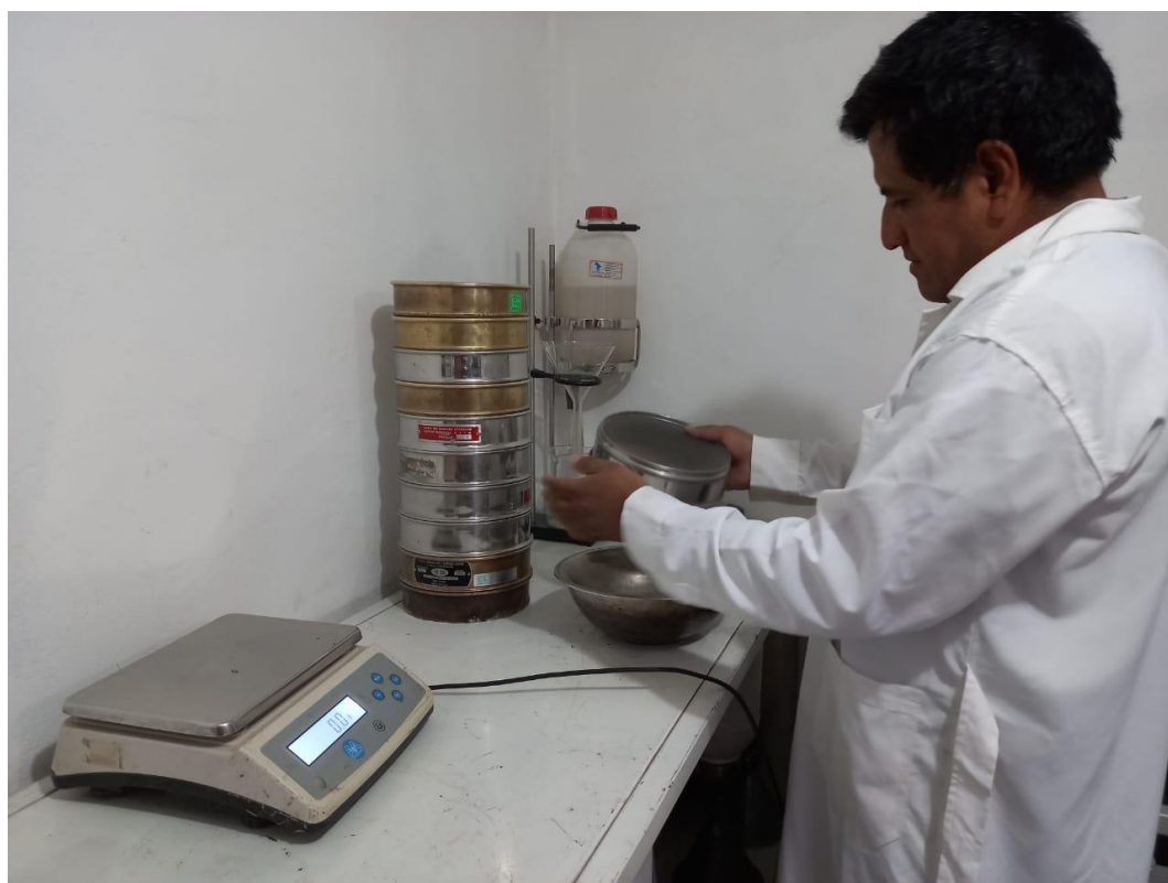
Figura 7.7 Ensayo de granulometría. - Tamizado manual.
