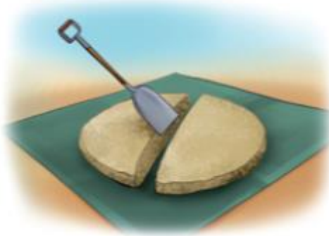
c) El cuarteo después de aplastar el cono
