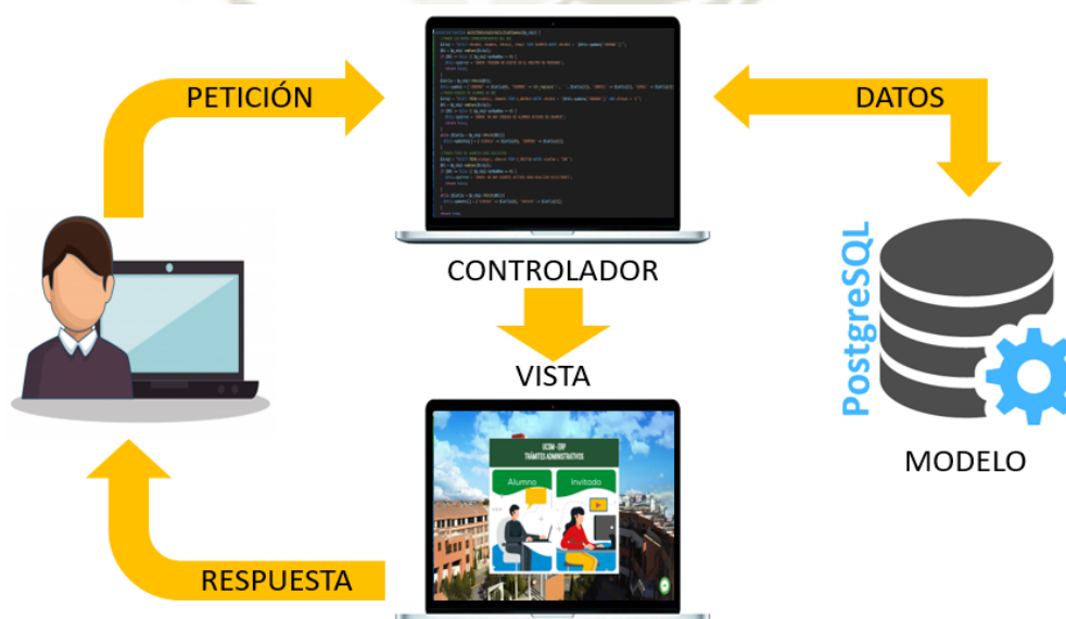
Ilustración 2: Arquitectura de Modelo Vista Controlador
