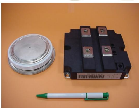
Figura 2-37: Diodo tipo press-pack de 4.5kV/0.8kA y diodos modulares de 1.7kV/1.2kA [27].
