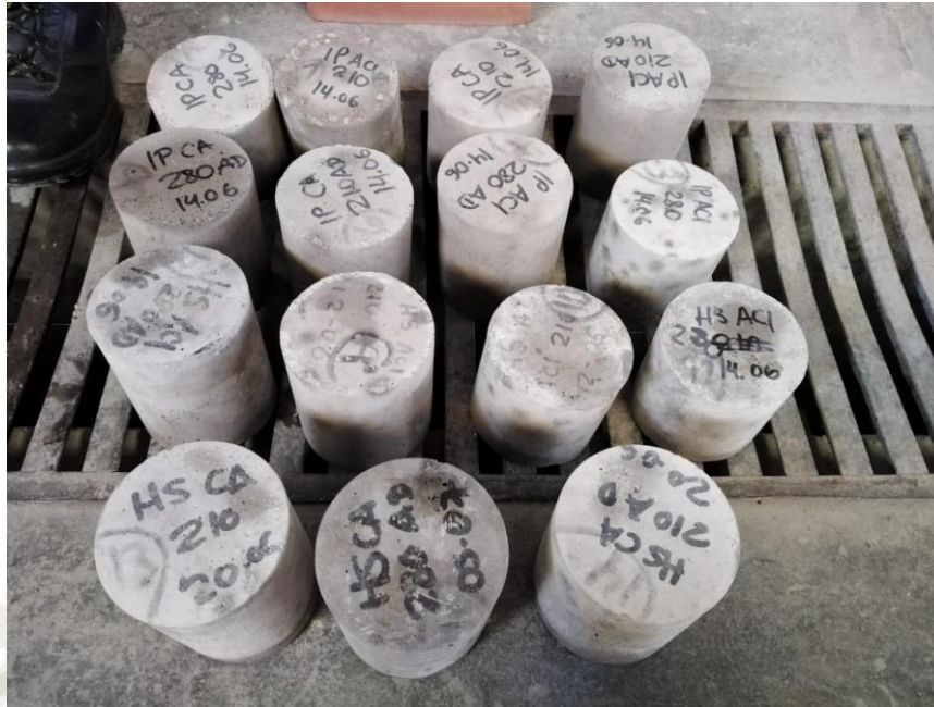
Fotografía 13 Muestras secando después de 28 días de sumergidos en solución de sulfato.
