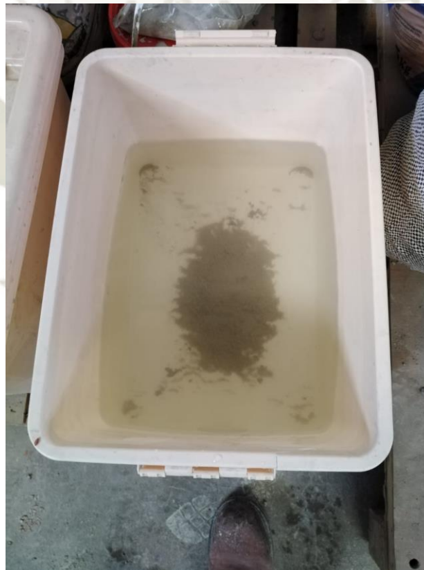
Fotografía 14 Restos de motero desprendidos por el ataque de sulfatos.
