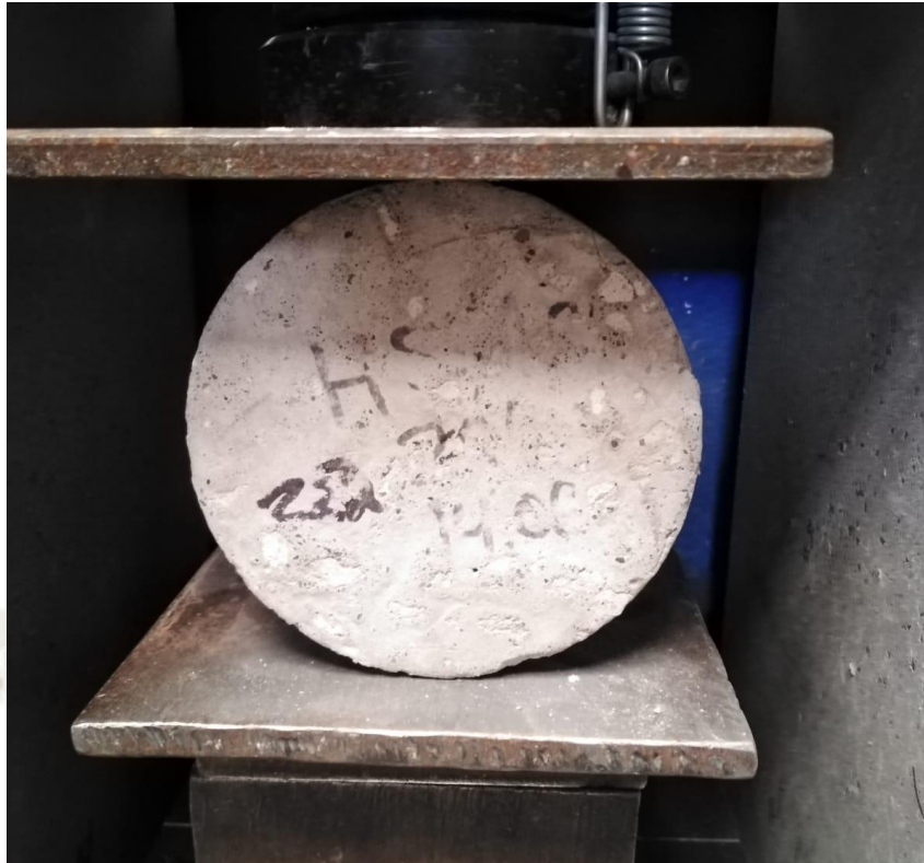
Fotografía 19 Ensayo de corte brasilero.
