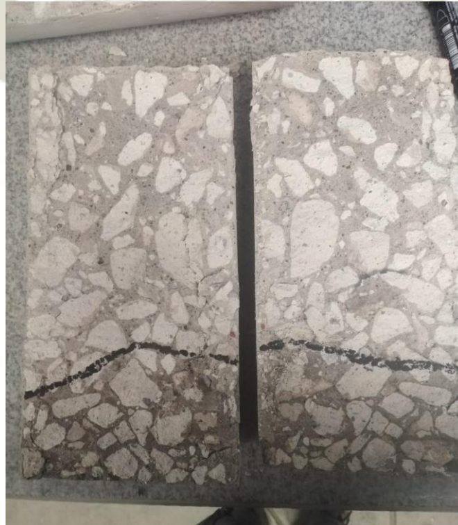
Fotografía 20 Profundidad de penetración del concreto.
