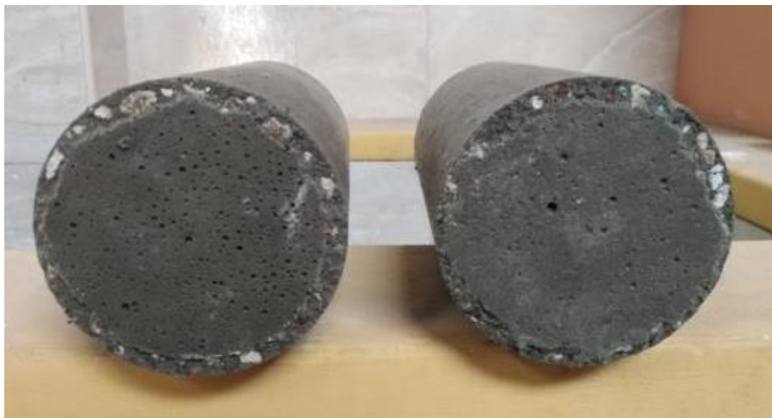
Fotografía 7 Diferencia de concreto endurecido con aditivo plastificante.
