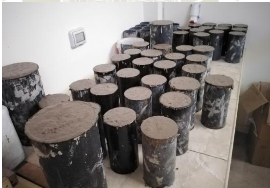
Fotografía 6 Fraguado del concreto en moldes.
