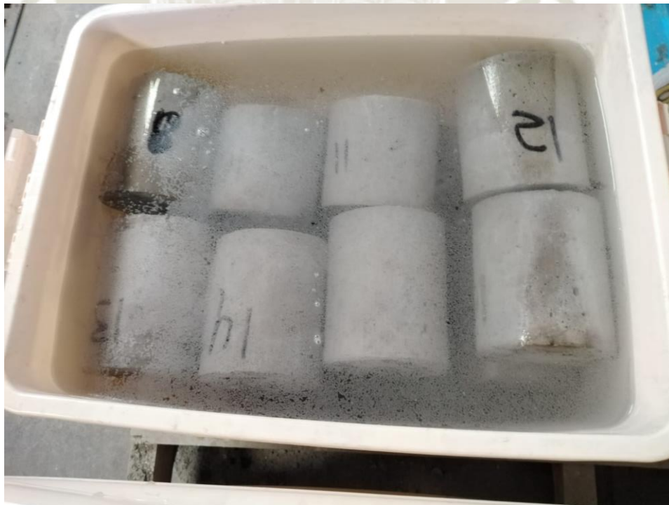
Fotografía 12 Muestras de concreto sumergido en solución de sulfatos.
