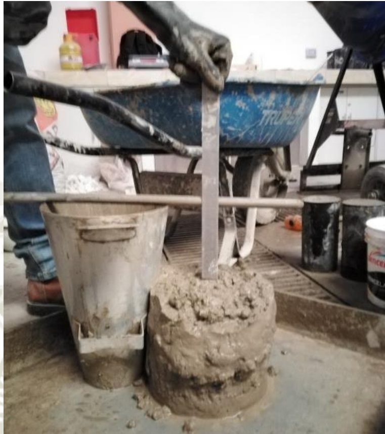
Fotografía 5 Asentamiento (slump) del concreto.
