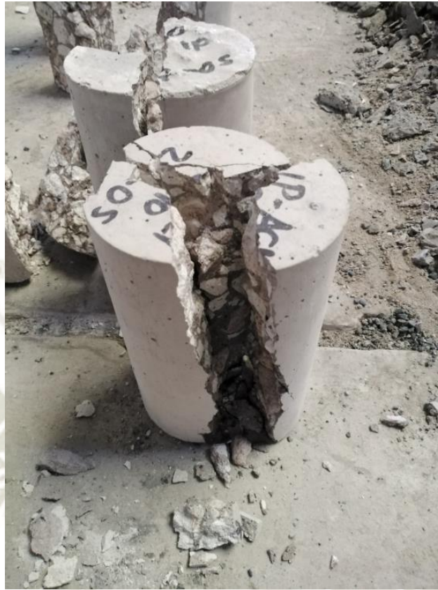
Fotografía 11 Probeta ensayada de concreto con roca ignimbrita.
