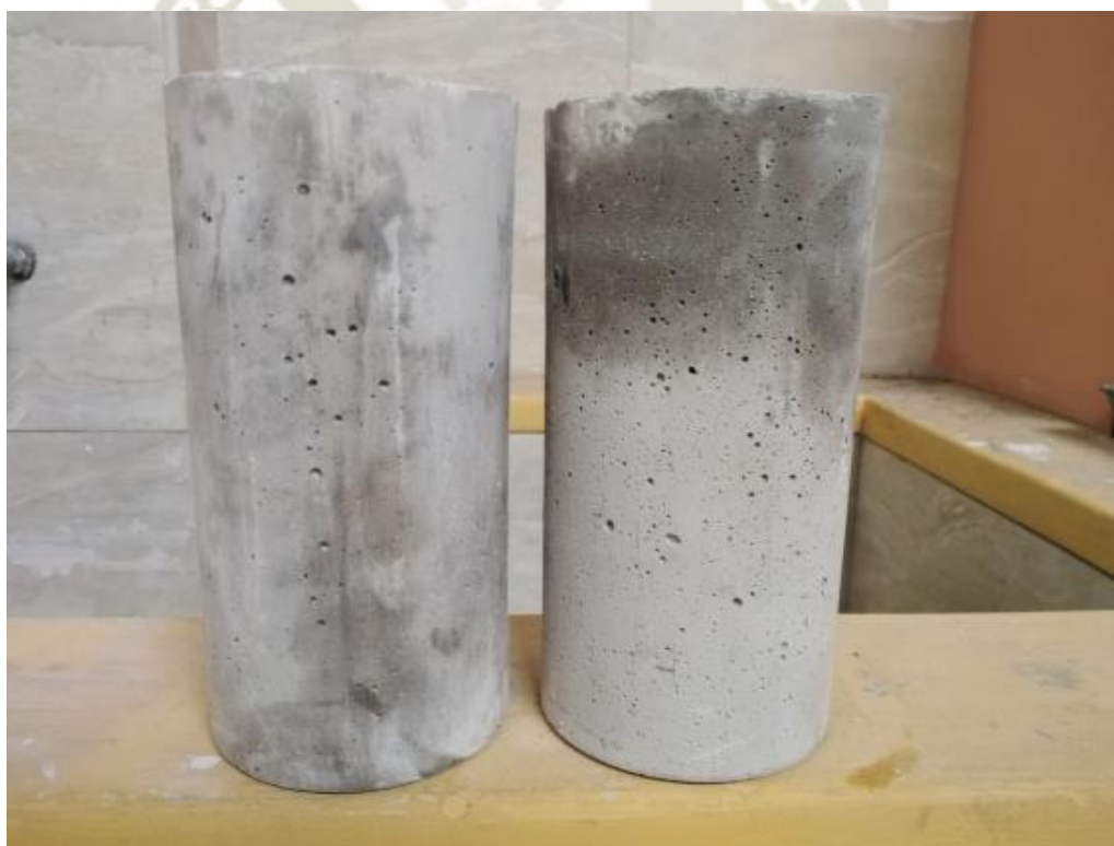
Fotografía 8 Acabado superficial de concreto con y sin incorporación de aditivo plastificante.
