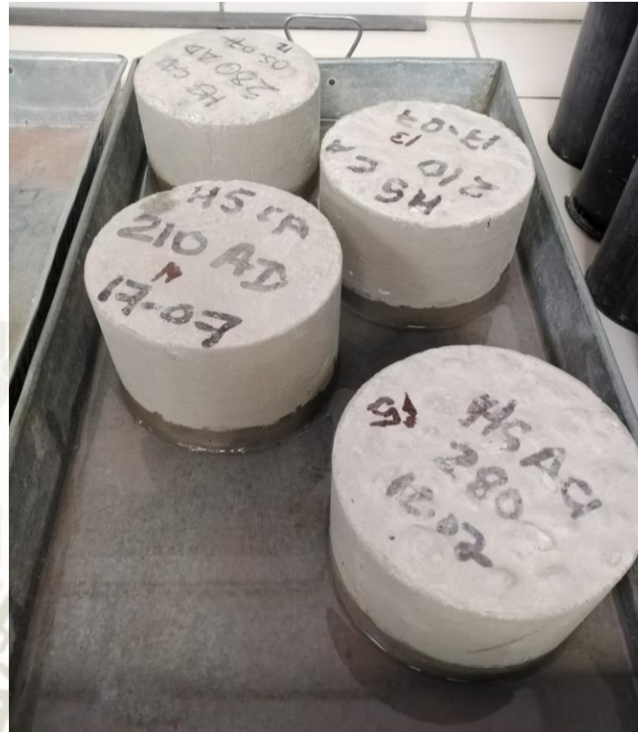
Fotografía 17 Ensayo de capilaridad del concreto.
