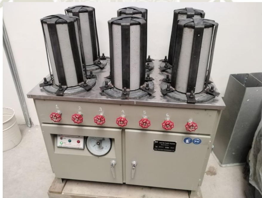
Fotografía 18 Ensayo de permeabilidad del concreto a presión constante de 1 MPa.
